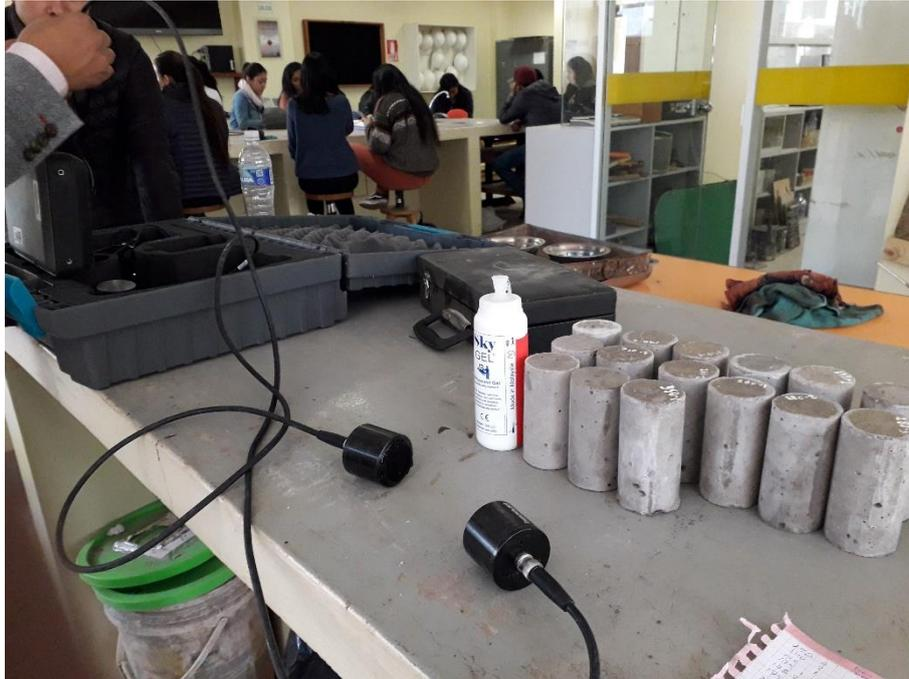
*Imagen 16* Ensayo a compresión simple de muestras cilíndricas de 2"x4"
