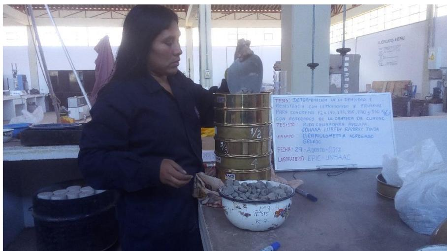
*Imagen 7 Peso específico del agregado grueso*
