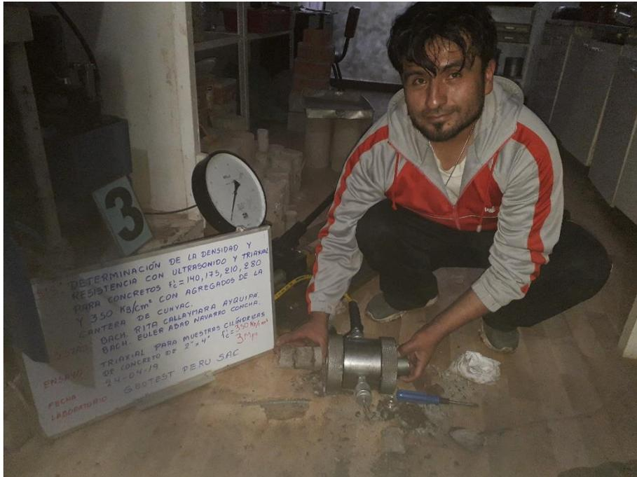
*Imagen 18 Ensayo triaxial*
