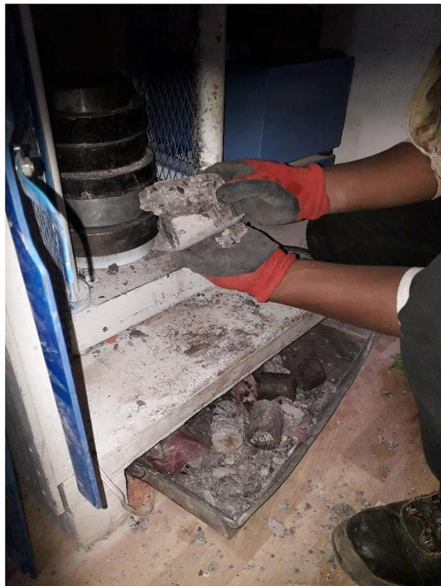
*Imagen 17 Ensayo triaxial a muestras cilíndricas de 2"x4"*
