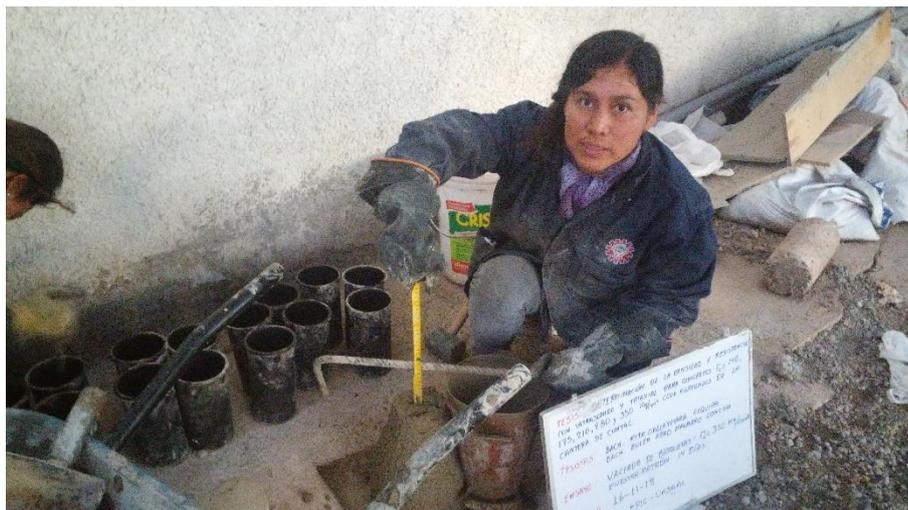
***Imagen 11 Curado de los muestras cilíndricas de 4"x8"***
