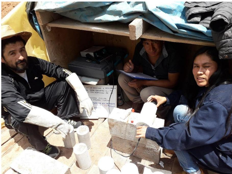
***Imagen 13 Transporte de muestras cilíndricasa al laboratorio para su rotura***
