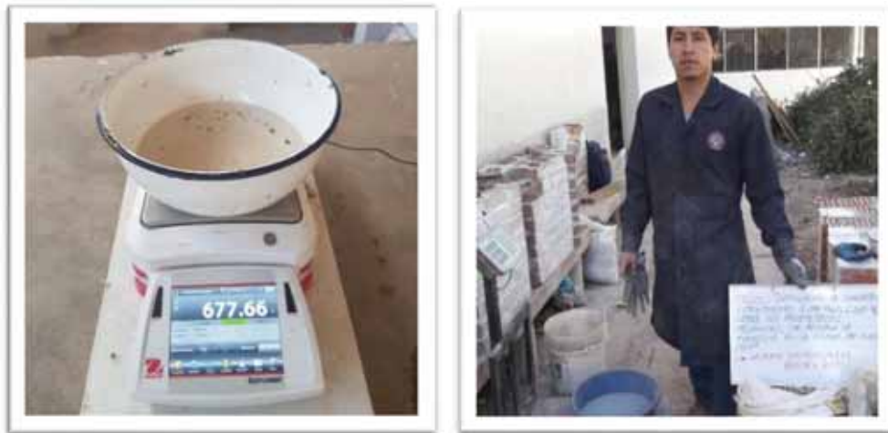
Figura 7. (a).- Balanza con capacidad de 10kg y precisión 0.001 kg, (b).- Balanza con capacidad de 50kg y precisión 0.005 kg. Ambas balanzas, propiedad del laboratorio de la EPIC-UNSAAC.
