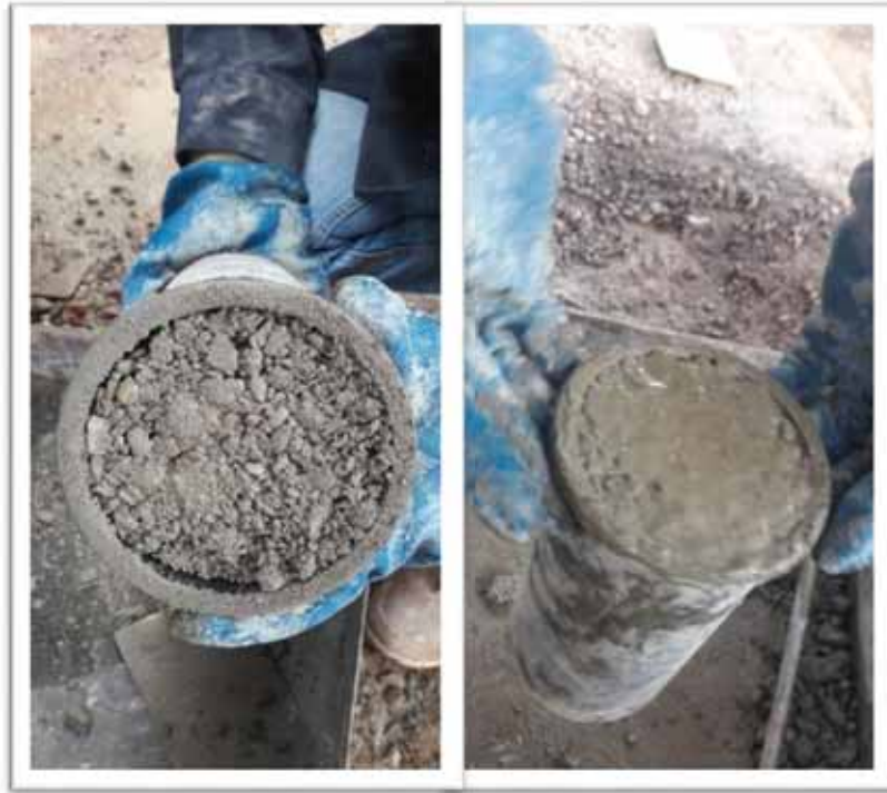
Figura 21. (a).- Poca trabajabilidad, déficit de finos, (b).- Ascensión rápida de la pasta, buena presencia de finos.
