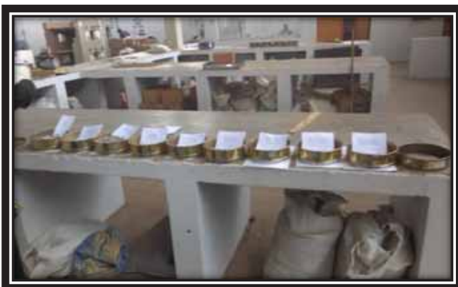
Ensayo, Análisis granulométrico del agregado grueso, realizado en el laboratorio de la escuela profesional de Ingeniería Civil de la Unsaac.
