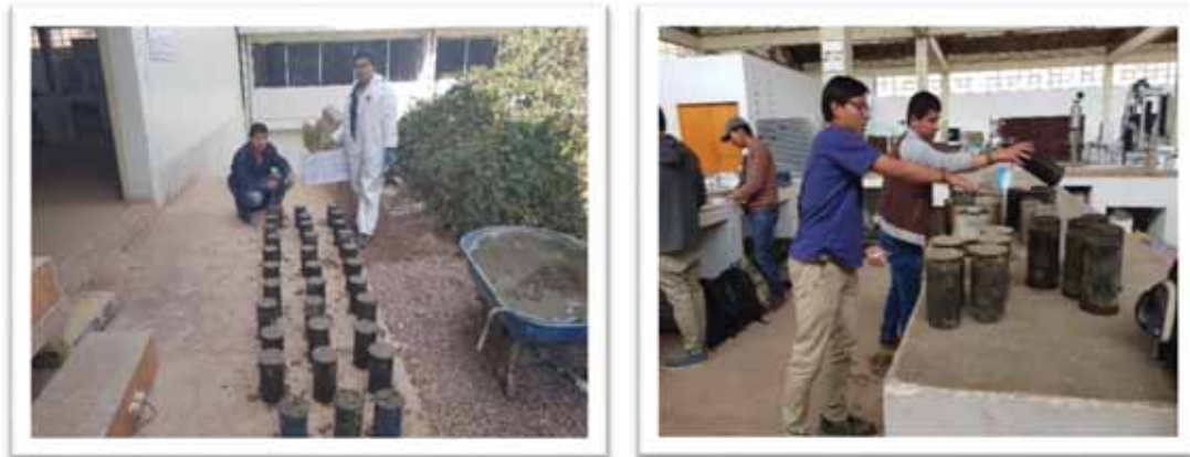
Figura 17. (a).- Fabricación de testigos de concreto en la EPIC, (b).- Desencofrado de testigos de concreto en el laboratorio de la EPIC.
