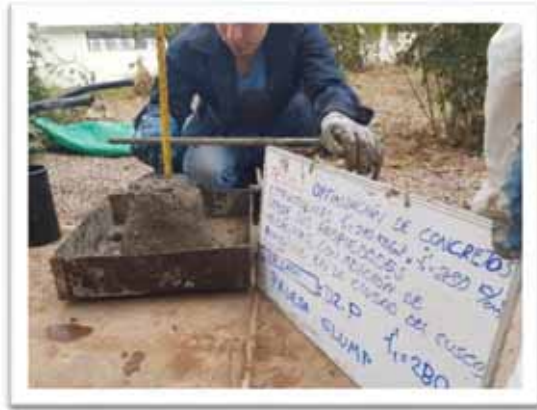
Figura 9. Equipo cono de Abrams, ensayo de revenimiento de concreto.
