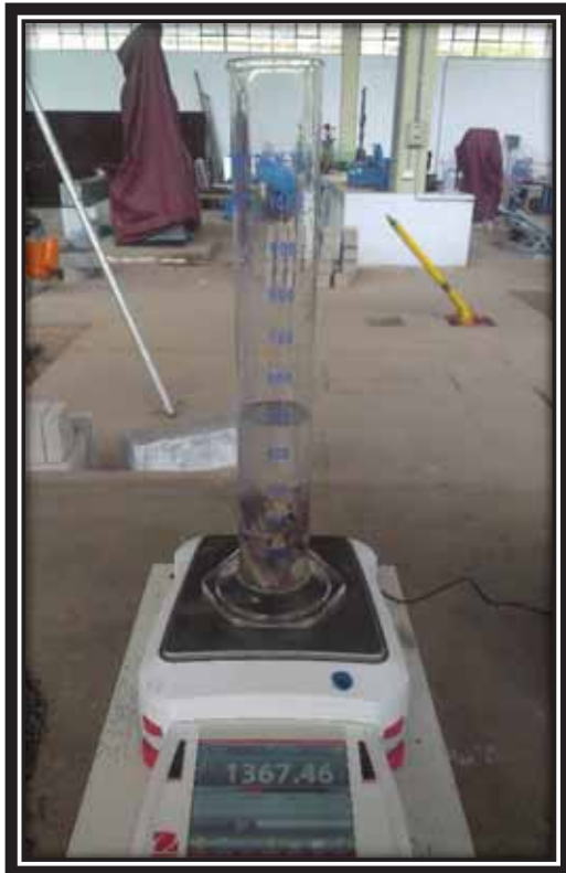
Ensayo, Peso específico del agregado grueso de Huambutio y peso después de secado al horno, realizado en el laboratorio de la escuela profesional de Ingeniería Civil de la Unsaac.
