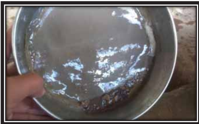
Ensayo, cantidad de fino que pasa el tamiz N° 200 de la arena gruesa de Huambutio, realizado en el laboratorio de la escuela profesional de Ingeniería Civil de la Unsaac.
