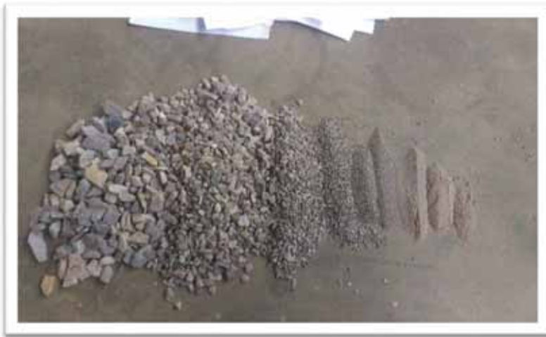
Figura 28. Material retenido del agregado grueso.
