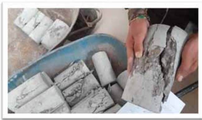
Figura 25. Recolección y observación del tipo de falla de los testigos.
