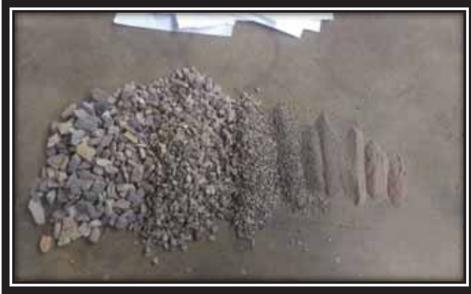
Vista del agregado grueso de Huambutio, después de realizado el ensayo de granulometría en el laboratorio de la escuela profesional de Ingeniería Civil de la Unsaac.
