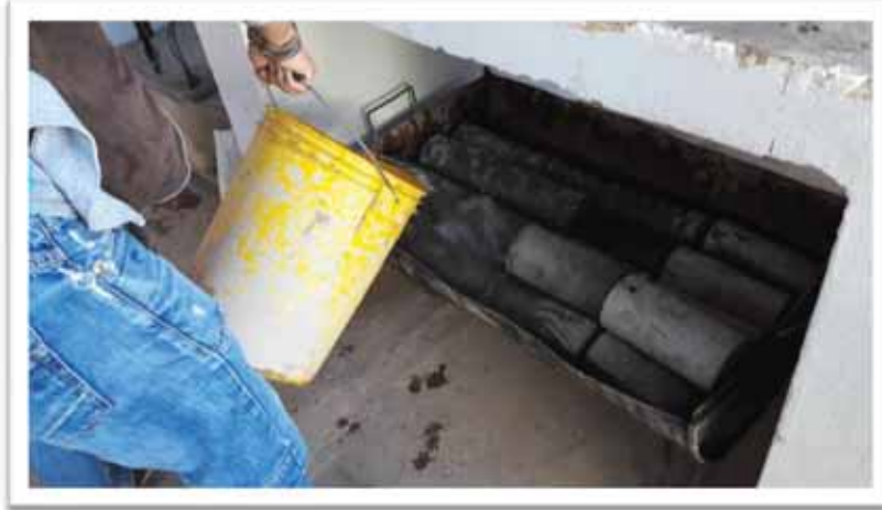
Figura 18. Curado de los testigos de concreto, en el laboratorio de la EPIC.
