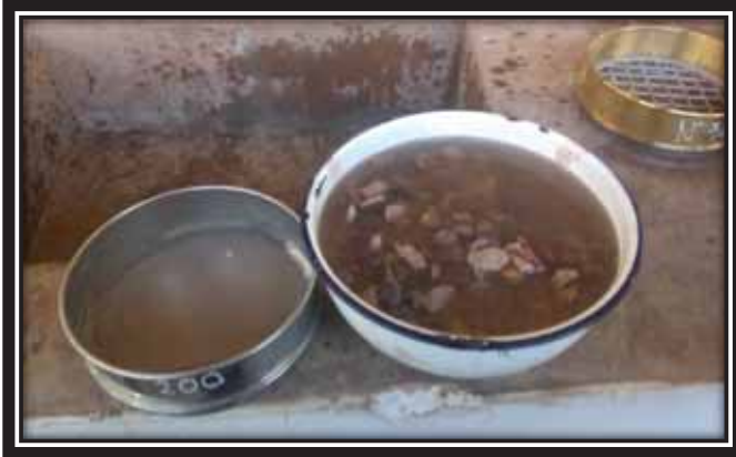
Ensayo, cantidad de fino que pasa el tamiz N° 200 del agregado grueso, realizado en el laboratorio de la escuela profesional de Ingeniería Civil de la Unsaac.
