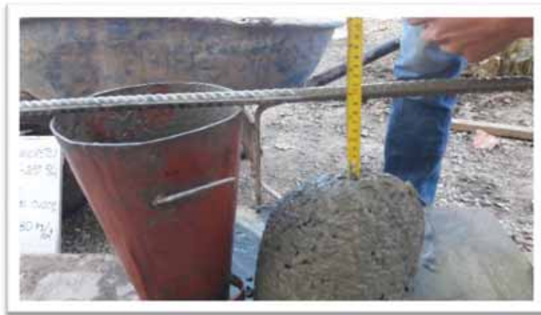
Figura 23. Medición del revenimiento de concreto, método normado.
