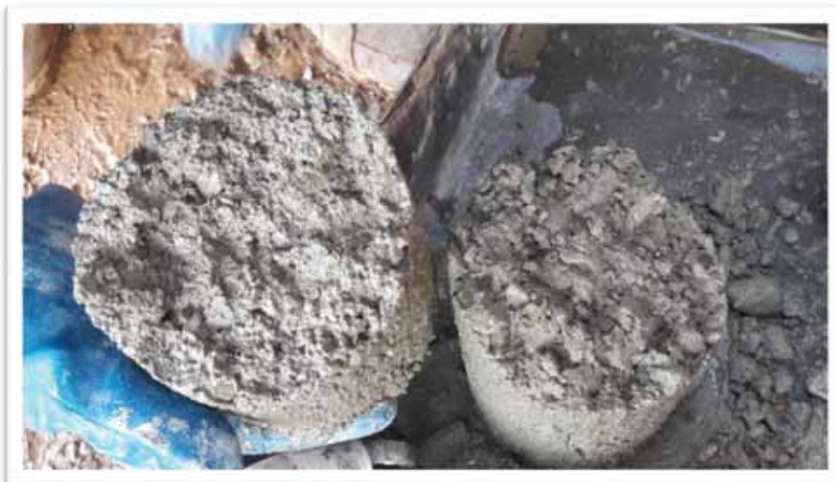
Figura 20. Corrección de la cantidad de pasta; se observa que los agregaos son cubiertos por la pasta.
