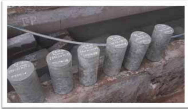
Figura 24. Preparado y codificación de testigos, para su ensayo de resistencia.
