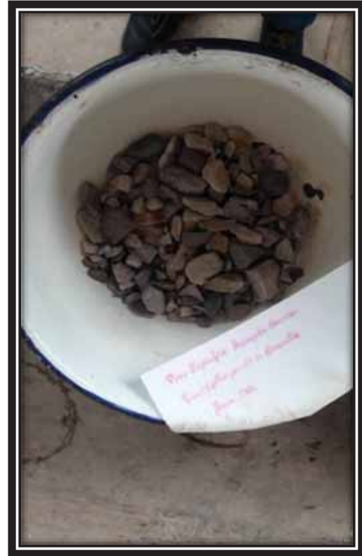
Ensayo, Peso específico del agregado grueso de Huambutio y peso después de secado al horno, realizado en el laboratorio de la escuela profesional de Ingeniería Civil de la Unsaac.
