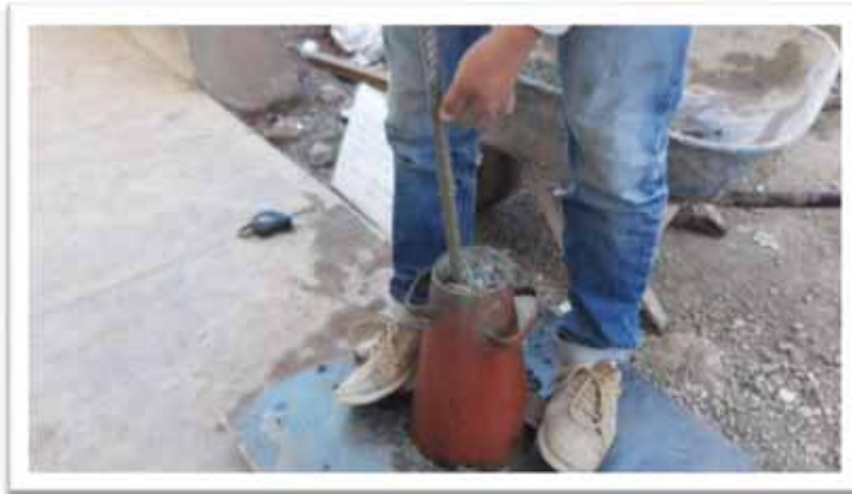
Figura 22. Varillado del concreto en el cono de Abrams, método normado.
