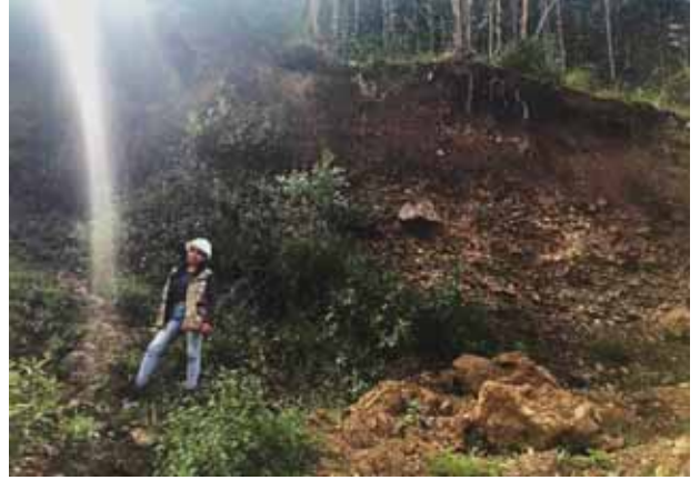
Fotografía N°20: Se aprecia el mismo material coluvial en el tramo de carretera Calca-Accha baja.
