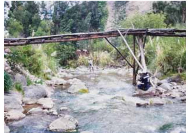
Fotografía N°10: Se observa la toma de tiempo en que recorre un objeto de un tramo definido.
