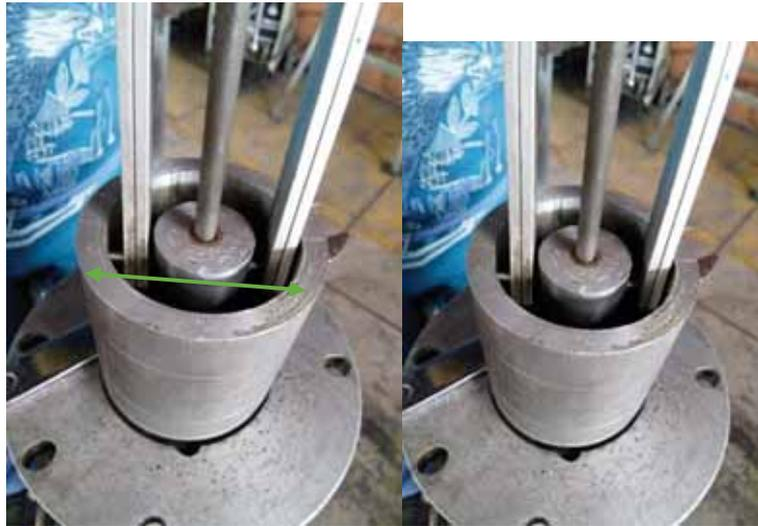
Figura 3.12. Bielas con el pistón de potencia (Fuente propia).
