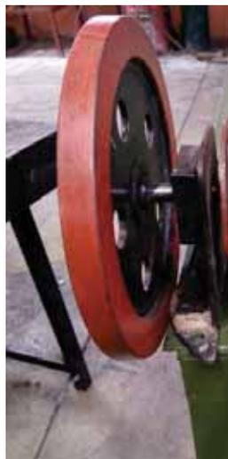
Figura 3.13. Volante de inercia (Fuente propia).
