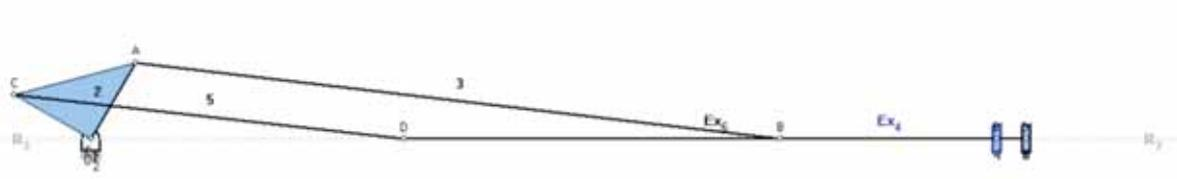
Figura 2.11. Diagrama de lazo vectorial del Motor Stirling tipo beta (Fuente propia)
