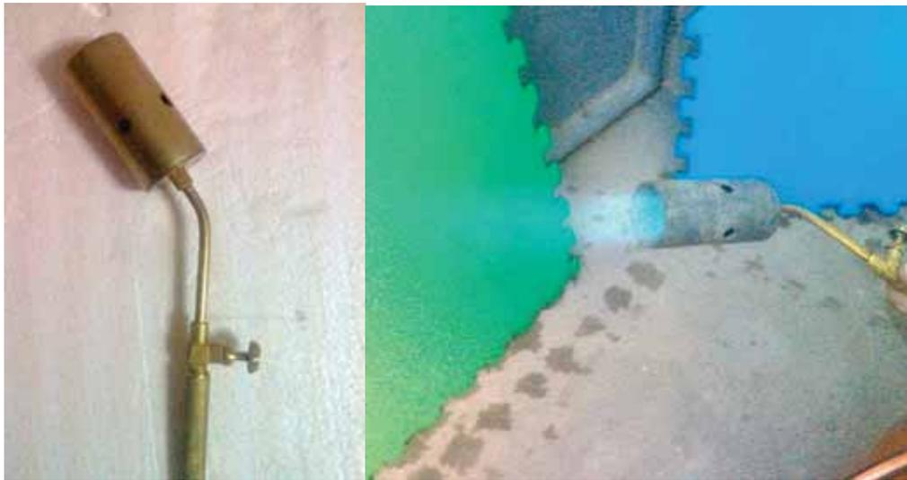
Figura 4.4. Quemador nuevo del motor stirling (Fuente propia).
