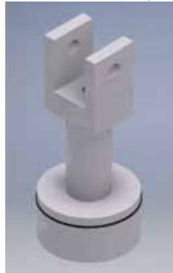
Figura 4.2. Nuevo piston de potencia (Fuente propia).
