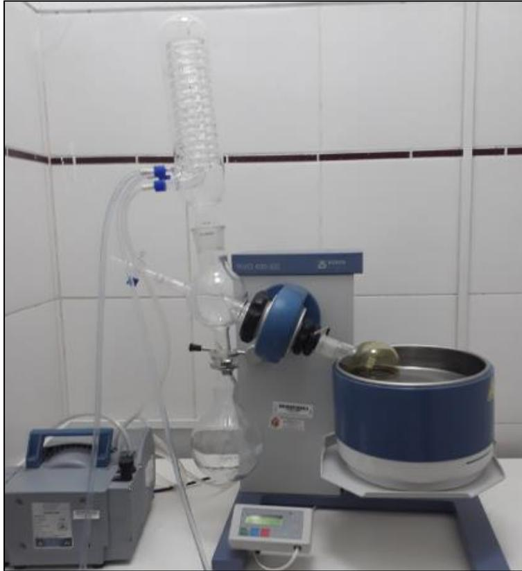
**FOTOGRAFÍA N° 3:** Proceso de concentración de las muestras para la obtención de los extractos mediante un rotavapor.
