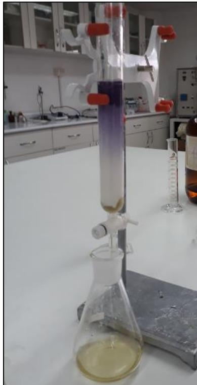
**FOTOGRAFÍA N° 8:** Proceso de Cromatografía en Columna realizado al extracto flavonoídico de *Viola tricolor* L.
