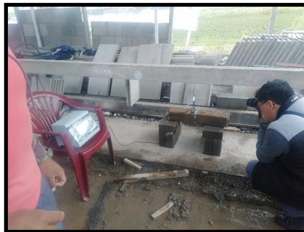
Ilustración 57: instalación de equipos para medir la deflexión de viga en campo
