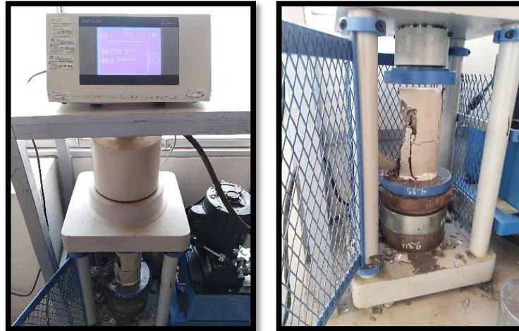
Ilustración 55: ensayo de compresión uniaxial de testigos de concreto
