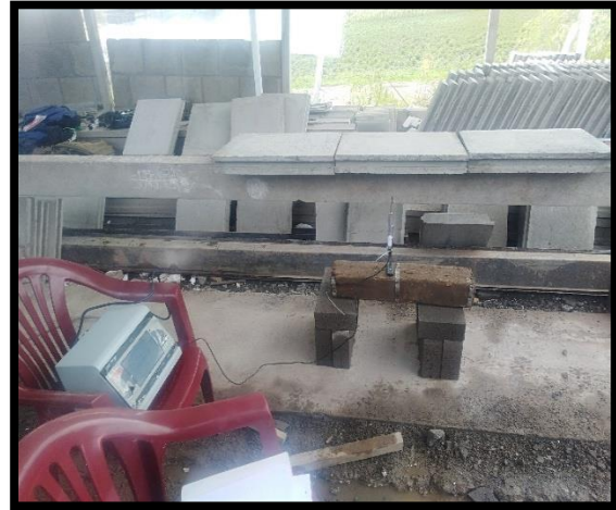
Preparación para segundo ensayo de flexión de viga en campo.
