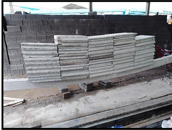
Proceso de aplicación de carga a viga antes de la falla.
