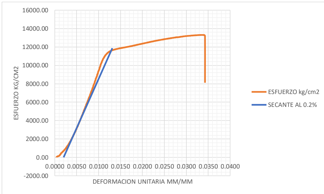
Gráfico 28: Límite de proporcionalidad al 0.2% aplicando a la muestra N° 1.
