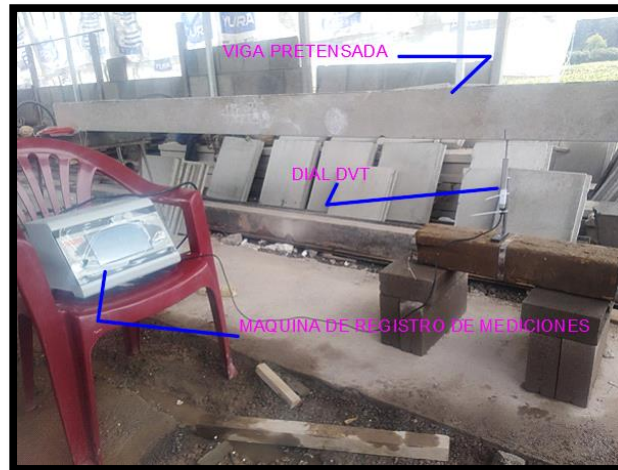
Ilustración 56: ensayo de deflexión de viga en campo
