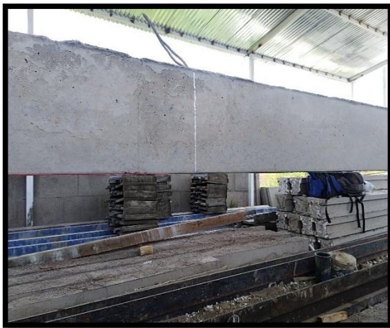
Marcado centro de luz de viga e inicio de aplicación de carga a la viga.
