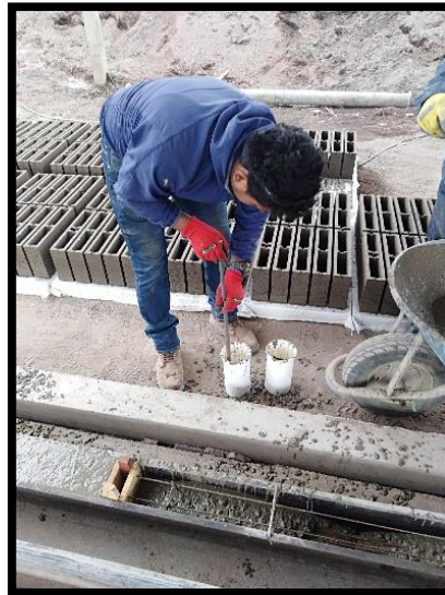
Extracción de testigos (briquetas) y finalizado de vaciado.
