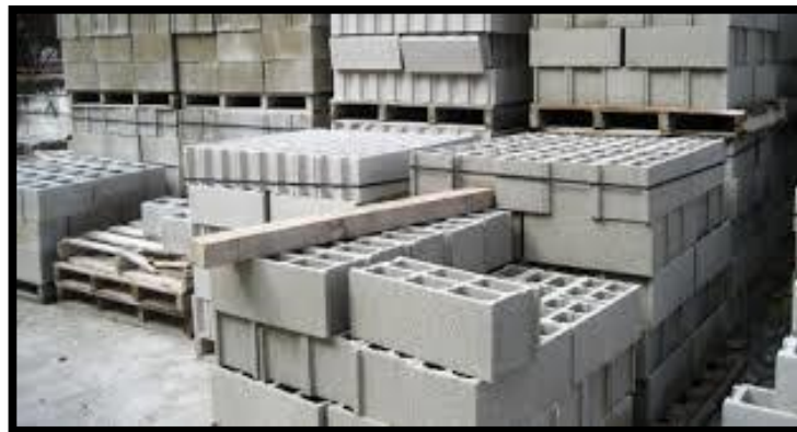
Ilustración 8: elementos prefabricados de bloques.
