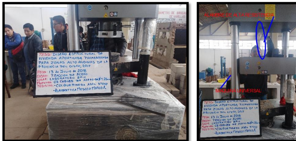
Ilustración 53 (a) (b): ensayo de tracción del alambre de alta resistencia.
