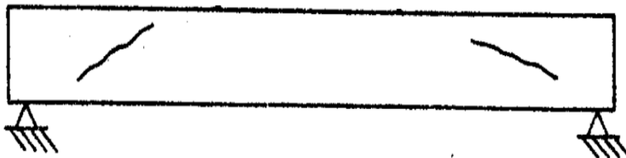
Ilustración 19: grietas producidas por efecto que la resistencia a la flexión no es menor a la resistencia de tensión diagonal
