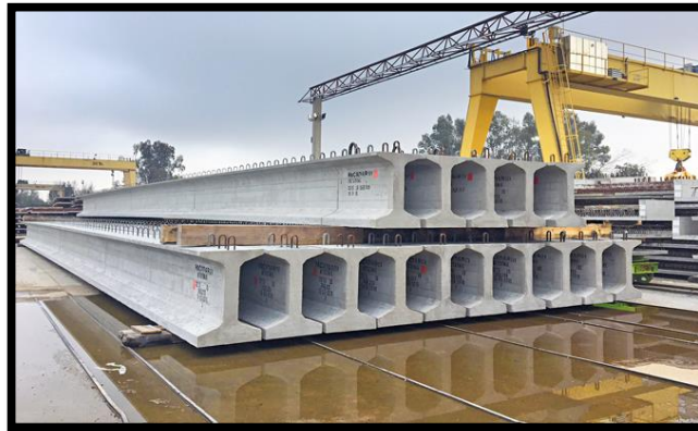
Ilustración 31: acarreo y almacenaje de vigas pretensadas.
