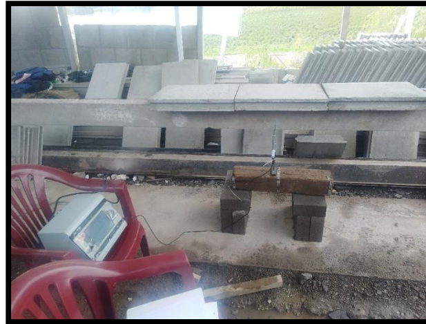
Ilustración 58: aplicación de cargas a viga en campo
