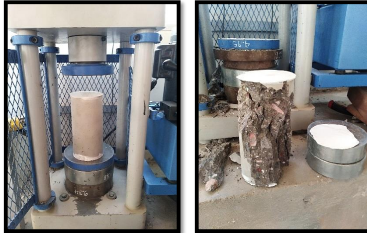
Sometiendo a carga de compresión y falla de la briqueta.
