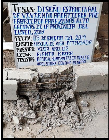
Resultado de acero después de la falla.
