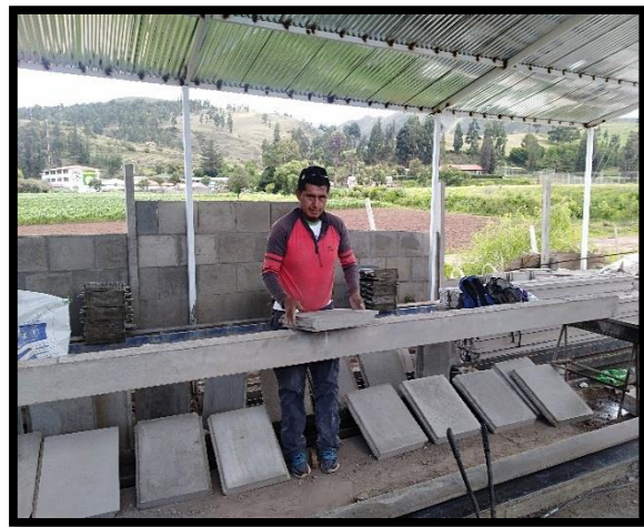
Marcado centro de luz de viga e inicio de aplicación de carga a la viga.
