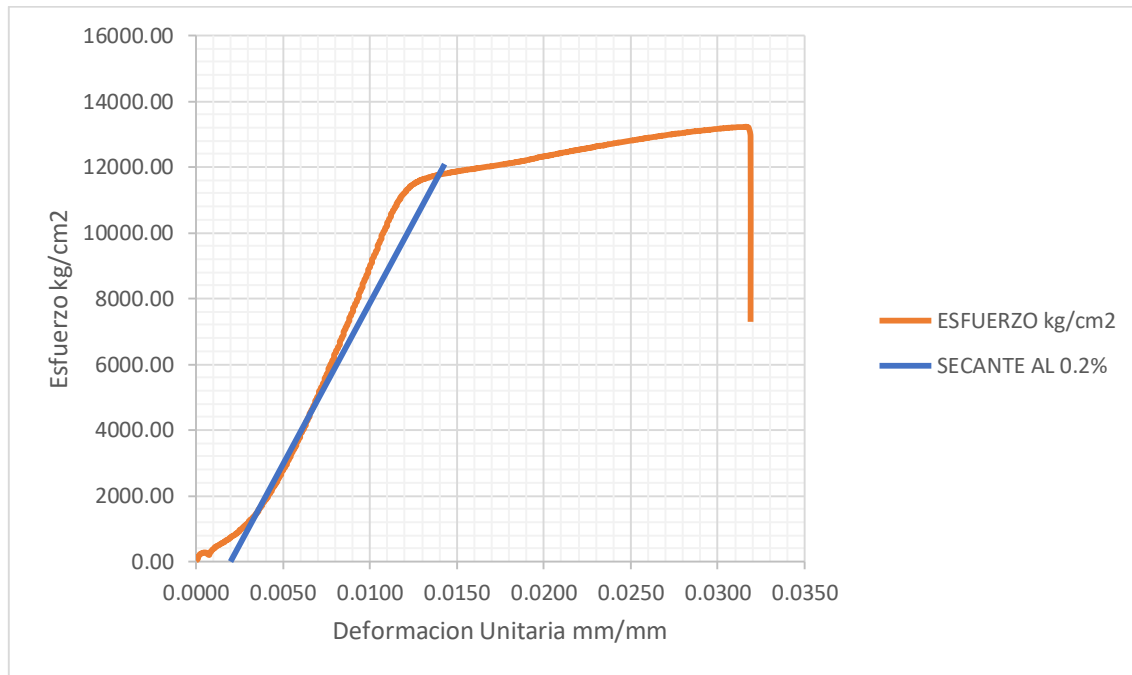
Gráfico 30: Límite de proporcionalidad al 0.2% aplicando a la muestra N° 3.
