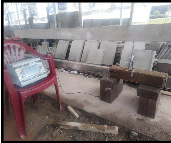
Preparación para segundo ensayo de flexión de viga en campo.
