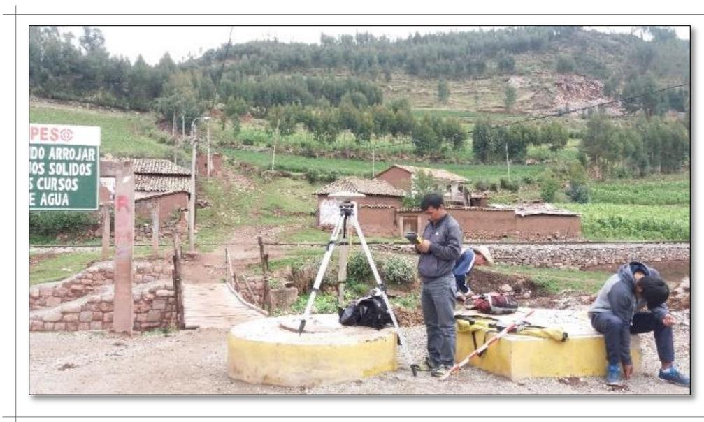
Foto N° 24.- Levantamiento Topográfico con estación total del Sitio Arqueológico de Saqsaywamanpata, sector III (Machuchaka) Fuente: A. Huaman.
