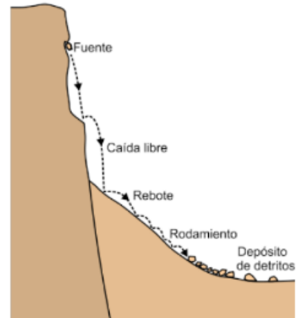
Imagen 1.- Esquema de caída de rocas (CENEPRED)
