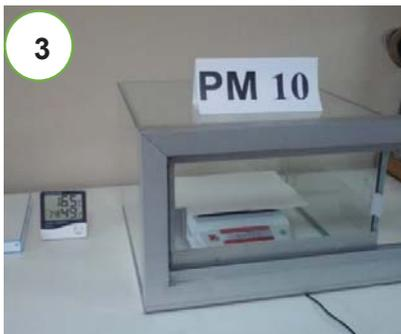
Foto N° 3 Medición de masa inicial antes del muestreo de material particulado menor a 10  $\mu\text{m}$
