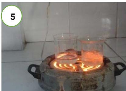
Foto N° 5 Preparación de la muestra para análisis de sulfatos en material particulado
