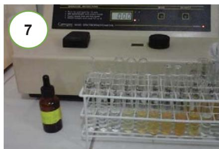
Foto N° 7 Elaboración de la curva de calibración de nitratos
