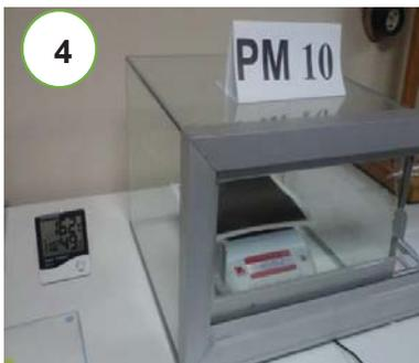
Foto N° 4 Medición de masa final después del muestreo de material particulado menor a 10  $\mu\text{m}$
