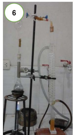
Foto N° 6 Digestión de la muestra para análisis de nitratos en material particulado
