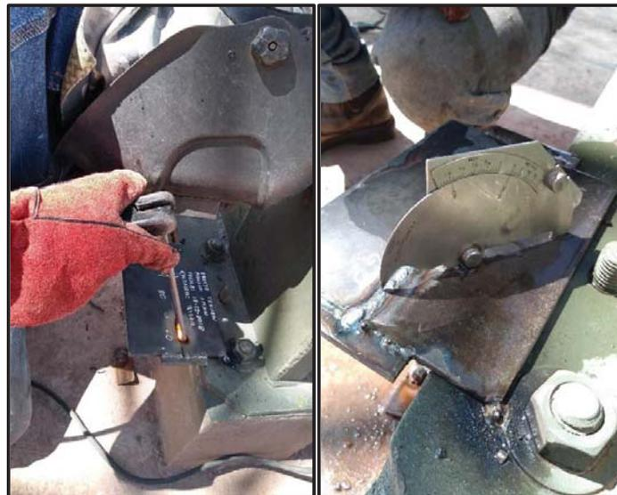
*Figura 45. Soldeo de probeta tekken, proceso SMAW*
