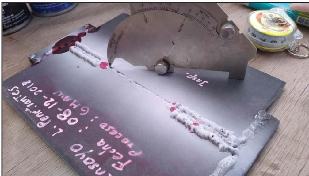
Figura 51. Inspección con líquidos penetrantes antes de 24 horas
