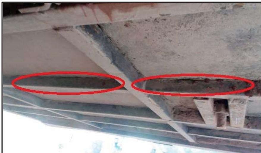
*Figura 5.* Deformación de la carrocería posterior. Fuente Propia
