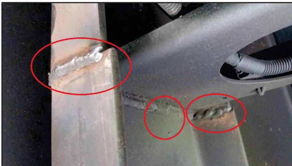
*Figura 8.* Discontinuidades en la Soladura, falta de fusión, salpicaduras. Fuente propia
