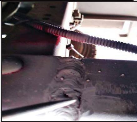
Figura 25. Inspección de unión soldada 01. Fuente propia
