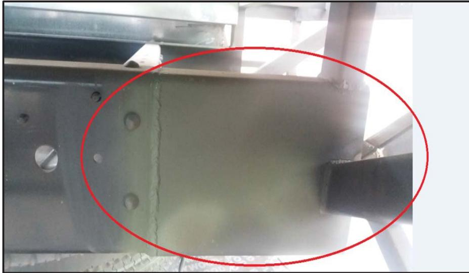
*Figura 6.* Ampliación de chasis con perfil "C". Fuente Propia
