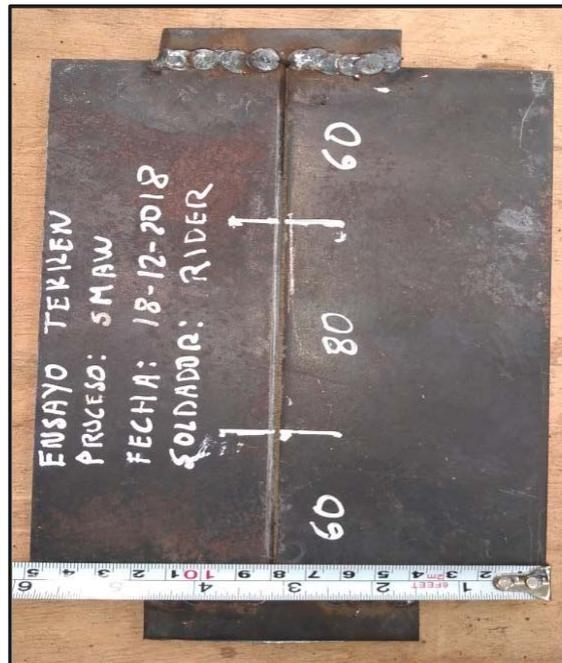
Figura 44. Probeta TEKKEEN para proceso SMAW. Fuente propia
