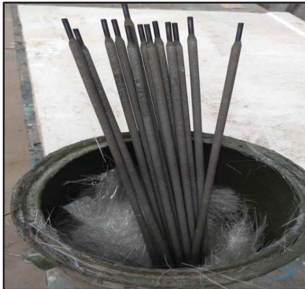
*Figura 39.* Almacenaje inaceptable del electrodo E7018. Fuente propia
