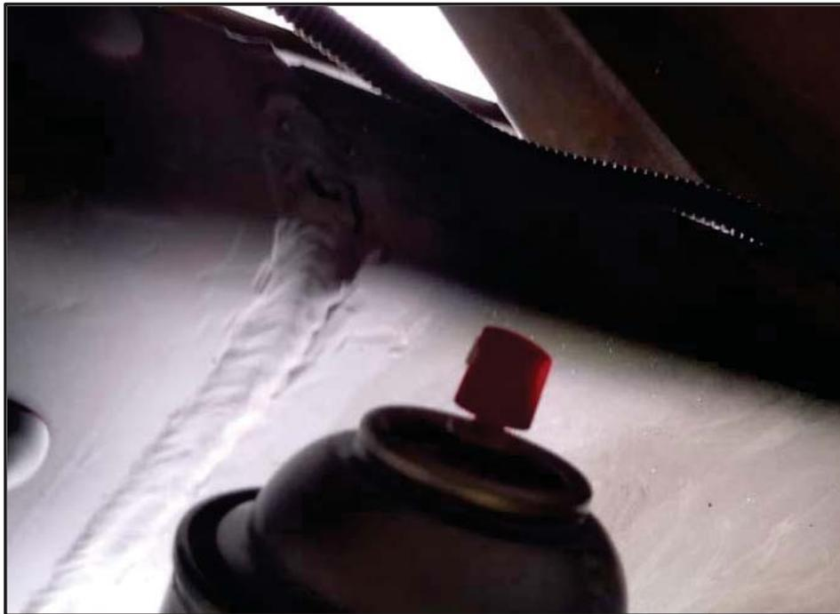
*Figura 7.* Fisuración del de la unión soldada del chasis. Fuente propia
