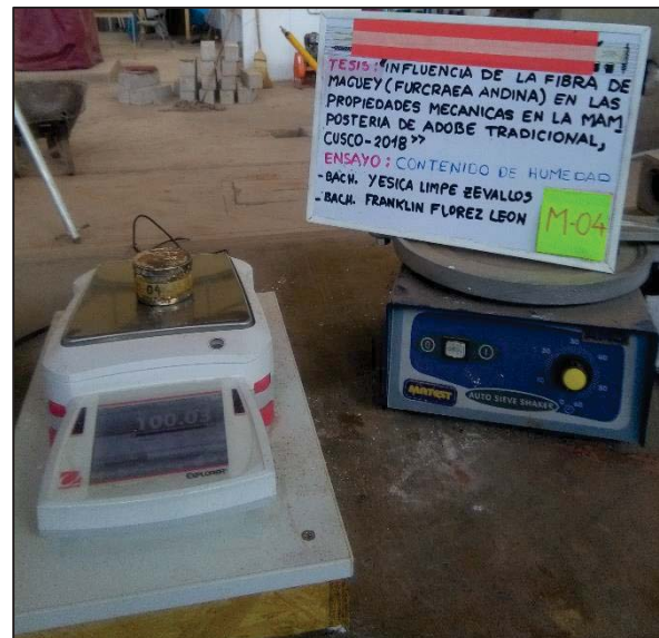
Medición del peso de muestra húmeda y capsula M-04.
