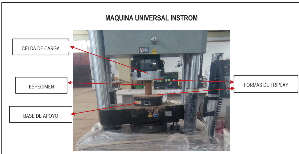
Figura 36. Instrumentación en ensayo de compresión de testigos cilíndricos de mortero de barro.
