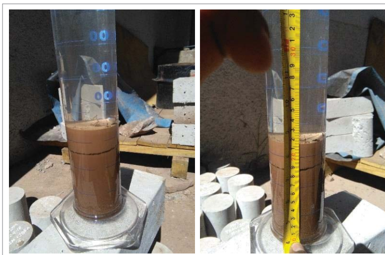
Figura 11. Prueba de la botella con la muestra de suelo a usar.
