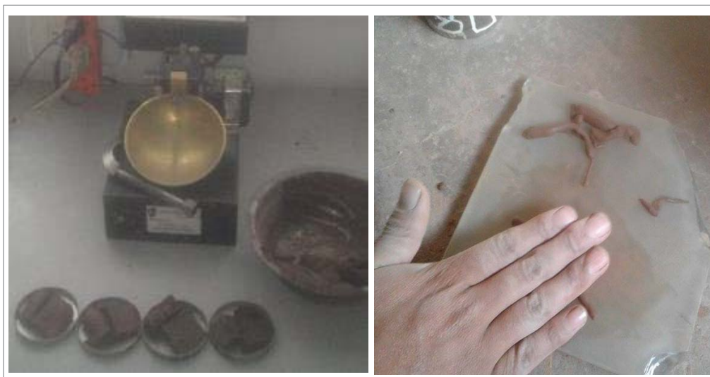
Figura 19. Procedimiento de ensayo para límites de plasticidad del suelo.
