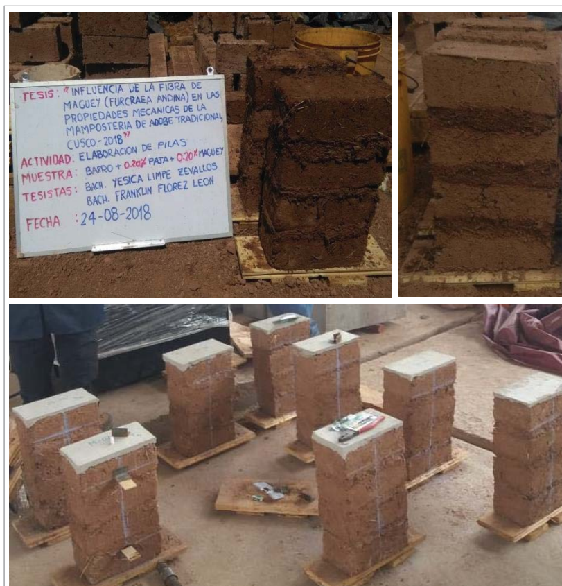
Figura 32. Preparación de pilas de adobe y colocación de capping.
