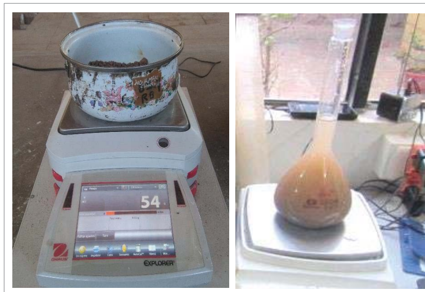
Figura 16. Ensayo de peso específico relativo de los suelos.
