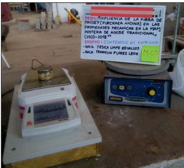
Medición del peso de muestra húmeda y capsula M-03.
