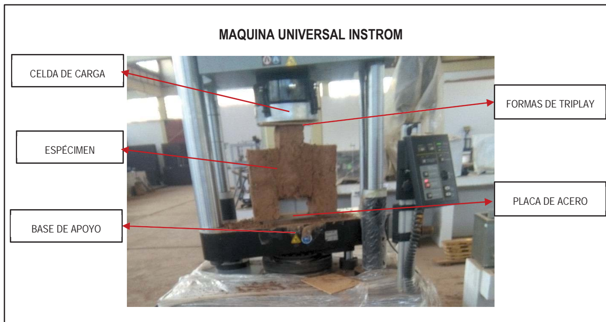
Figura 37. Instrumentación de probetas de tres piezas de adobe para prueba de adherencia.
