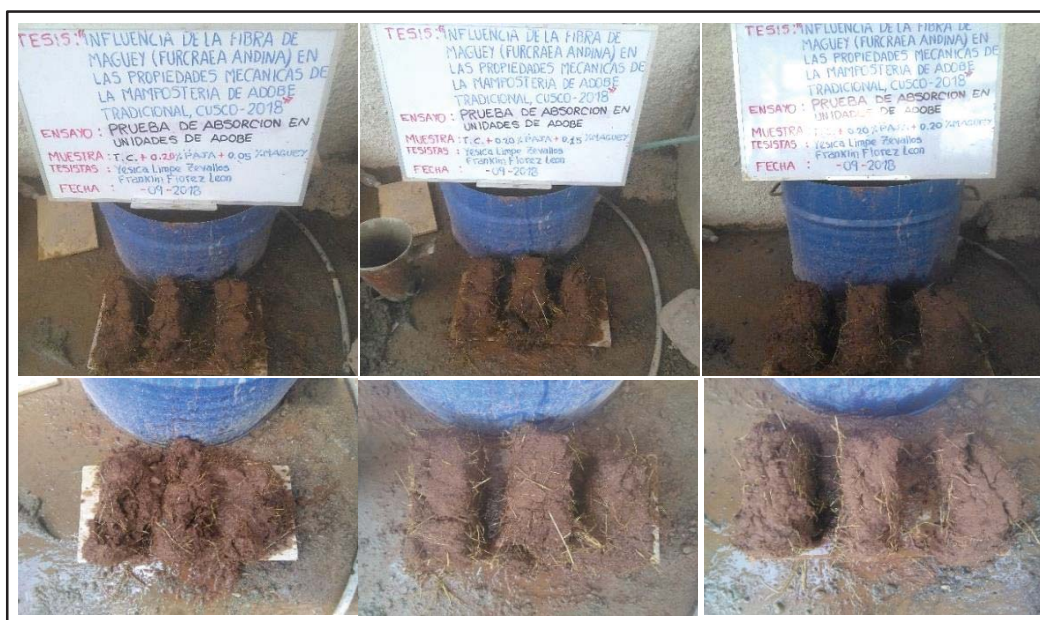
Figura 40. Especímenes de adobe después de la inmersión en agua de ensayo de absorción.
