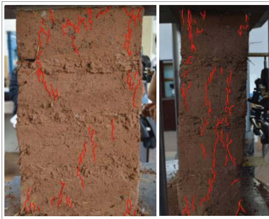
Figura 48. Tipo de falla en pila TIPO 3 muestra (M-01).
