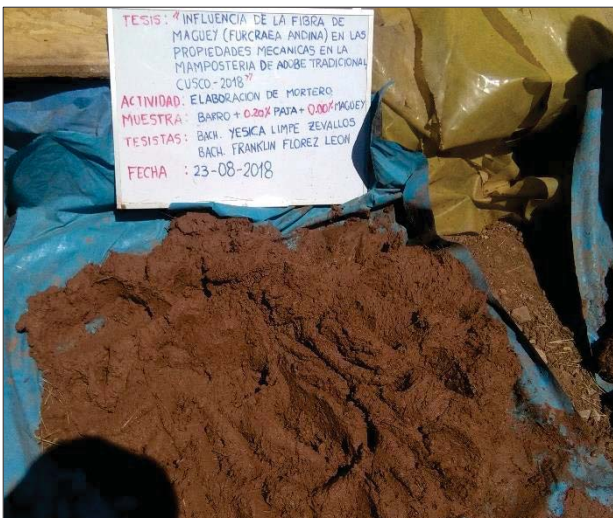
Mortero Tipo 2 (Barro + 0.20% de paja + 0.00% de fibra de maguey)
