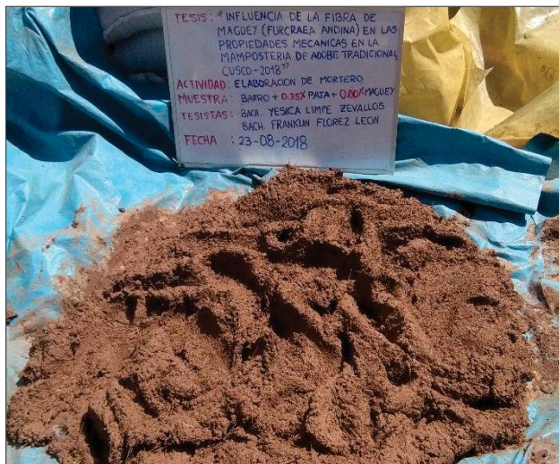
Mortero Tipo 1 (Barro + 0.35% de paja + 0.00% de fibra de maguey)
