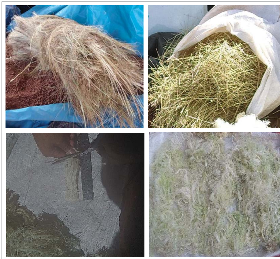
Figura 23. Recorte de fibras a utilizar en la elaboración de adobes.
