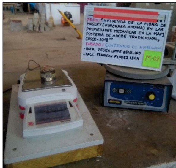
Medición del peso de muestra húmeda y capsula M-02.
