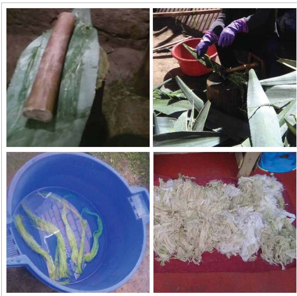
Figura 13. Proceso de extracción para la obtención de la fibra de maguey.
