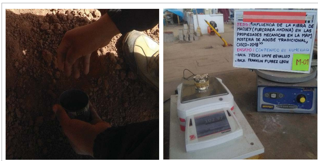
Figura 14. Prueba de contenido de humedad del suelo seleccionado.
