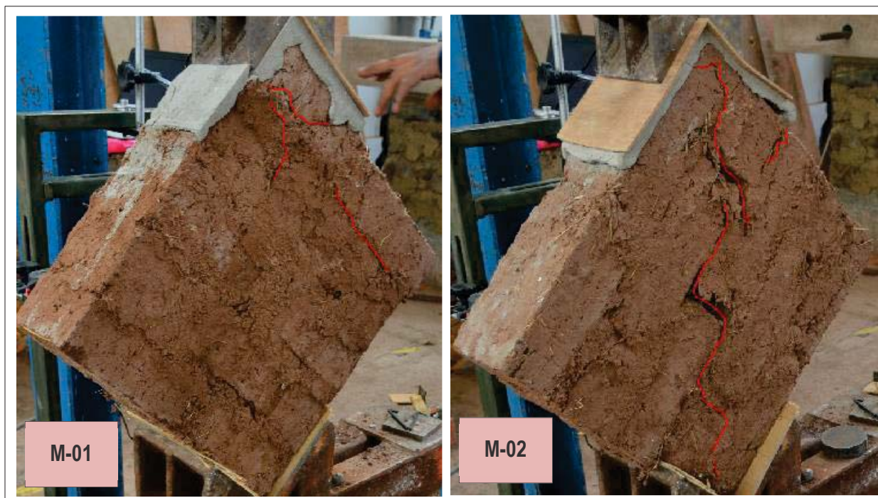
Figura 64. Falla por adherencia de muretes Tipo 4, M-01 y M-02 respectivamente.
