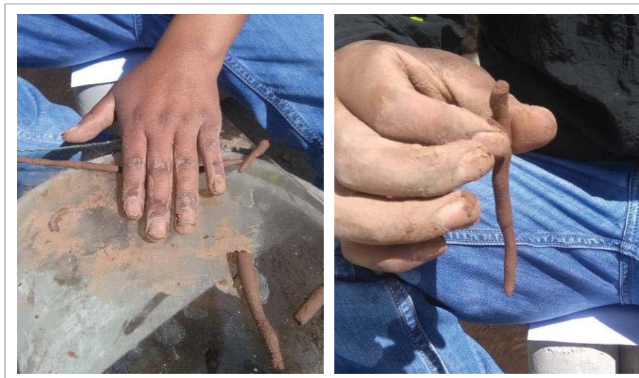
Figura 9. Elaboración de cintas de barro para prueba de enrollado.
