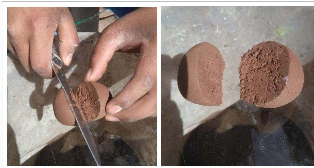
Figura 8. Corte con cuchillo de bolitas de barro para prueba de brillo.
