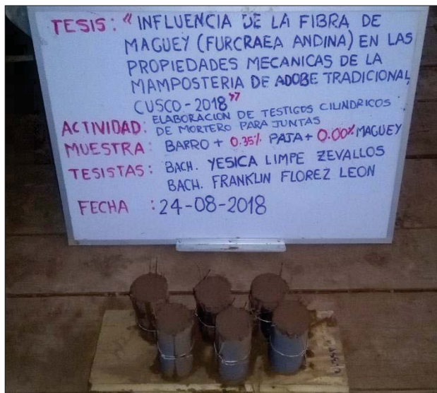
Muestra Tipo 1 (Barro + 0.35% de paja + 0.00% de fibra de maguey)
