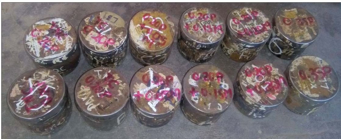
Capsulas con muestra de mortero de barro después del dormido para todos los tipos de muestra.
