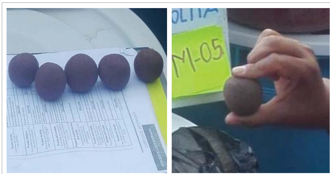
Figura 10. Prueba de resistencia seca, después de 48 horas de secado.
