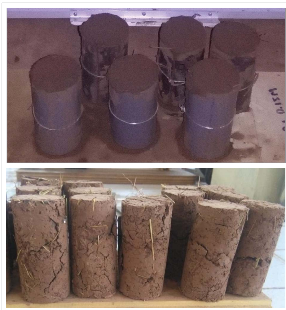
Figura 29. Elaboración y secado de testigos cilíndricos de mortero de barro.
