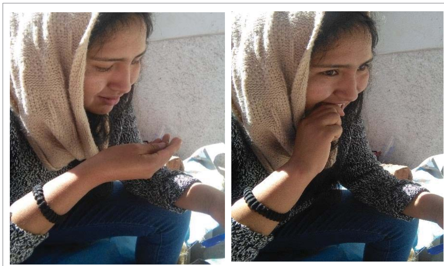
Figura 6. Prueba dental del suelo seleccionado.
