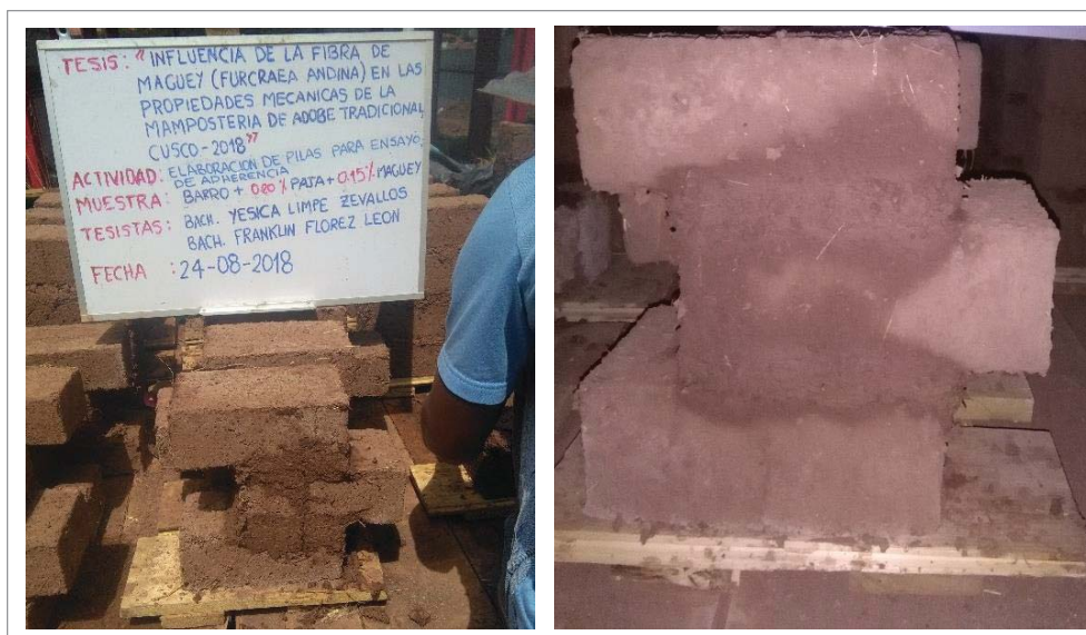
Figura 31. Preparación de probetas de tres piezas para prueba de adherencia.
