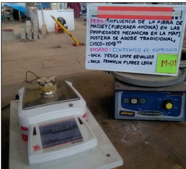
Medición del peso de muestra húmeda y capsula M-01.
