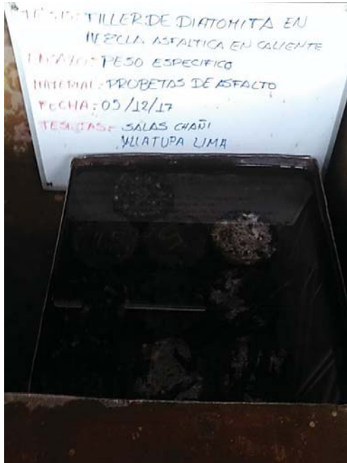
Figura 27: Probetas sumergidas para realizar el ensayo
