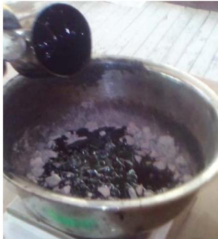
Figura 25: Mezclado de Asfalto con Agregado
