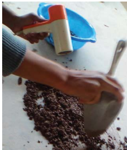
Figura 8: Obtención del Peso Saturado con Superficie Seca Fuente: Propia
