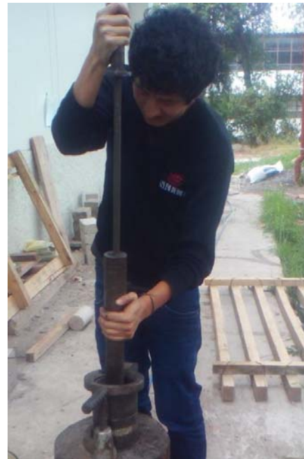
Figura 26: Compactación de probetas
