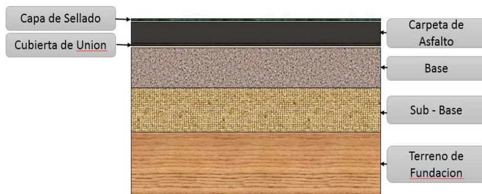
Figura 1. Sección típica de un pavimento flexible convencional Fuente: Elaboración Propia
