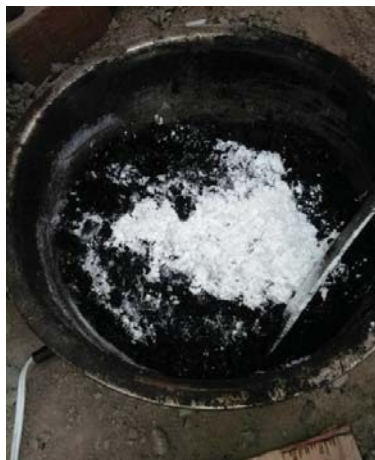
Figura 30: Mezclado de agregado asfalto y diatomita
