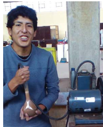
Figura 9: Eliminación de los vacíos mediante la bomba de vacíos Fuente propia
