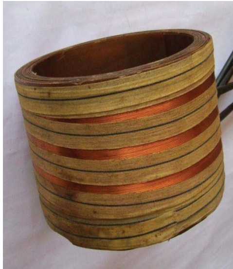
Figura 2.5: Devanado del tipo cilíndrico concéntrico Fuente: Material Fotográfico electrovol.
