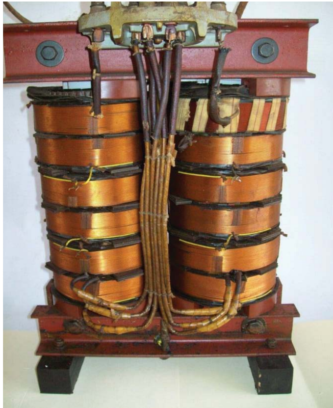
Figura 2.6: Devanado tipo disco Fuente: Material Fotográfico propio (Electrovolt)
