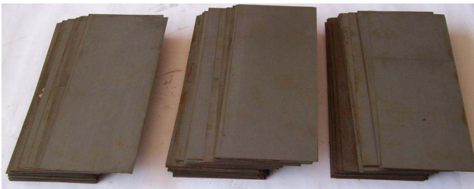
Figura 2.3: Láminas de acero al silicio Fuente: Fotografía propia
