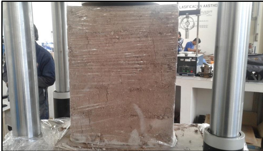
Falla de pila típica, presencia de agrietamientos verticales.
