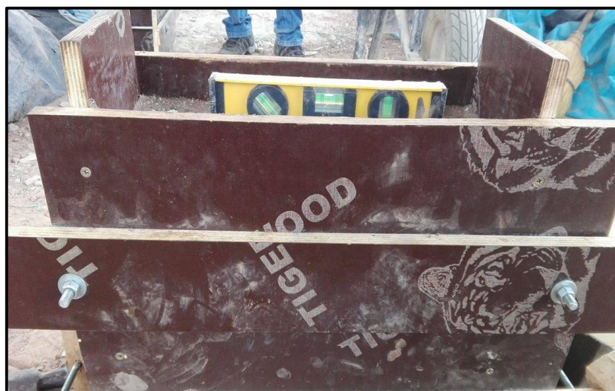
Control de horizontalidad del espécimen.
