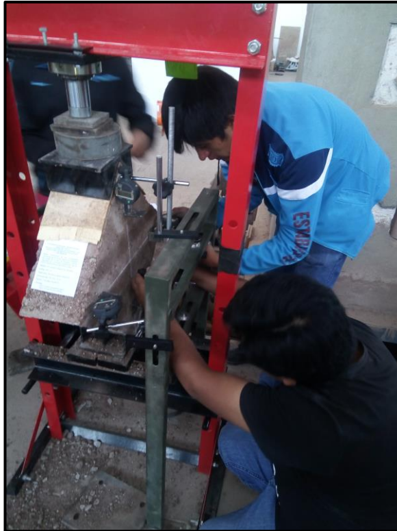
Colocación de diales en los topes del murete.
