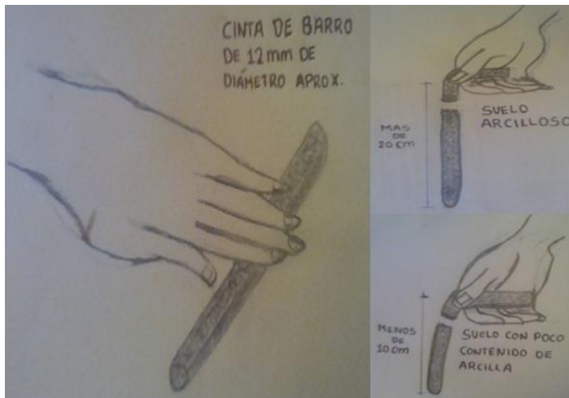
Figura 2. Prueba de campo "cinta de barro"
