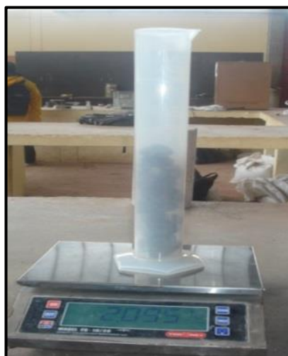
Ensayo de peso específico del agregado grueso
