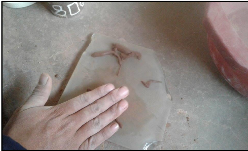
Ensayo de límite plástico.
