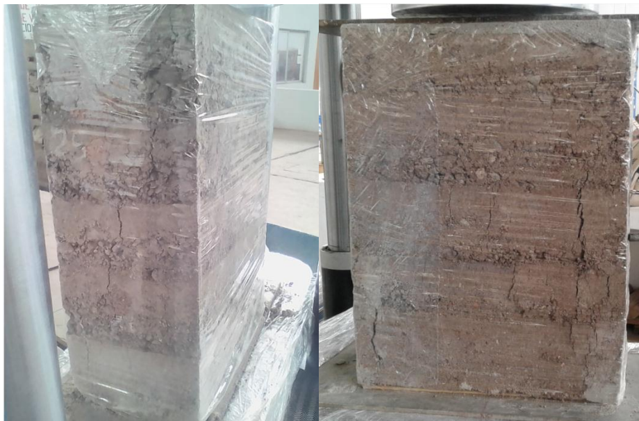
Figura 40. La pila (PT-5) presenta una falla dúctil.
