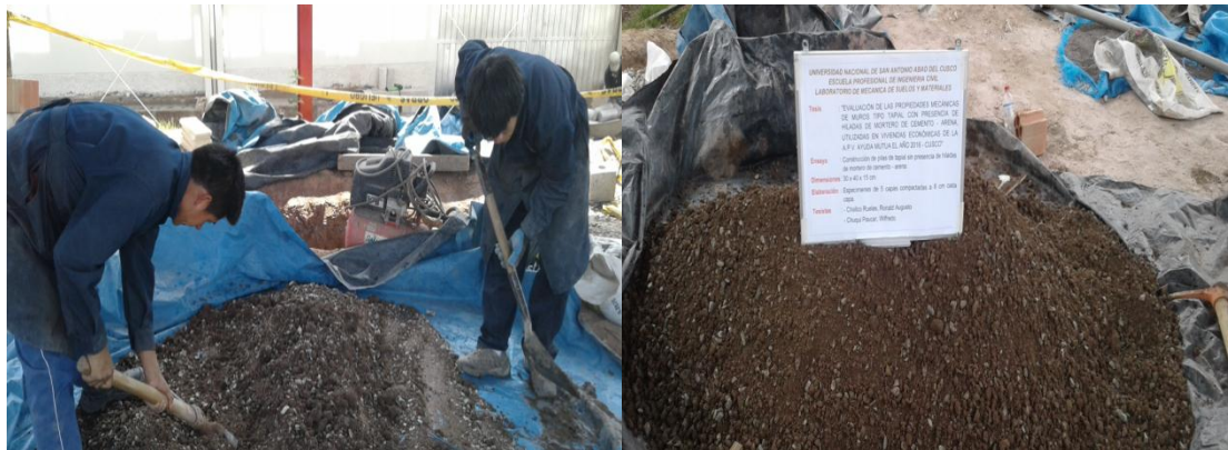
Figura 24. Preparación de la tierra con la adición de agregado grueso y confitillo. Fuente: Elaboración propia.
