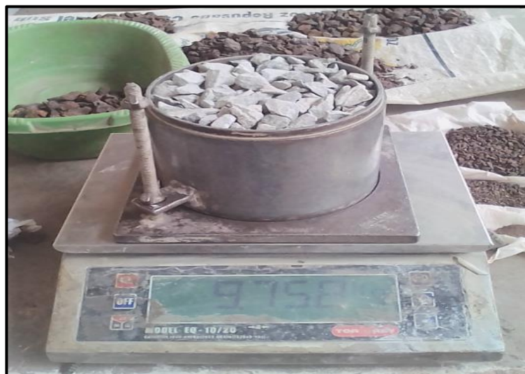
Ensayo de peso unitario del agregado grueso
