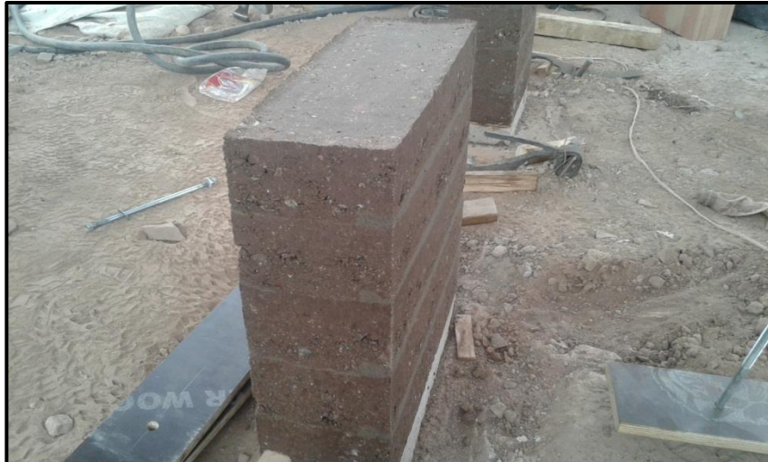
Espécimen fuera del desencofrado
