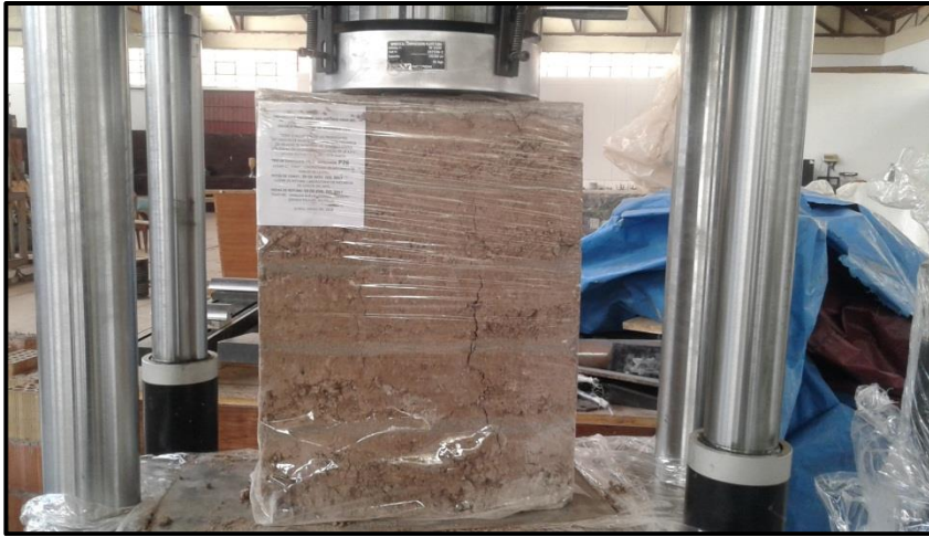
Falla de pila con refuerzo, presencia de agrietamientos verticales.
