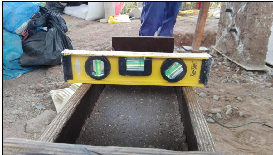
Control de nivel del espécimen una vez compactado
