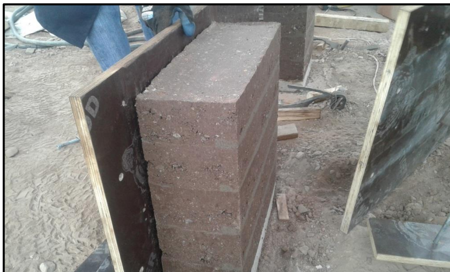
Espécimen en proceso de desenformado.
