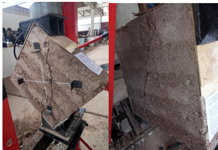
Figura 47. Falla por tracción diagonal en el murete cuadrado típico (MT-8) Fuente: Elaboración propia.
