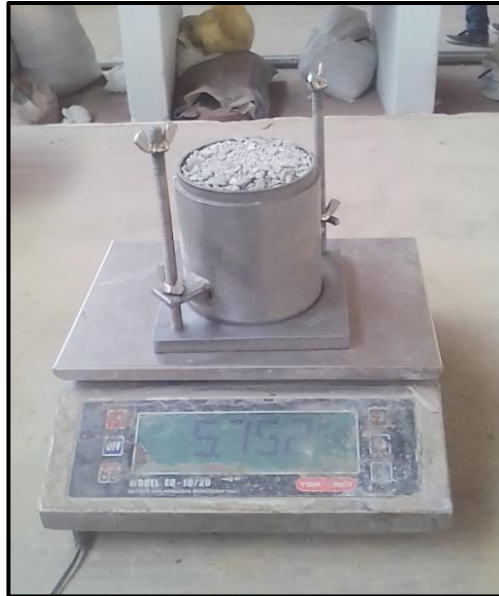
Ensayo de peso unitario del agregado fino.
