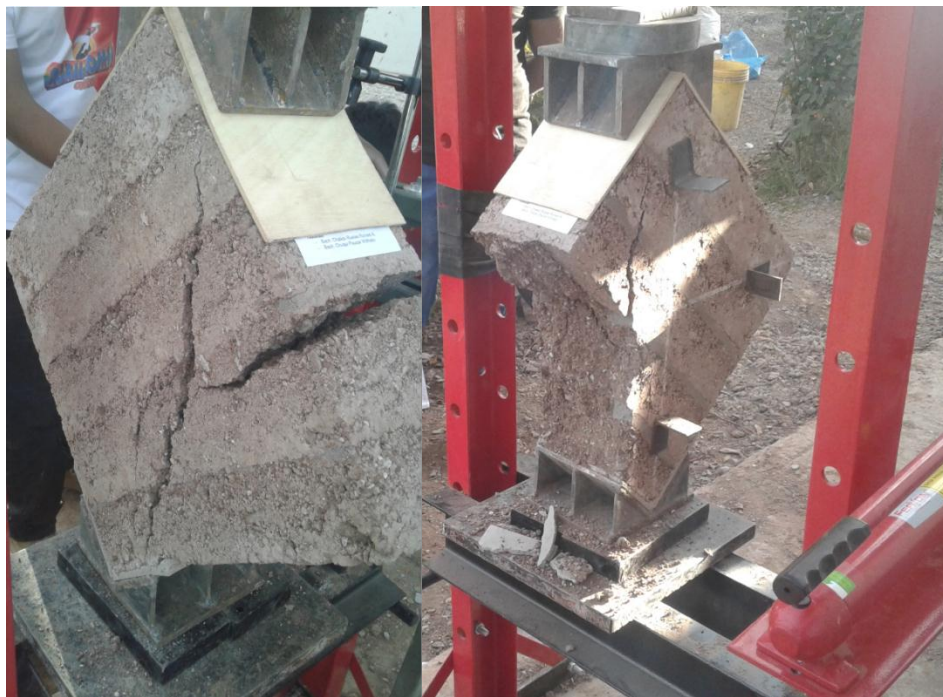
Figura 49. Falla mixta en el murete cuadrado reforzado (MR-7)
