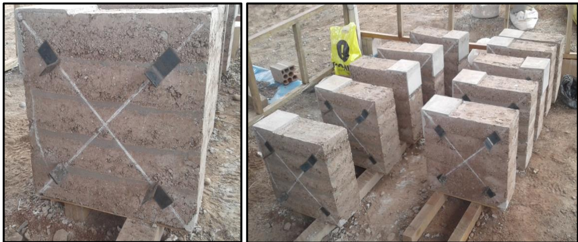
Colocado de angulares en las diagonales de los muretes; así mismo recubrimiento con capping en las 2 esquinas de una diagonal.
