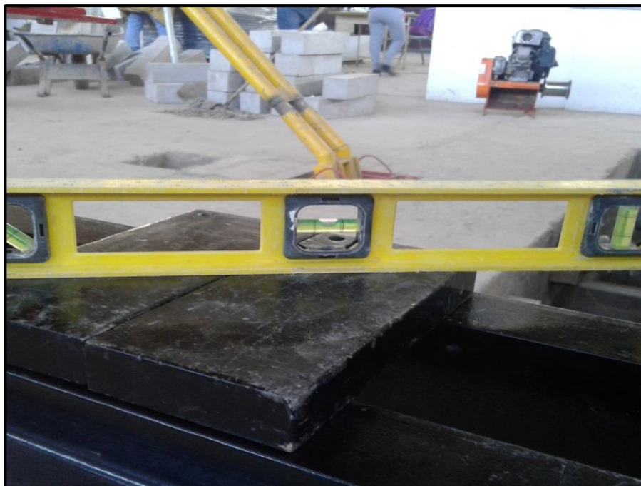
Control de horizontalidad del equipo de compresión diagonal.
