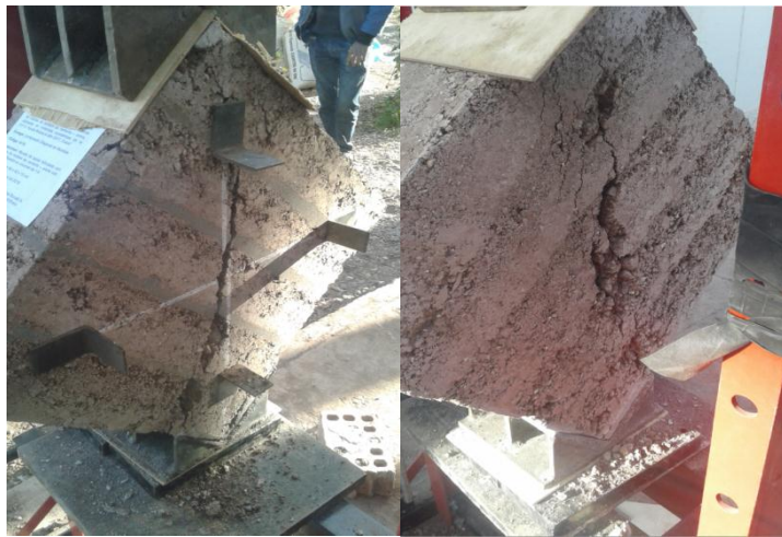
Figura 46. Falla por tracción diagonal en el murete cuadrado reforzado (MR-5) Fuente: Elaboración propia.
