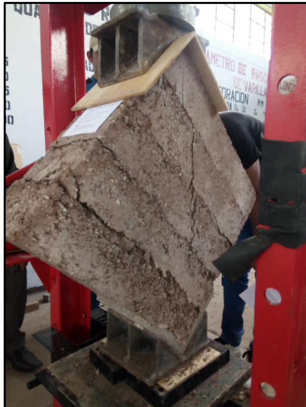
Falla diagonal del muro típico.
