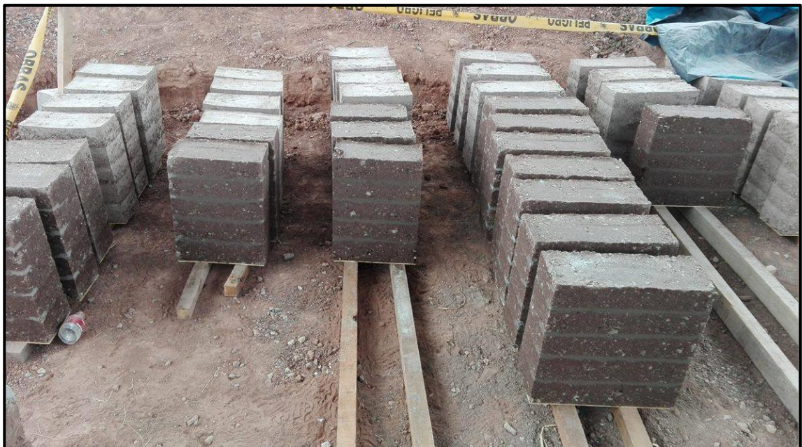
Proceso de secado de pilas y muretes de tapial.
