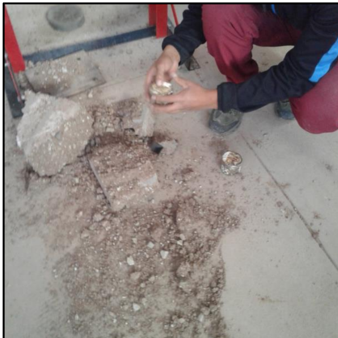
Toma de muestras de tierra, inmediatamente después del ensayo de compresión diagonal en muretes.
