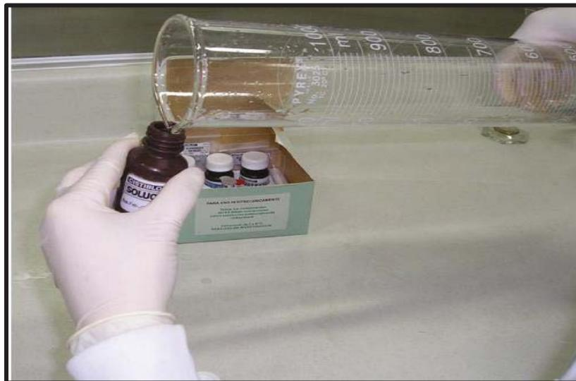
Figura N° 19: Vaciar el contenido del frasco en una probeta conteniendo agua destilada hasta un volumen final de 300 ml, homogenizar y vaciar al frasco de vidrio.
