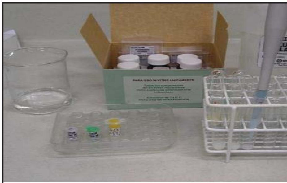
**Figura N° 25:** En los tubos de prueba para sueros problemas agregar 500ul del buffer de dilución de a muestra con 20ul del suero problema.
