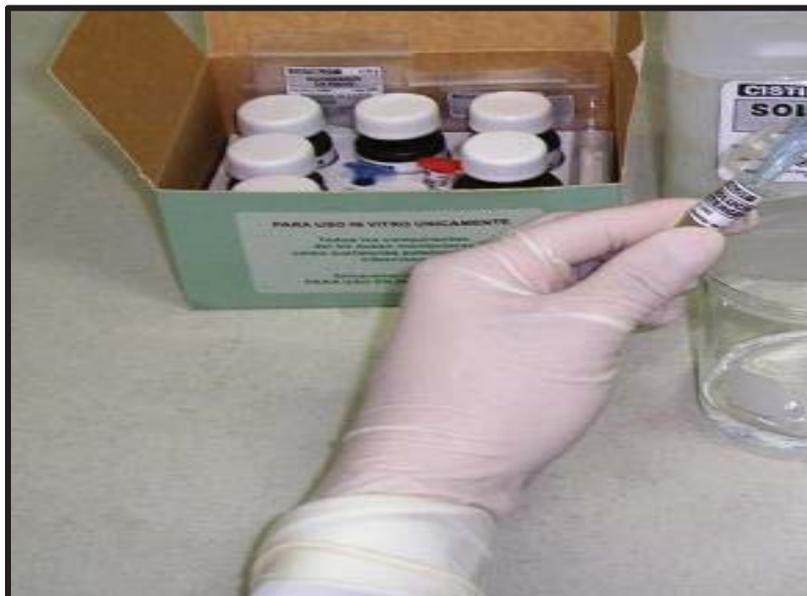
**Figura N° 20:** Para trabajar 1 placa llena es necesario preparar 50ml de solución de trabajo, en 50 ml de solución de lavado añadir 300 ul de solución detergente.
