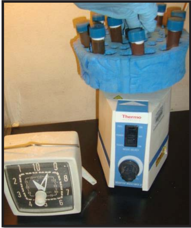
Figura N° 91: vortex, para que los beats rompan las estructuras y liberen el ADN
