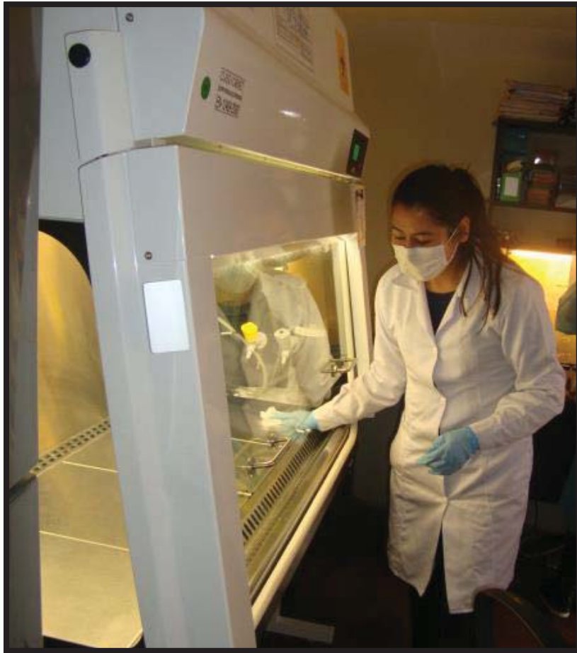
Figura N° 88: Desinfección la cámara de bioseguridad con lejía al 5 % para iniciar el procedimiento de extracción.
