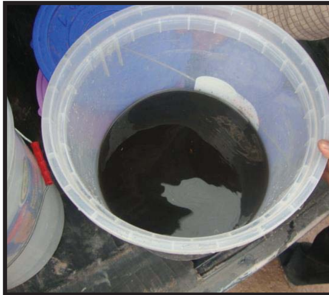
Figura N° 62: Sedimentación por gravedad simple durante 24 horas, para obtener sedimento y posteriormente, descartar aproximadamente 12 L de sobrenadante.
