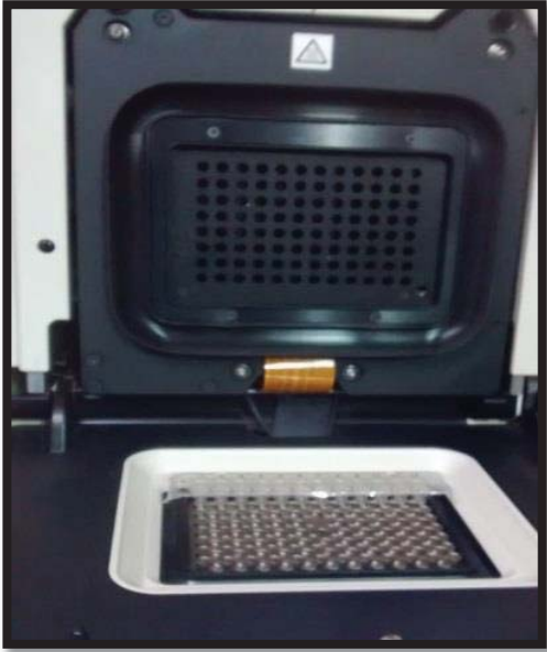
Figura N° 115: colocaron los pozos en el Termociclador
