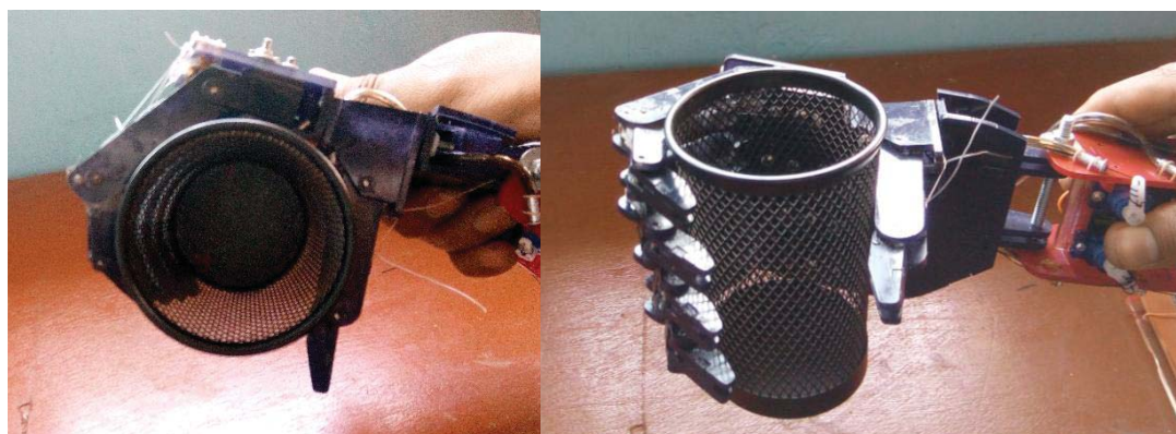
Figura 7.5 Sujeción Cilíndrica. Fuente propia.
