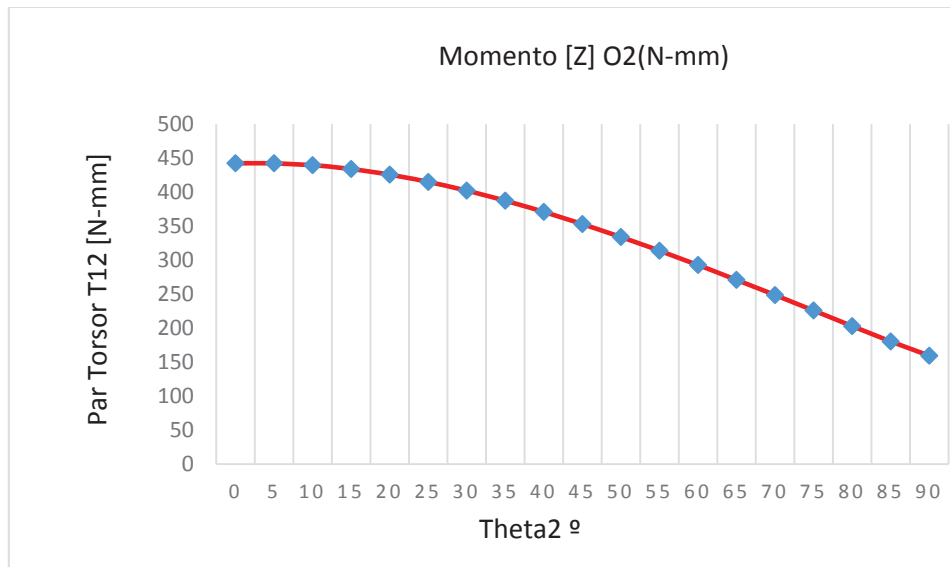
Figura 4.95 Par torsor en el Eslabón 2 del mecanismo. Fuente: propia, simulación Autodesk Inventor 2015.
