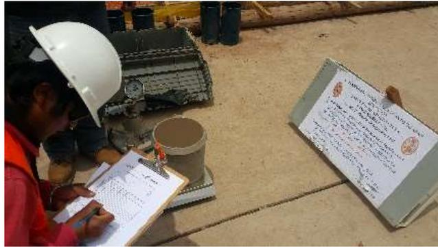
Figura 8.6 Peso Unitario del concreto en estado fresco.
