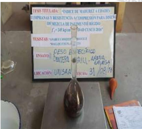
Figura 17 Ensayo de peso específico de agregado fino
