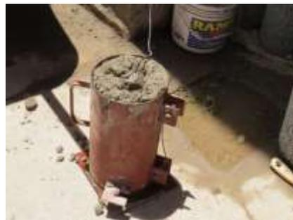
**Figura 6.6** Introducción de sensor de temperatura en Cilindro de concreto.
