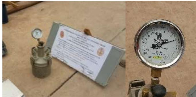
Figura 8.7 Contenido de aire del concreto en estado fresco.
