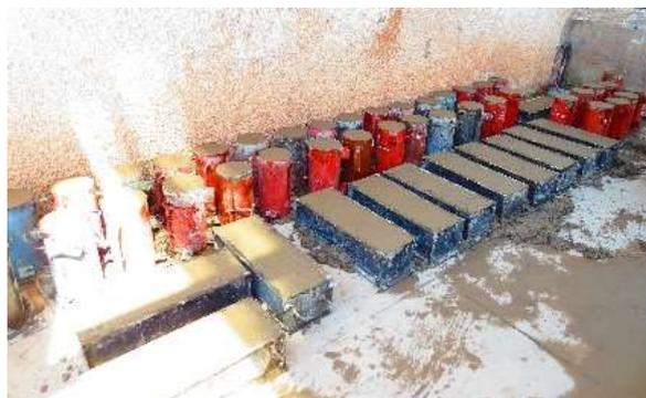
**Figura 6.4** Elaboración de vigas y cilindros de concreto.
