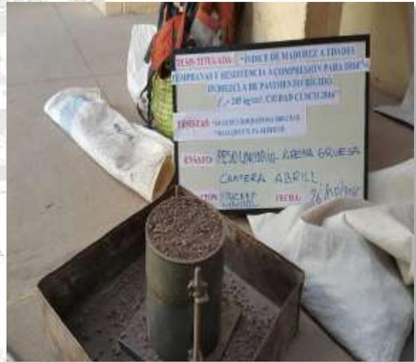
Figura 10 Análisis de peso unitario de agregados
