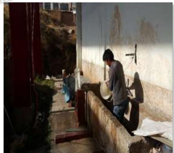
Figura 18 Limpieza de la poza de curado de especímenes de concreto
