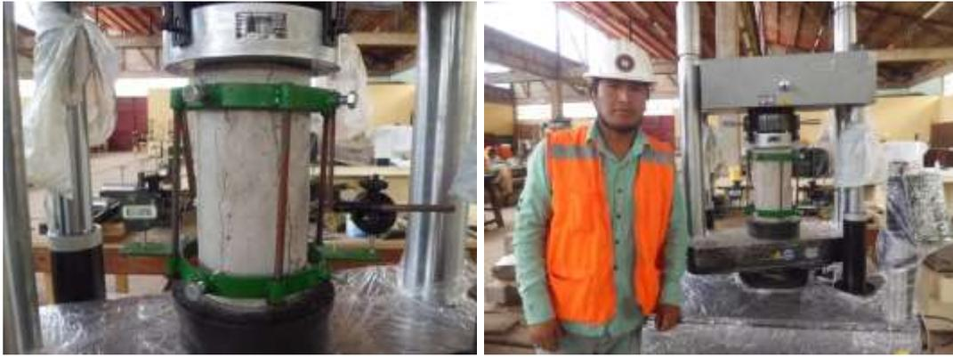
Figura 6.10 Montaje ensayo de módulo de elasticidad en cilindros de concreto.
