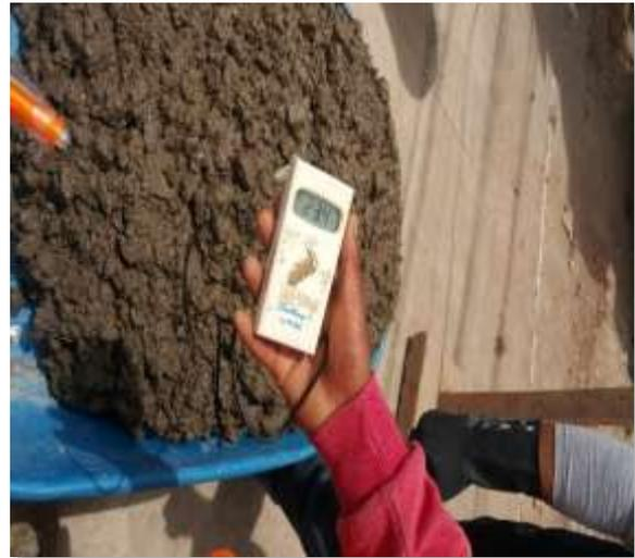
Figura 8 Control de la temperatura del concreto .
