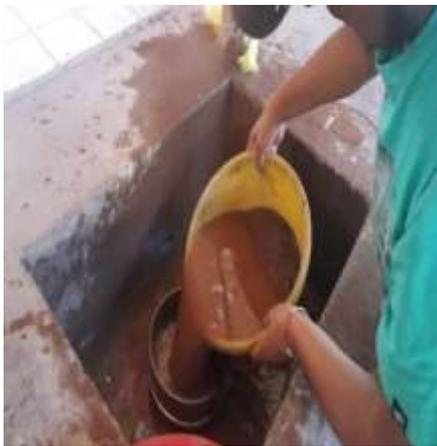
Figura 5 Ensayo de tamiz #200.- cantidad de finos
