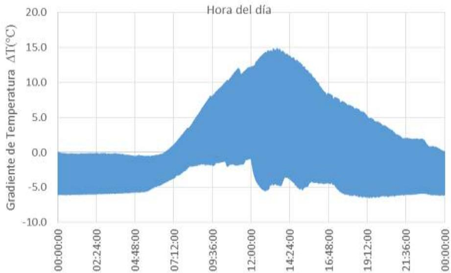
Figura 9.7 envolvente gradiente termico estacion 1+145.
