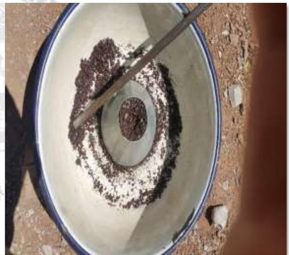
Figura 16 Ensayo de absorción en agregado fino
