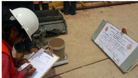
Figura 7.5 Peso Unitario del concreto en estado fresco.
