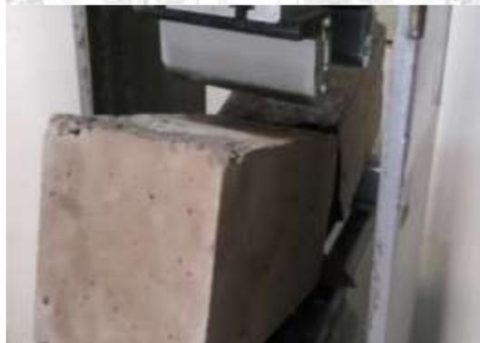
**Figura 7.13** Falla en los 2/3 de la viga.
