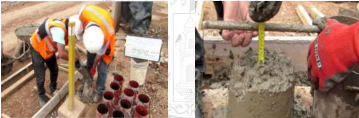
Figura 8.8 Asentamiento del concreto estación 1+145.
