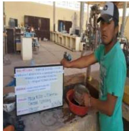
Figura 6 Ensayo de tamiz #200.- cantidad de finos
