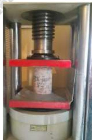
Figura 18 ensayo a compresión de núcleos de diamantina
