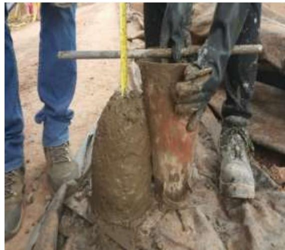
Figura 6 Ensayos de asentamiento en obra
