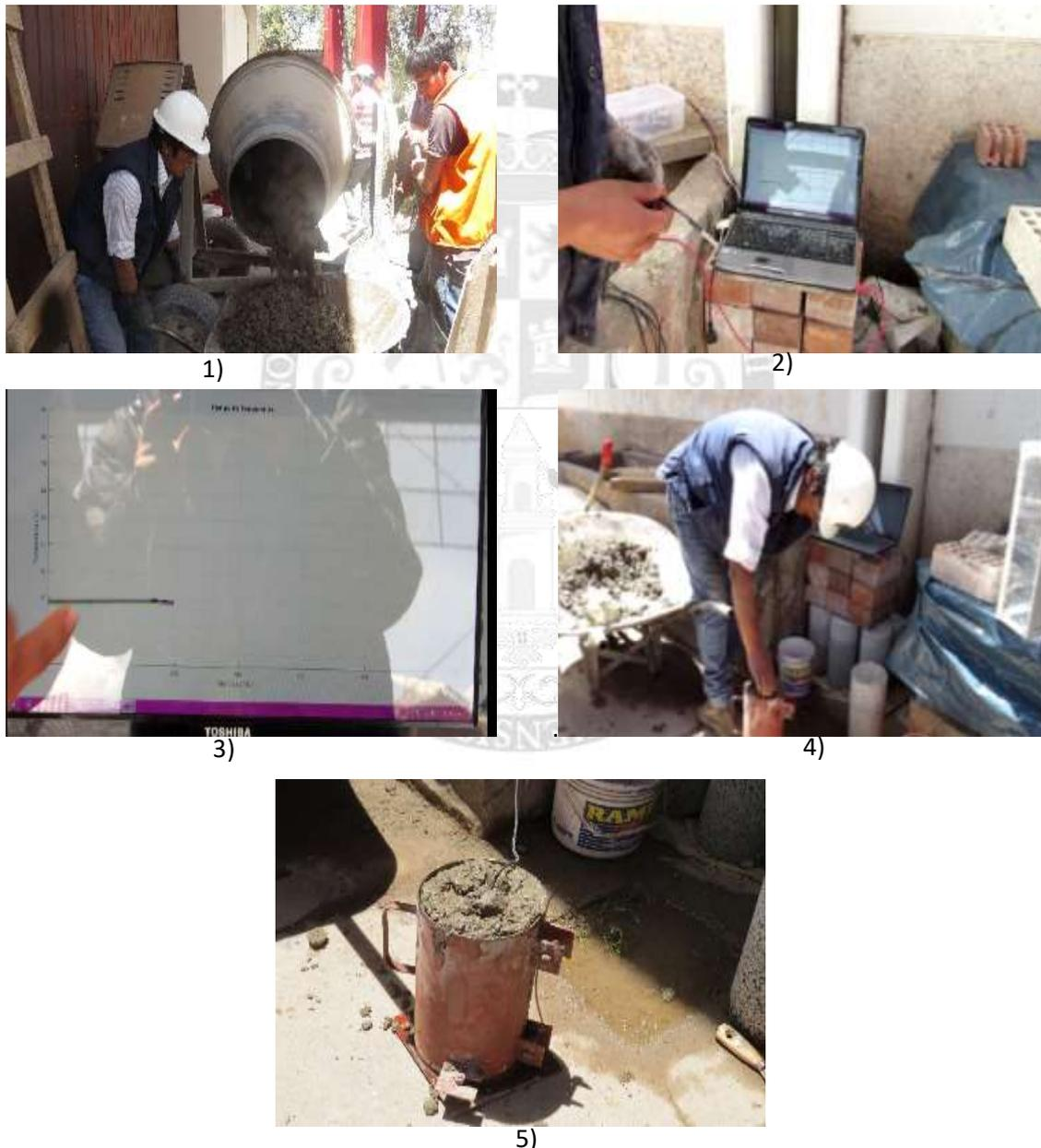
**Figura 7.3** Temperatura del concreto en estado fresco. 1) Muestra del concreto, 2) Verificación de registro de datos de temperatura del concreto, 3) lectura de temperatura promedio para un minuto, 4) toma de datos del espécimen de concreto y 5) control de la temperatura del concreto para espécimen de concreto
