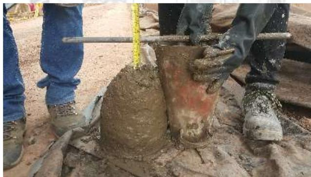
**Figura 8.5** Asentamiento del concreto en estado fresco
