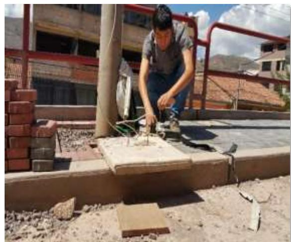
Figura 12 Extracción de registro de temperatura de los equipos de madurez. Luego del periodo de estudio
