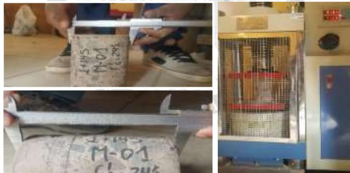
**Figura 8.19** Ensayo Compresión Simple en núcleos de concreto
