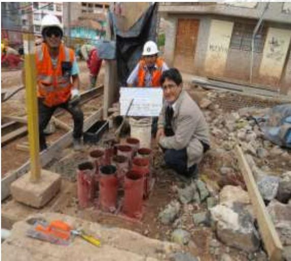
Figura 9 Elaboración de Briquetas y vigas de concreto en obra
