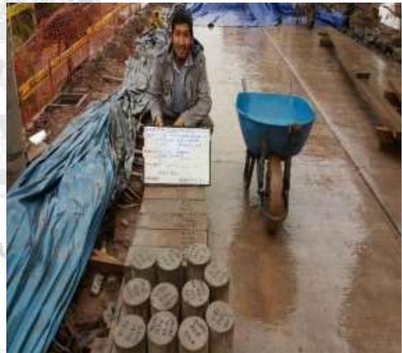
Figura 10 Vigas y briquetas de concreto curadas en obra
