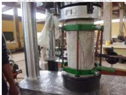
**Figura 7.16** Después de ensayo de Compresion Simple.
