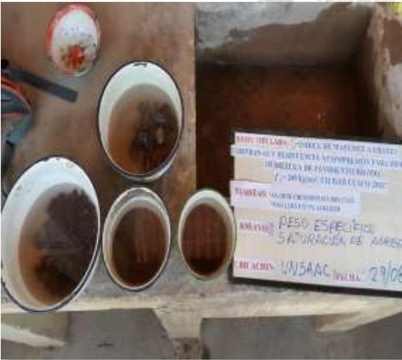
Figura 9 Saturación de agregados para ensayo de pesos específicos y absorción
