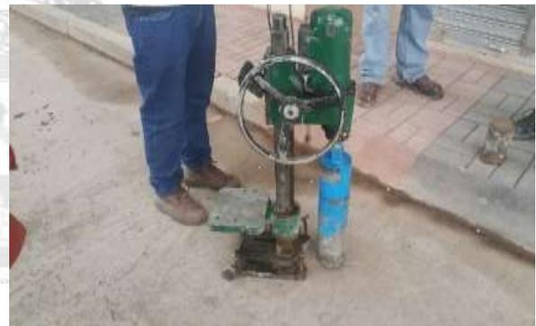
**Figura 8.18** Ensayo de extracción de Núcleos de Concreto del pavimento.
