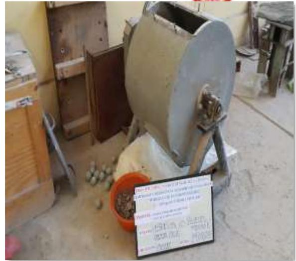
Figura 14 Ensayo de abrasión de los ángeles
