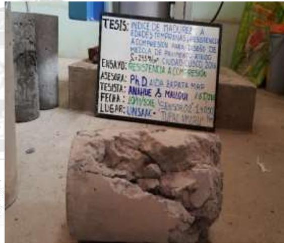
Figura 16 cilindros curados en campo sujeta a esfuerzo de compresión
