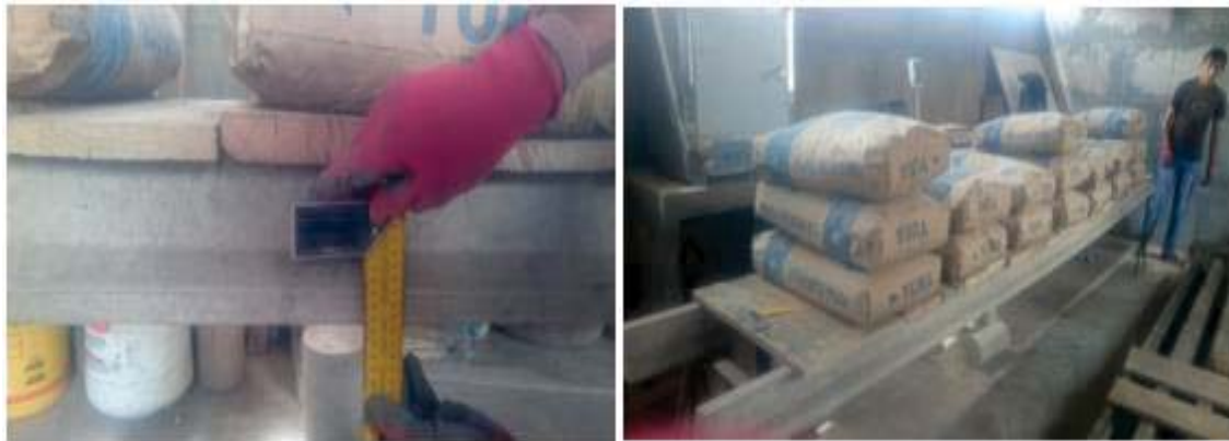
Figura 83. Deflexión de las viguetas pre esforzadas.
