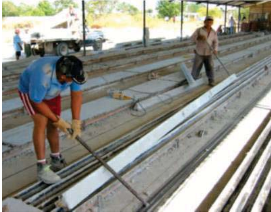
Figura 21. Descimbrado de las viguetas. (De-Acero, 2010)
