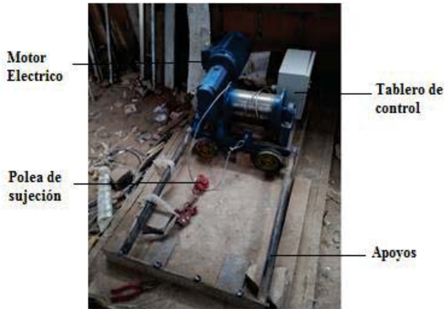
Figura 44. Maquina artesanal para pretensar acero.
