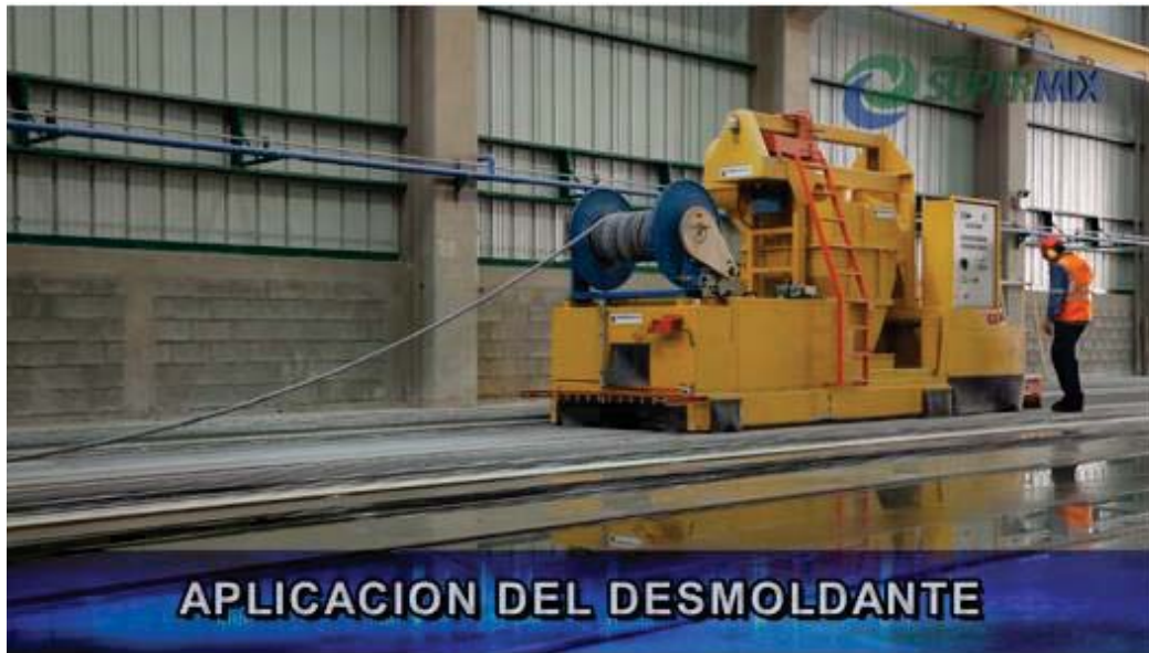
Figura 24. Aplicación del aditivo desmoldante.
