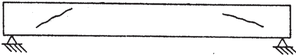
Figura 8. Grietas por cortante en el alma
