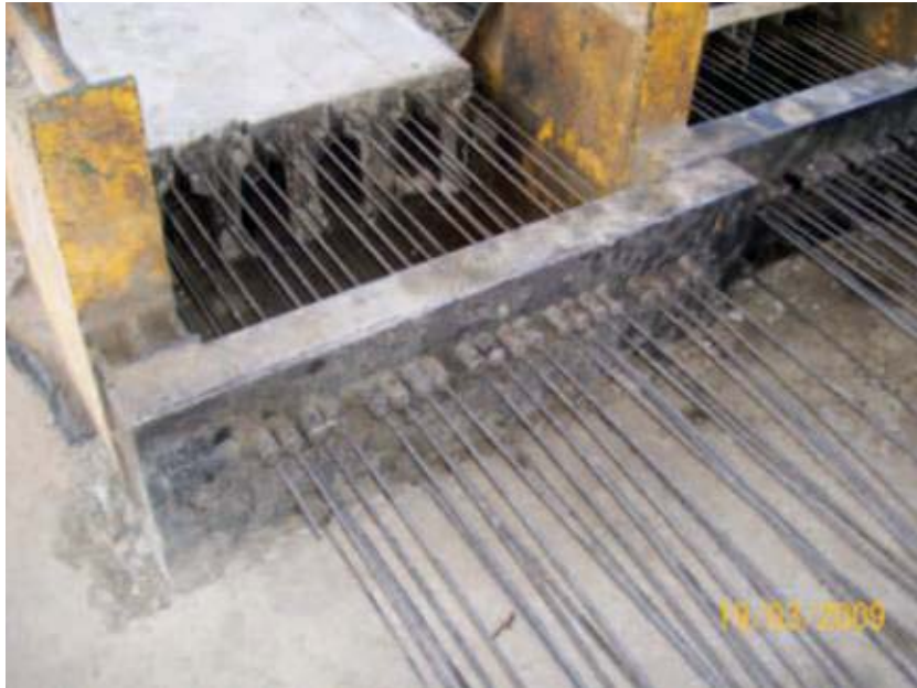
Figura 13. Anclajes del alambre mediante cuñas. (De-Acero, 2010)
