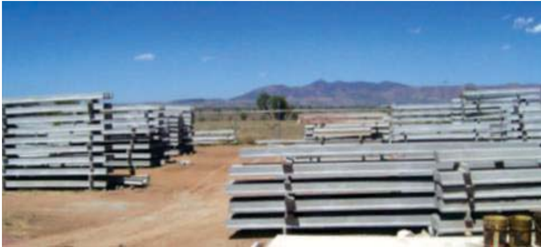
Figura 22. Almacenado de las viguetas pre esforzadas. (De-Acero, 2010)
