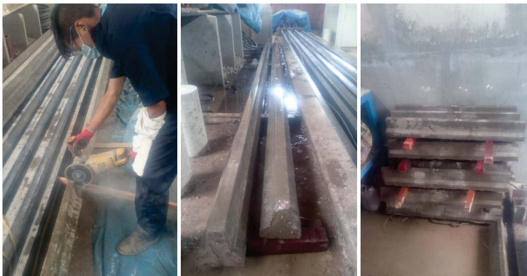
Figura 72. Corte y almacenamiento de viguetas pre esforzadas.
