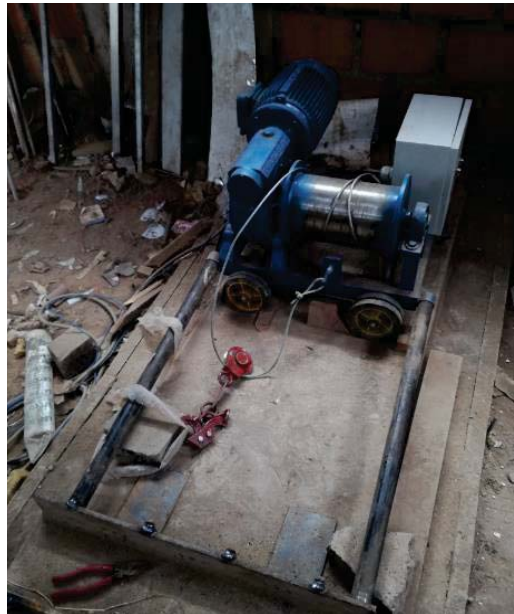
Figura 64. Máquina artesanal para pre esforzar.
