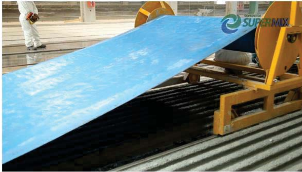
Figura 28. Colocación de una fibra de polipropileno para el curado a vapor correspondiente.
