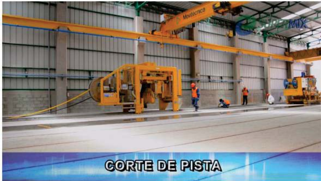
Figura 30. Corte de las viguetas pre esforzadas.
