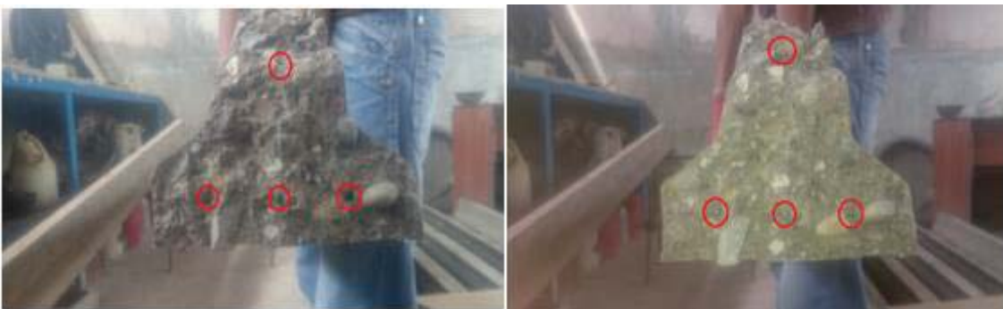
Figura 87. Falla del acero en las viguetas pre esforzadas.
