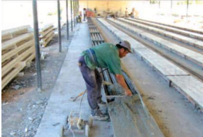
Figura 17. Vibrado del concreto de la vigueta pre esforzada. (De-Acero, 2010)
