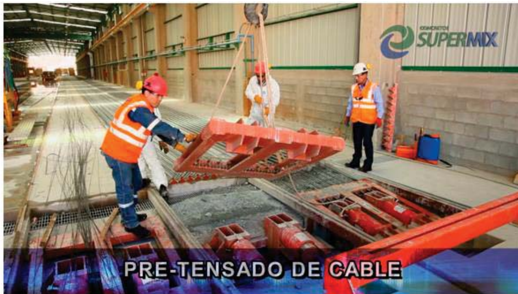
Figura 26. Pre tensado mediante las gatas hidráulicas.
