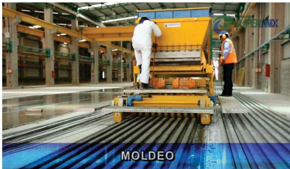
Figura 27. Vaciado del concreto sobre la pista, mediante una máquina extrusora.
