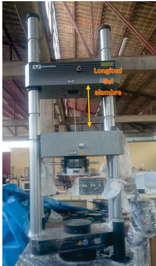
Figura 35. Ensayo a tracción de los alambres de alta resistencia.
