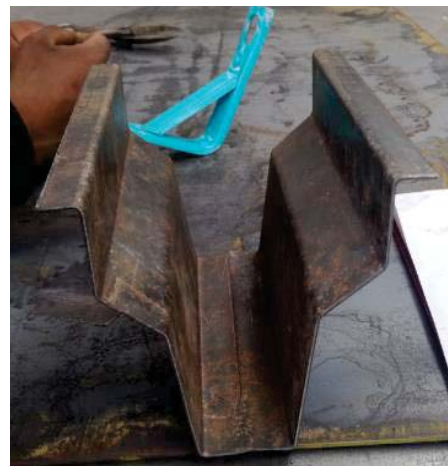
Figura 38. Molde de la sección de la viga pre esforzada.
