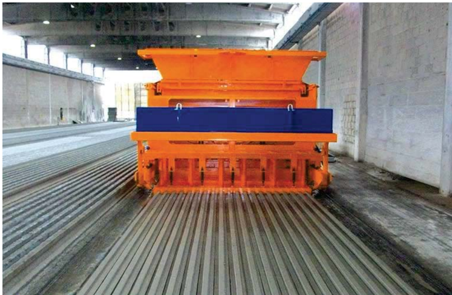
Figura 37. Maquina extrusora Tensyland
