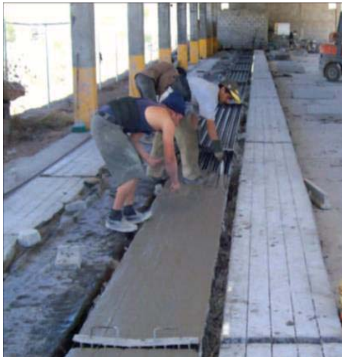
Figura 18. Proceso de acabado de la vigueta pre esforzada. (De-Acero, 2010)
