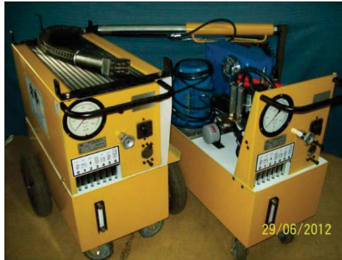
Figura 43. Máquina VITUS BRAIG para para pretensar acero (Braig, s.f.)
