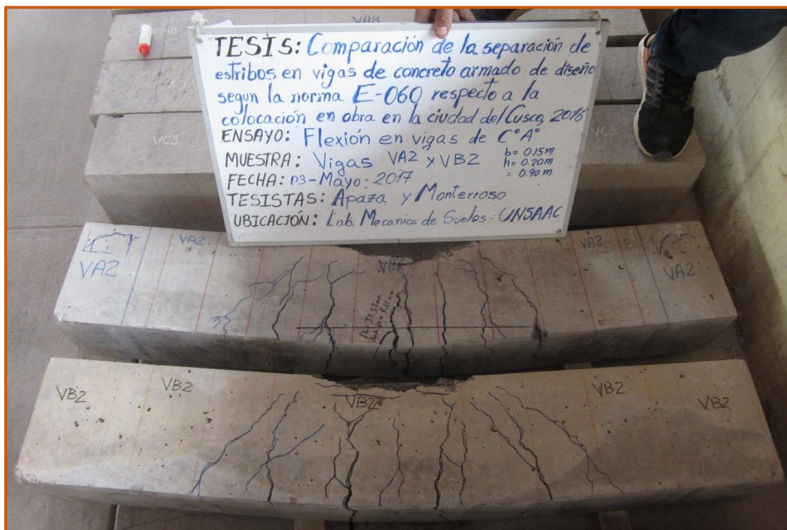
Figura 152 Comparación gráfica de fisuras de vigas V-A2 y V-B2
