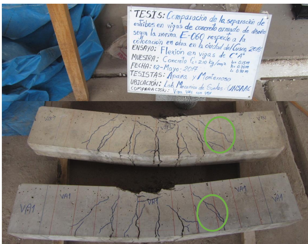
Figura 149 Comparación fotográfica de fisuras de vigas V-A1 y V-B1.
