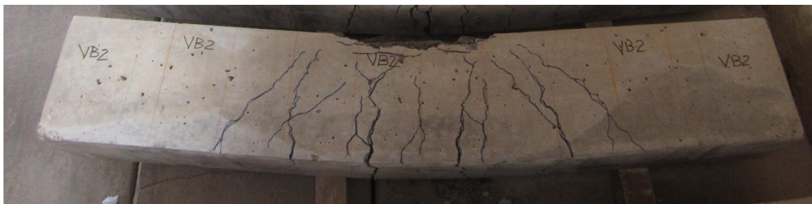
Figura 111. Aspecto de viga V-B2 concluido el ensayo
