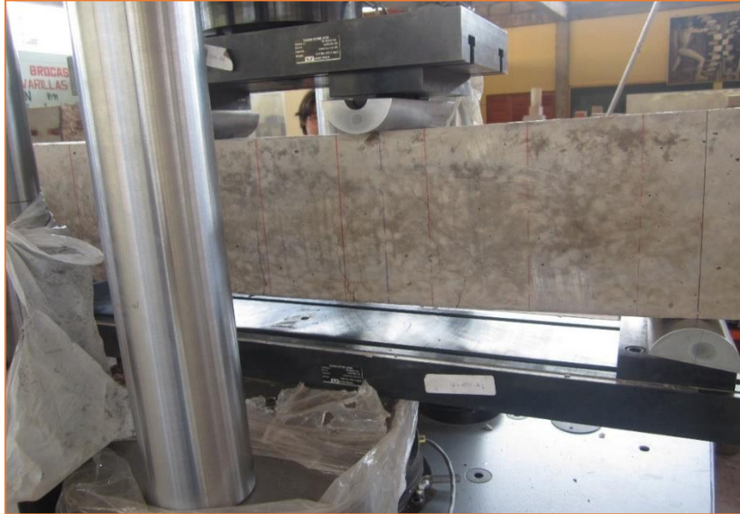
Figura 51. Momento de agrietamiento de la viga V-A
