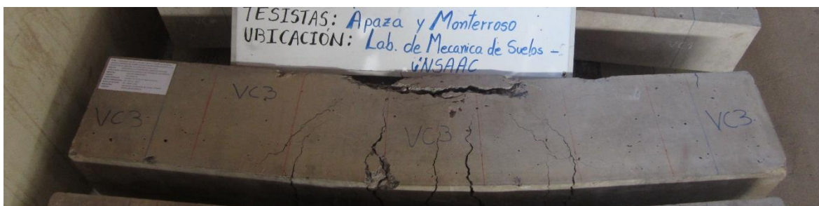
Figura 123. Aspecto de viga V-C3 concluido el ensayo
