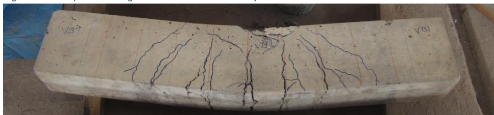
Figura 109. Aspecto de viga V-B1 concluido el ensayo
