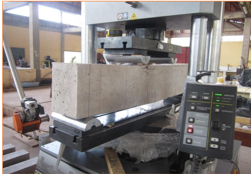
Figura 60. Efectos de la aplicación de carga a la viga V-D
