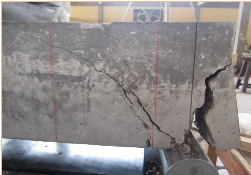
Figura 58. Aspecto final de la viga V-C
