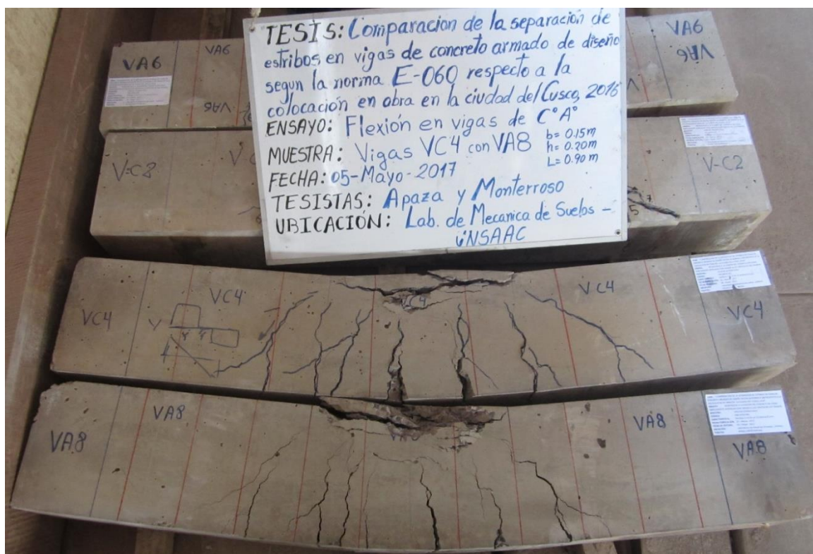
Figura 170. Comparación gráfica de fisuras de vigas V-A8 y V-C4
