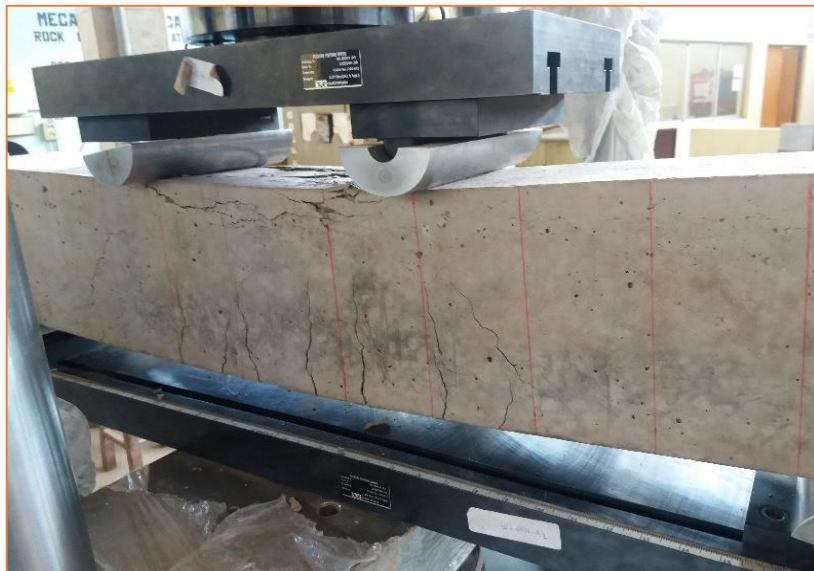
Figura 47. Aspecto final del ensayo de la viga V-E
