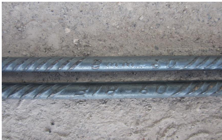
Figura 63. Barras y diámetros de acero corrugado empleados en las armaduras de las vigas.
