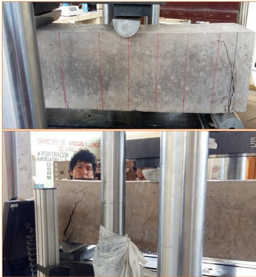
Figura 49. Aspecto en la viga en el proceso de ensayo de la viga de prueba V-F
