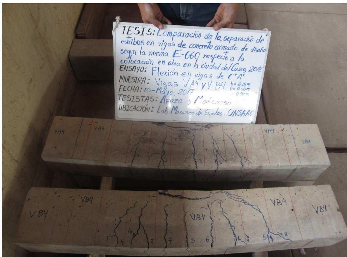
Figura 158. Comparación gráfica de fisuras de vigas V-A4 y V-B4
