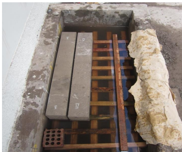
Figura 74 Curado de vigas y probetas cilíndricas de concreto
