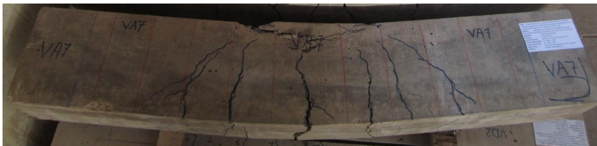
Figura 103. Aspecto de viga V-A7 concluido el ensayo
