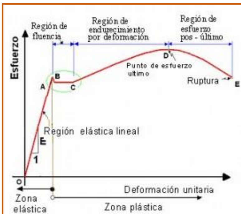
Figura 2. Diagrama de Esfuerzo Deformación del Acero
