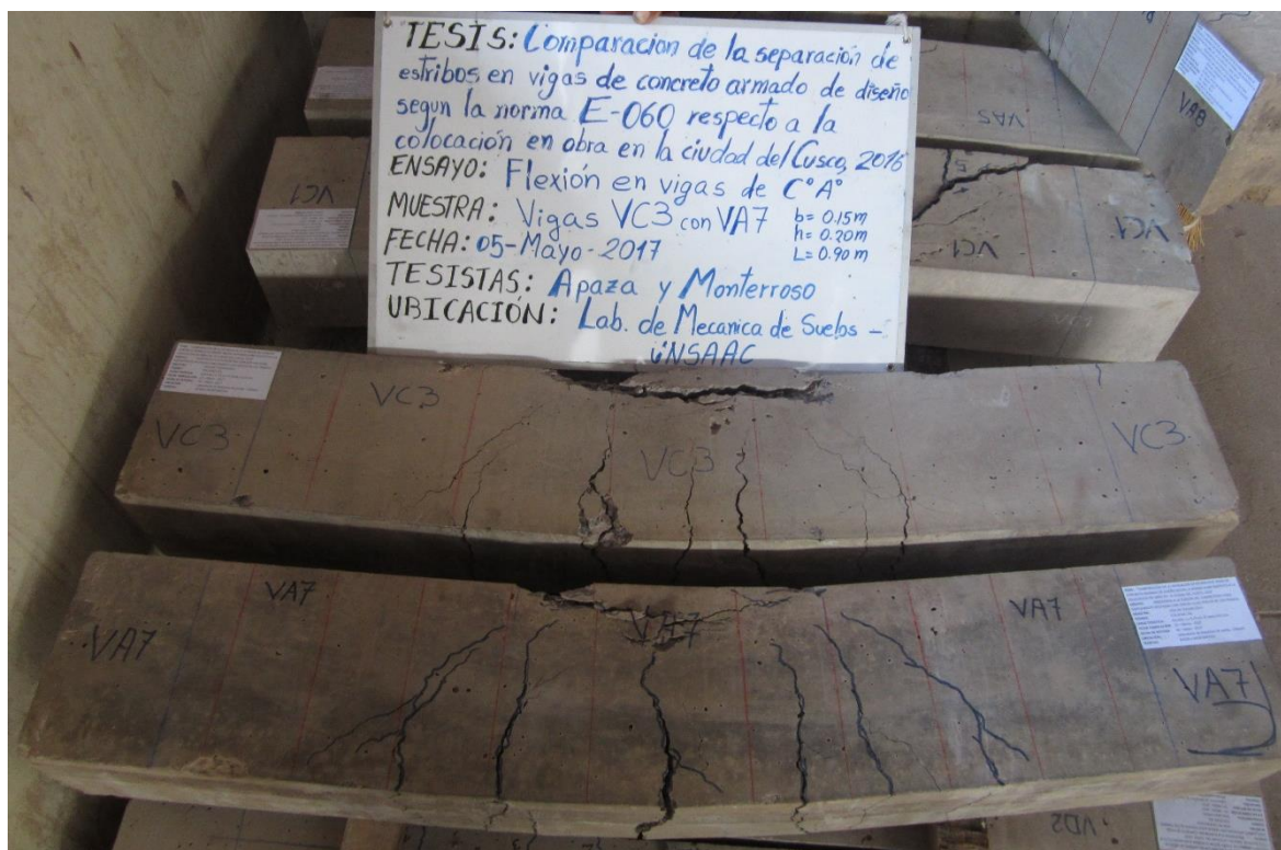
Figura 167 Comparación gráfica de fisuras de vigas V-A7 y V-C3
