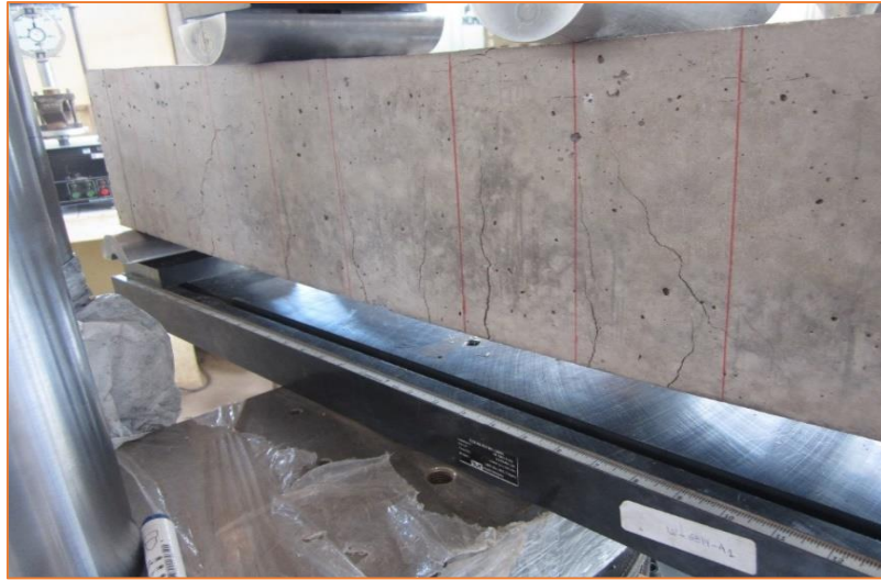
Figura 46. Ensayo de flexión en la Maquina Universal de la viga V-E
