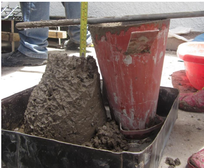
Figura 72. Ensayo de consistencia del concreto mediante el cono de Abrams.
