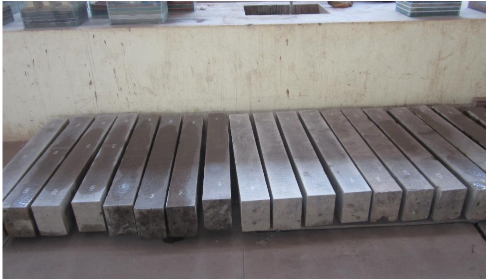
Figura 75. Vigas de Concreto Armado después de Curado.
