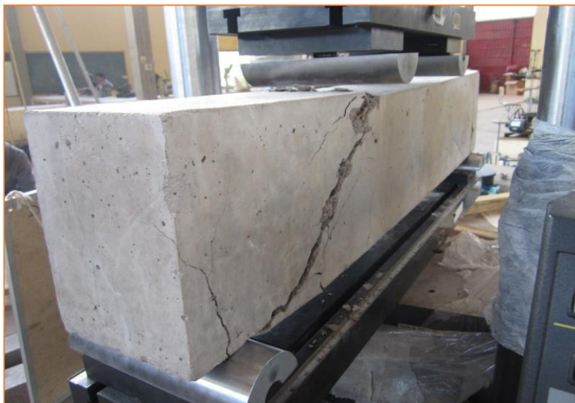
Figura 55. Aspecto final de la viga V-B
