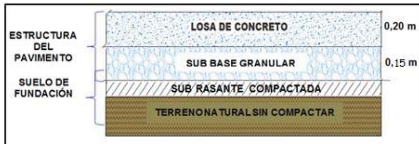
IMAGEN N°1.3 ESTRUCTURA DEL PAVIMENTO
