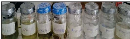
Fijación de las muestras con FAA. Deshidratación con alcoholes de 70, 90 96 %. Clarificación (Benceno + alcohol)
