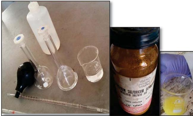
Preparación de sulfato de mercurio (II) para obtener concentraciones de 0.1, 0.5, 1.0, 2.0 y 5.0 ppm de mercurio (II).
