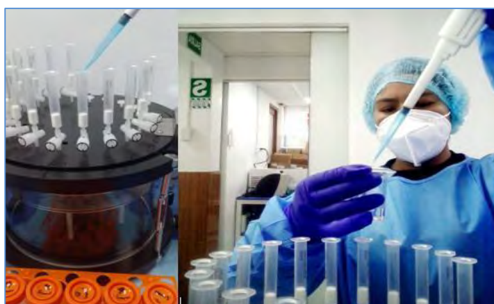
Figura 5.7 Extracción de la parte superficial de la muestra y adición de la solución 3(ACN/H 2 O).
