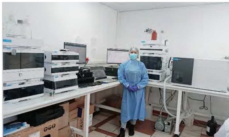
Figura 5.10 Procesamiento de muestras en el equipo de HPLC-MS/MS en el laboratorio de Farmacología Veterinaria - UNSAAC.
