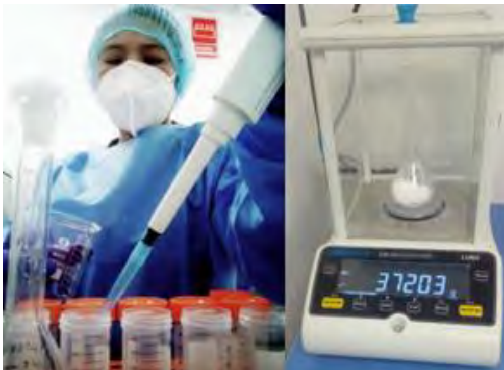
Figura 5.2 Adición de solución EDTA más cerámica de homogeneización.
