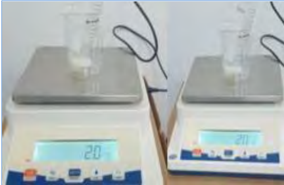
Figura 5.2 Adición de solución EDTA más cerámica de homogeneización.
