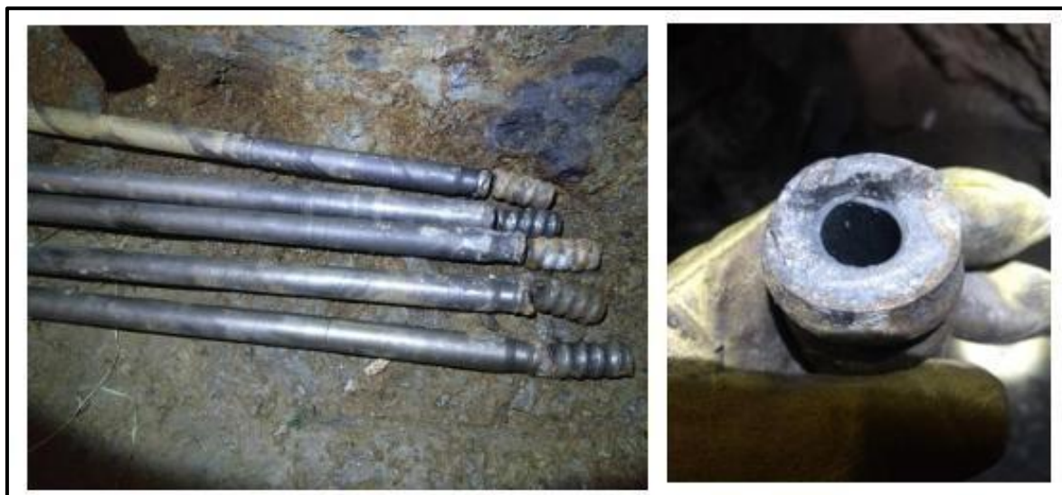
FIGURA 6: ROTURA DE ROSCA DE 5 BARRAS
