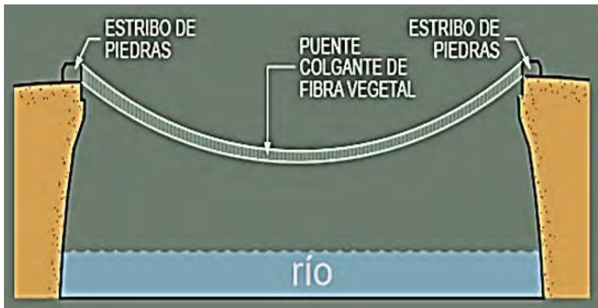
Figura 86. Representación gráfica de un puente de dos estribos.
