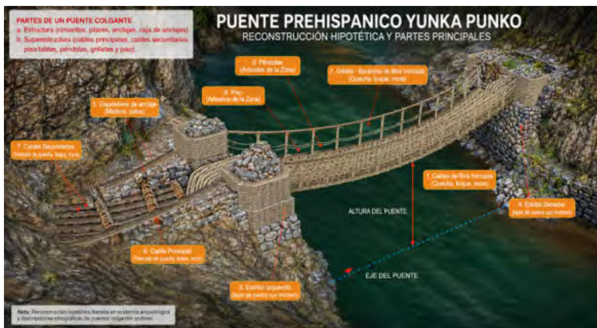
Figura 98. Reconstrucción hipotética y partes principales de un puente colgante basada en la evidencia arqueológica y etnoarqueológica recogida en campo.
