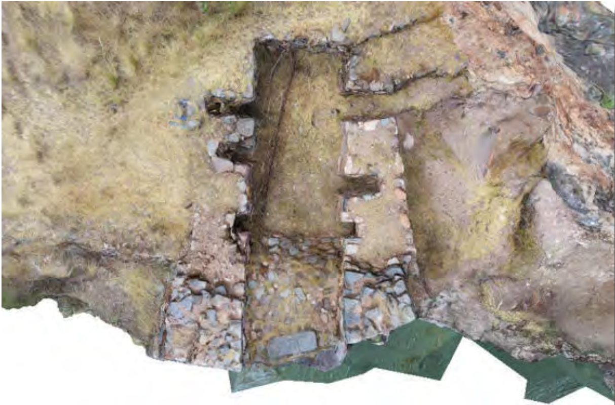
Figura 75. Estribo izquierdo reconstruido mediante fotogrametría aérea.
