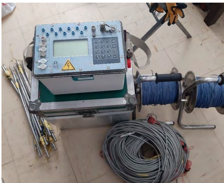
Figura 23: Resistivímetro Syscal Pro, de 10 canales
