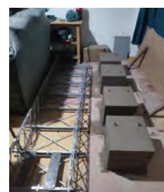
Montaje del puente sobre los apoyos
