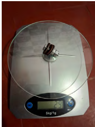
Masa de desbalance empleada en los ensayos
