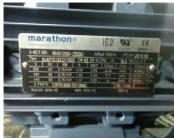
Placa de características del motor
