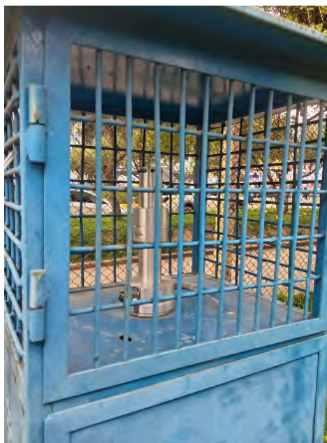
Figura 2.24 Ubicación del Impactador Harvard en la estación de medición.
