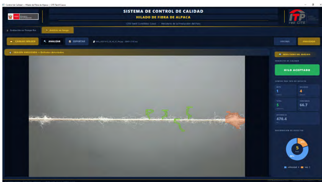
Figura 26 Interfaz de pruebas procesando una muestra óptima.
