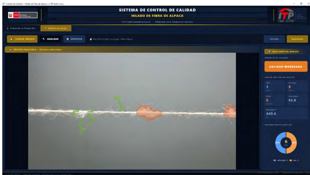
Figura 27 Interfaz de pruebas identificando una densidad intermedia de defectos.
