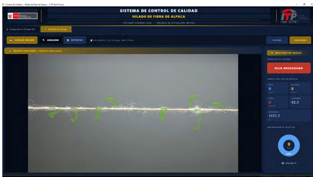
Figura 28 Interfaz de pruebas detectando una alta concentración de imperfecciones.
