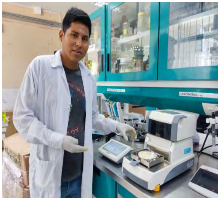
Fotografía 26. Pesado de maíz molido en el equipo de laboratorio (ANALIZADOR DE HUMEDAD INTELIGENTE AUTOMÁTICO DW-MS)
