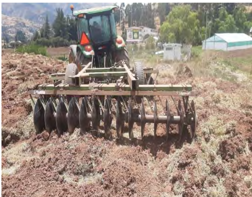
Fotografía 3. Rastrado del suelo con arado de disco
