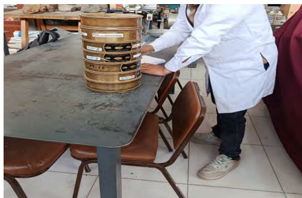
Foto 4. Tamizaje de mineral luego de molienda.
