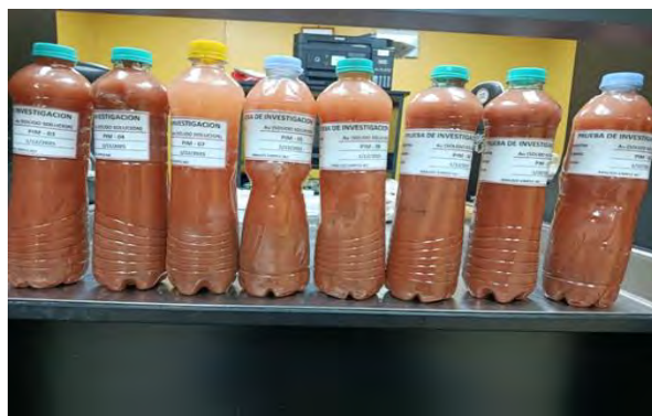
Foto 8. Muestras de pulpa final de la lixiviación en botellas.
