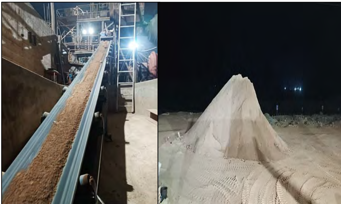
Foto 2. Faja de alimentación al molino primario, ruma de mineral aurífero oxidado
