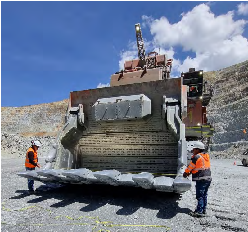
Revision de componente del sistema Ore Sorting (Shovelsense)
