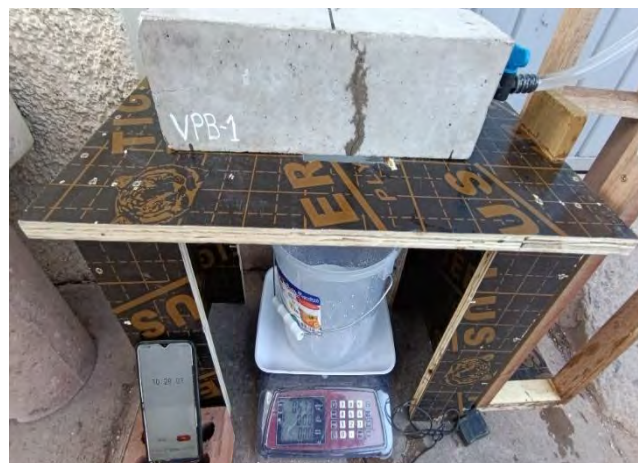
Prueba de permeabilidad y registro de datos de prismas de concreto de 10x10x34cm
