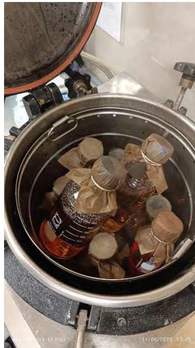
Preparación de medio de cultivo líquido (Caldo BHI) y esterilización del medio de cultivo en autoclave
