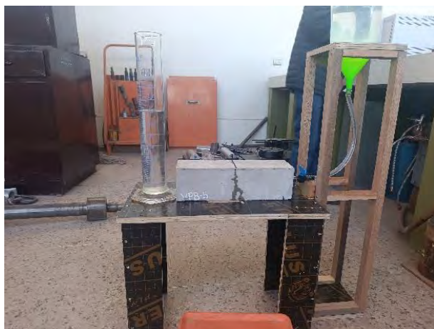
Prueba de permeabilidad y registro de datos de prismas de concreto de 10x10x34cm
