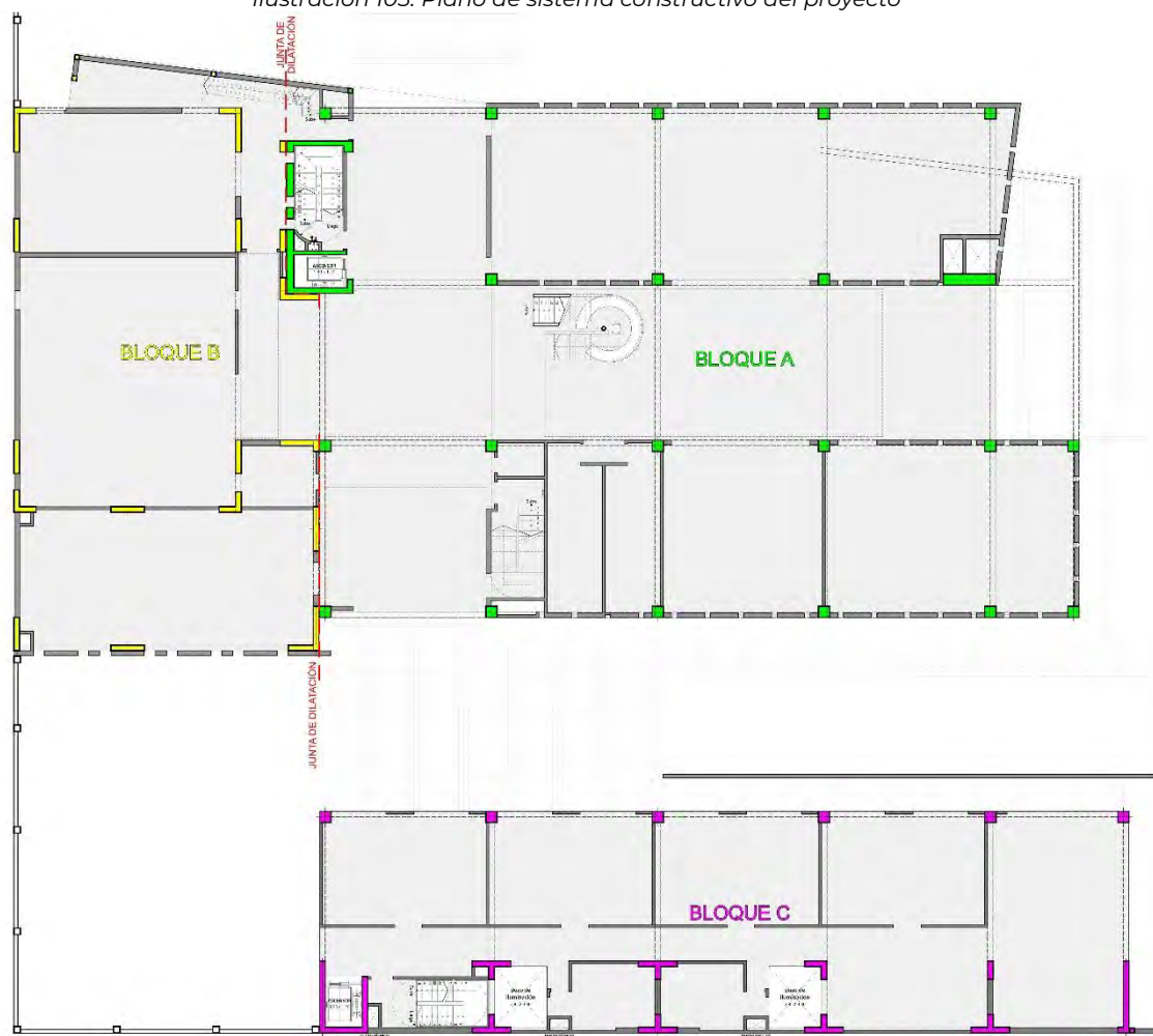
Ilustración 103: Plano de sistema constructivo del proyecto
