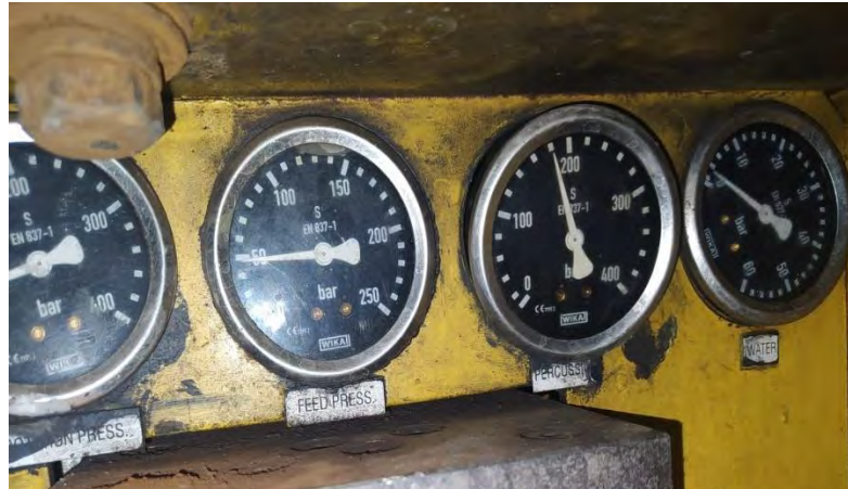
Figura 21: Manómetros de presión de perforación
