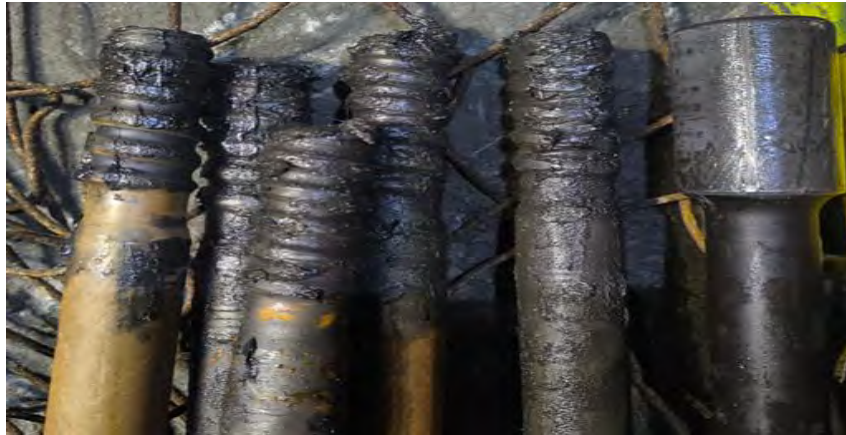
Figura 61: Evitando La Percusión Excesiva Para Soltar Las Juntas
