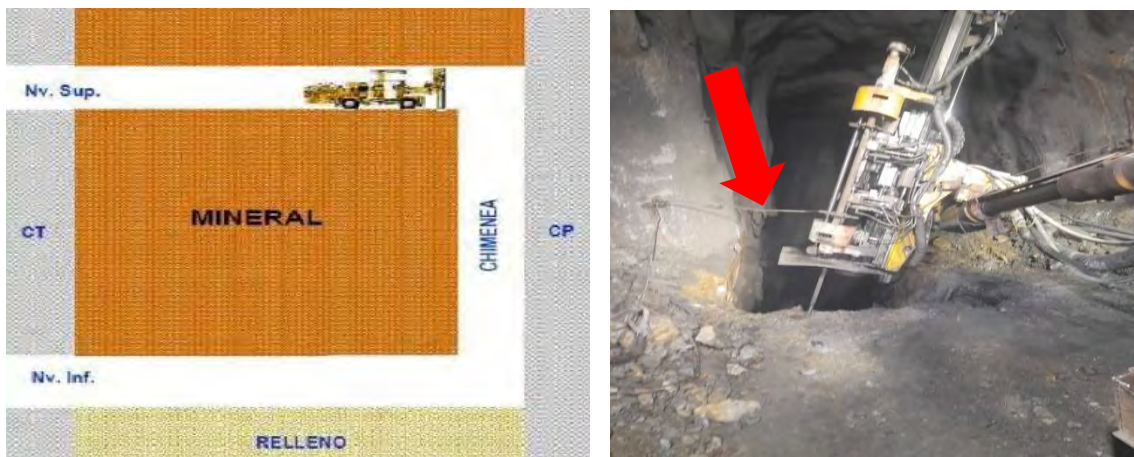
Figura 18: Elaboración de Chimeneas -slot
