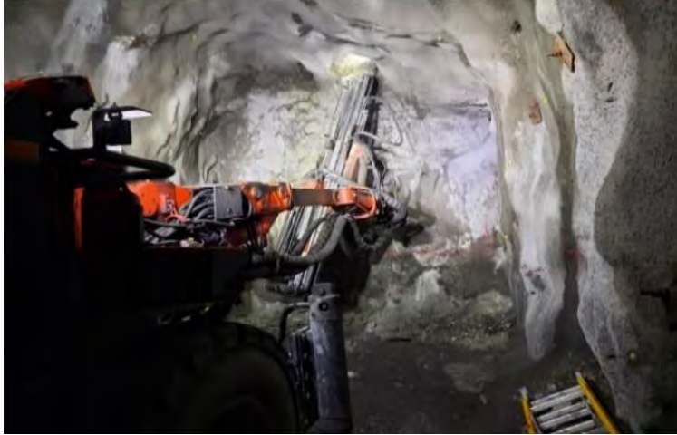
Figura 91: Pernos Helicoidales con Equipo Jumbo ,Gl 370 Nv19.
