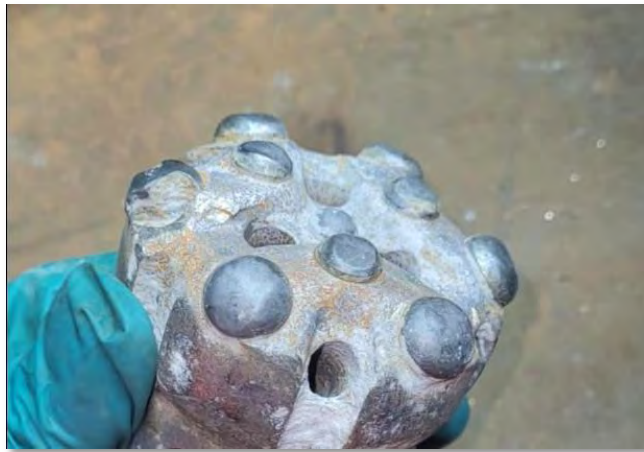
Figura 58: Broca No Rotada Adecuadamente (Sobre Perforada)
