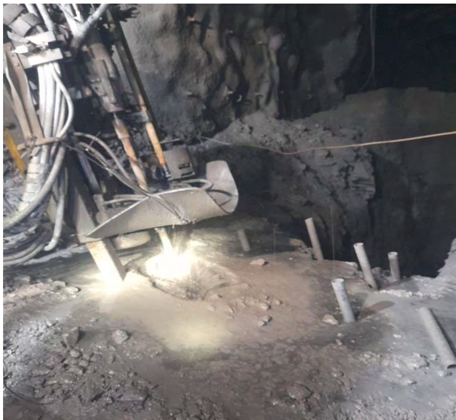
Figura 27: Referencial perforación sublevel stoping-
