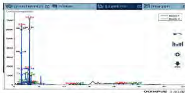
Ilustración 8: Espectrograma composicional de los elementos mayoritarios en la irradiación del objeto mediante la Fluorescencia de rayos X
