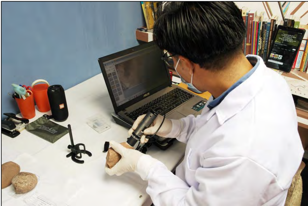
Foto N° 4. Toma de imágenes mediante el empleo de un microscopio dino-Lite Edge, serie AF4115ZT
