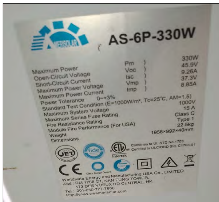
Figura 21. Características técnicas del panel AS-6P
