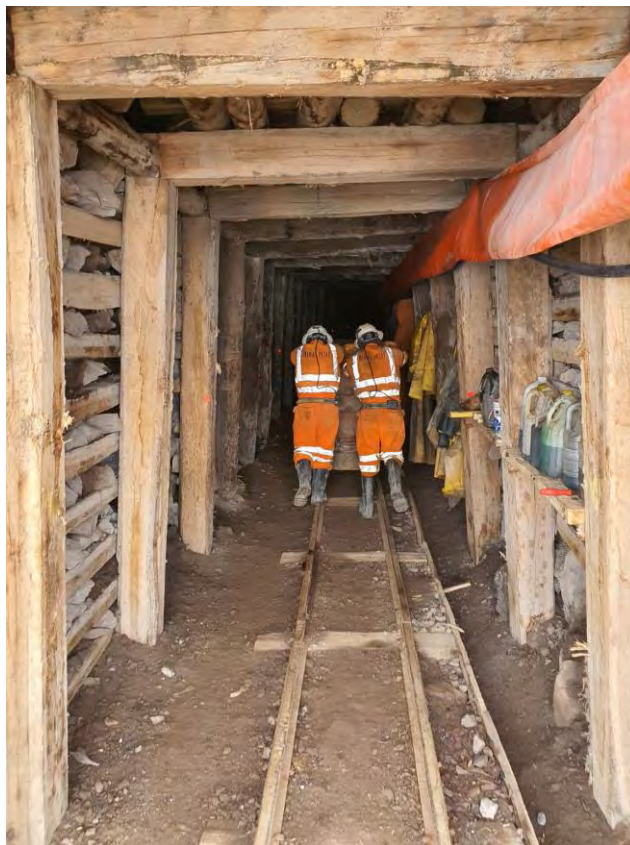
Imagen 28: Traslado de mineral sobre carros mineros U-35.
