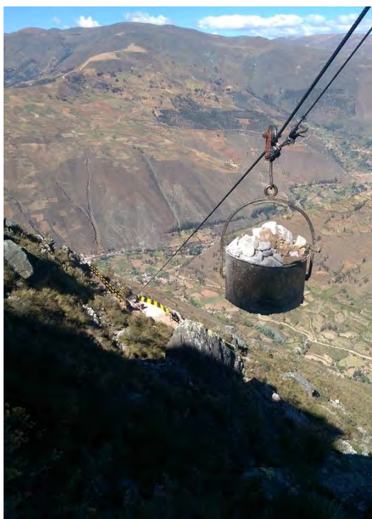
Imagen 17: Sistema de wincheo en superficie
