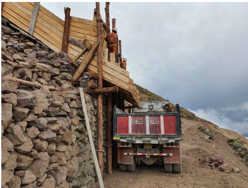
Imagen 26: Carguío de mineral al volquete en la tolva San Lorenzo.
