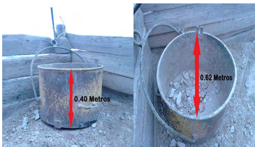
Imagen 16: Balde metálico utilizado para el wincheo
