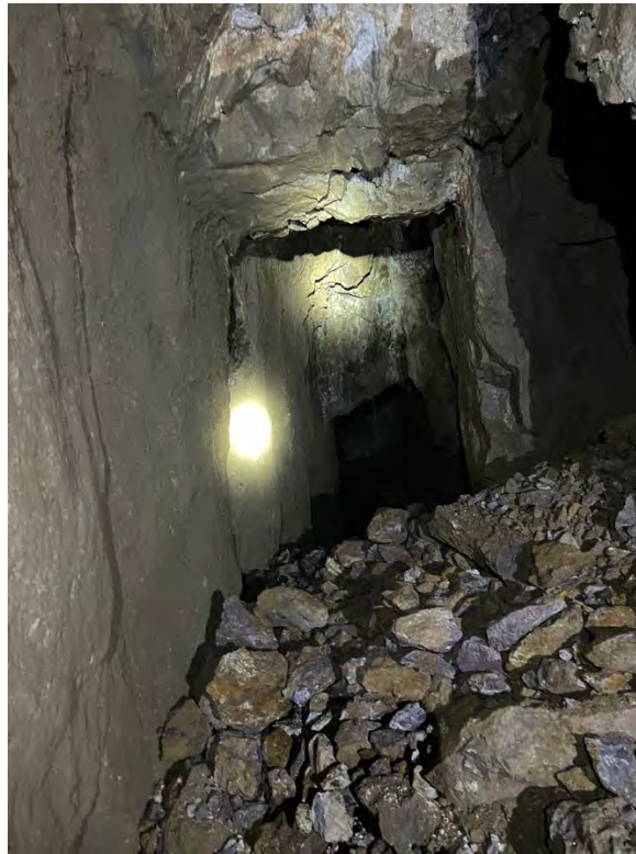
Imagen 23: Tajo con método de corte y relleno.
