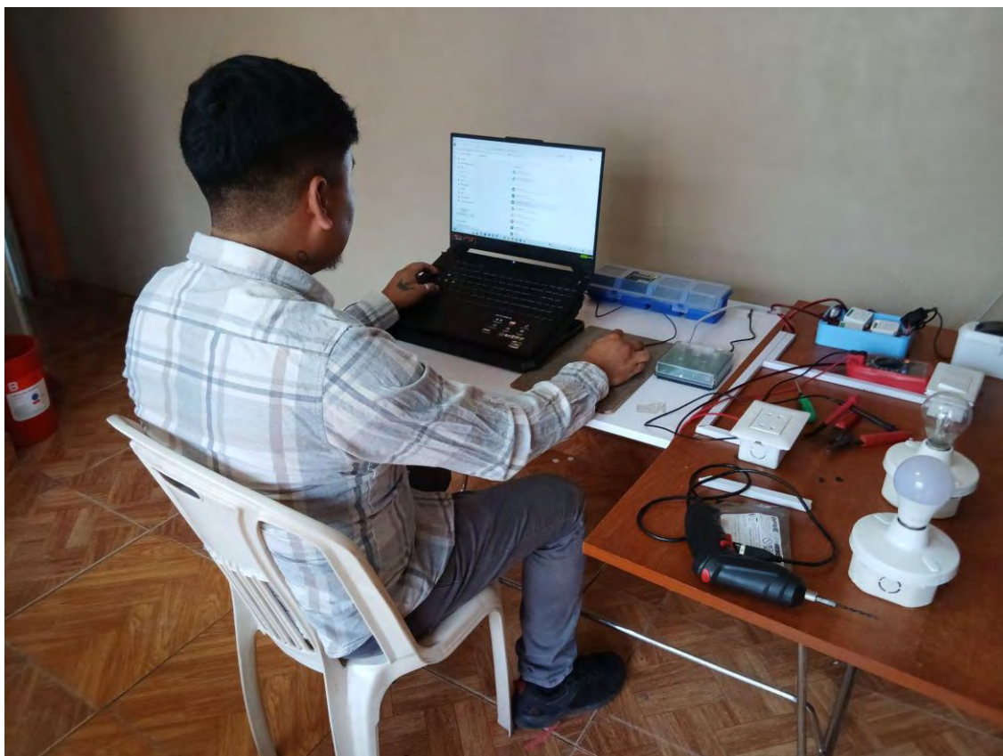
Anexo 21: Proceso de configuración del medidor inteligente y del concentrador a pequeña escala
