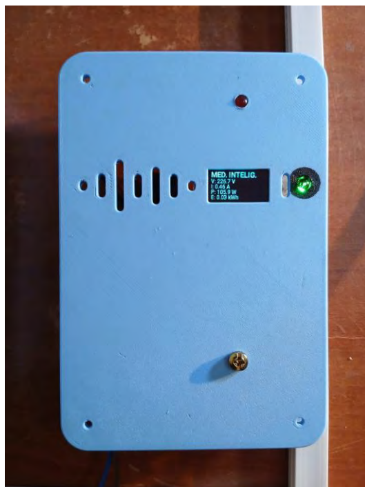
Anexo 03: Tercera etapa del medidor: Pantalla OLED, LED pulsador y LED de calidad
