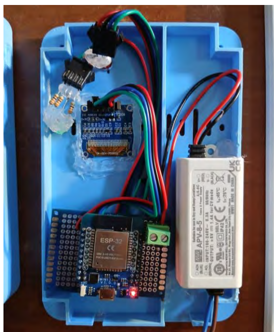
Anexo 02: Segunda etapa del medidor: Microcontrolador, cableado y adaptador
