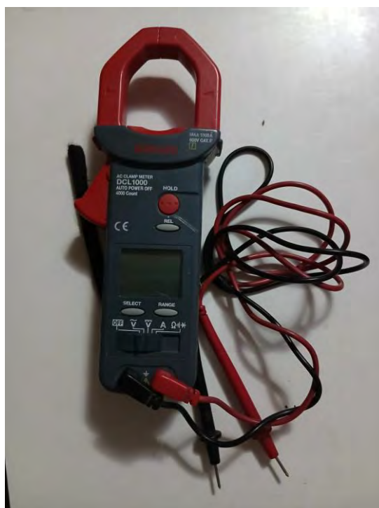
Anexo 14: Pinza amperimétrica empleada para medir magnitudes y validación
