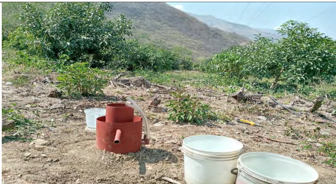
Fotografía 43. Medición de infiltración de agua al suelo en la parcela de investigación
