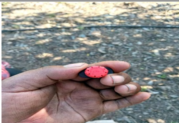
Fotografía 21.- gotero de estudio autocompensado de 0-70 L/h
