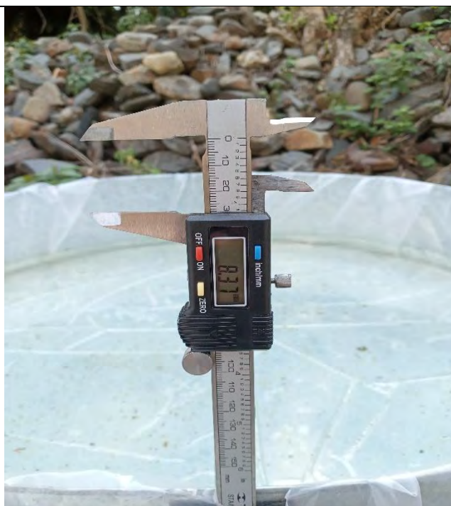
Fotografía 38. Lectura de tanque evaporímetro clase A con 8.37mm que evaporo en el día
