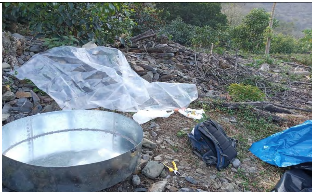
Fotografía 35. Instalación de tanque evaporímetro clase A. servirá para indicar ETo (evapotranspiración en mm), dato de apoyo en el manejo del buen riego
