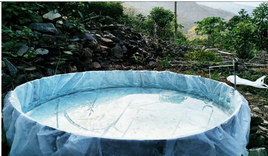
Fotografía 37. Tanque evaporímetro clase A, en parcela de investigación
