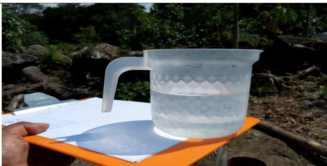
Fotografía 46. Lectura de la infiltración, teniendo en este caso 380ml de agua infiltrada al suelo
