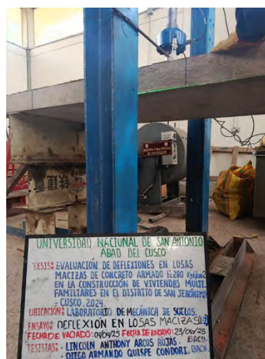
Figura 54: Toma de datos de las deflexiones inmediatas de la losa maciza LM-02
