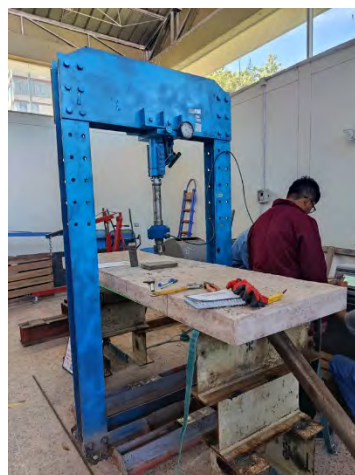
Figura 46: Instalación de la celda de carga, diales y caja colectora para el ensayo de losa LM-01
