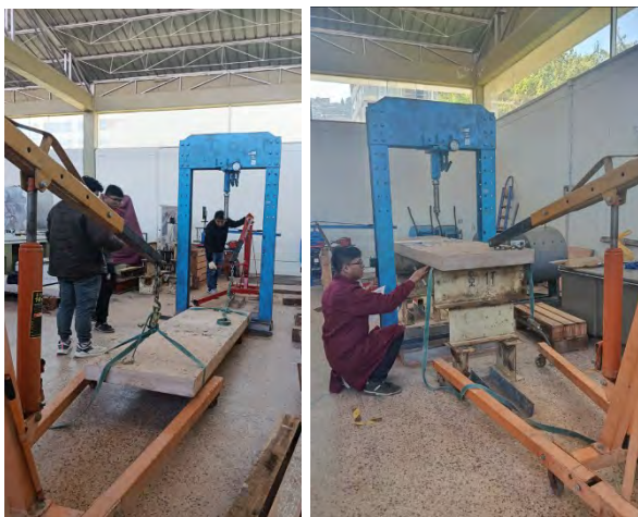
Figura 45: Izamiento de losa LM-01 para su ensayo
