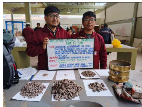
Figura 4: Ensayo de granulométrico del agregado grueso
