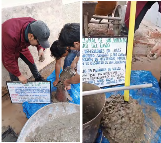
Figura 13: Prueba a la mezcla del concreto, prueba del SLUMP
