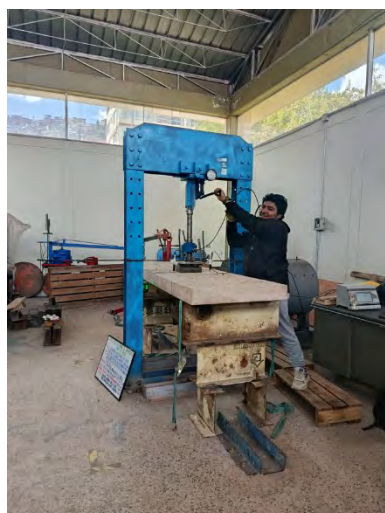
Figura 61: Ensayo a flexión de la losa maciza LM-03
