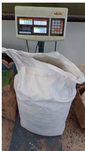
Figura 67: Registro del pesaje de sacos empleados como carga aplicada en la losa maciza.
