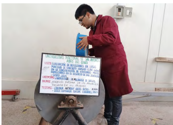
Figura 9: Ensayo de abrasión en máquina de los Ángeles
