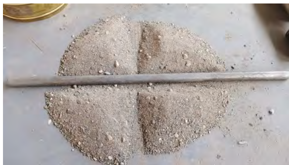
Figura 3: Cuarteo de material para ensayo de agregados
