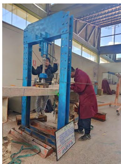
Figura 55: Ensayo a flexión de la losa maciza LM-02
