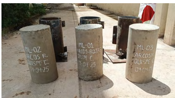
Figura 26: Briquetas de control del vaciado de la mezcla de concreto f'c 280 kgf/cm 2
