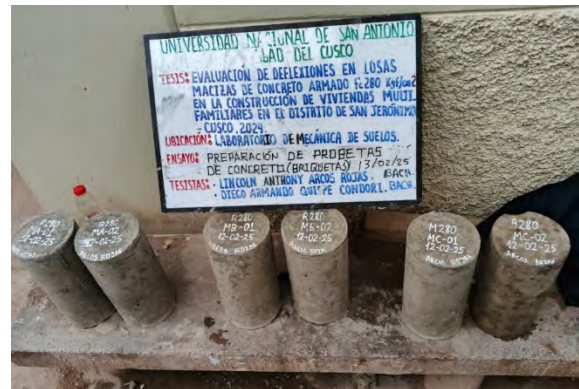
Figura 16: Briquetas de los especímenes de concreto f_c 280 \text{kgf/cm}^2
