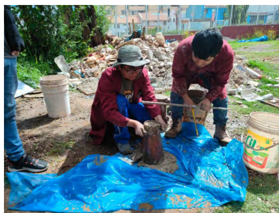
Figura 23: Prueba de SLUMP de la mezcla de concreto f'c 280 kgf/cm 2
