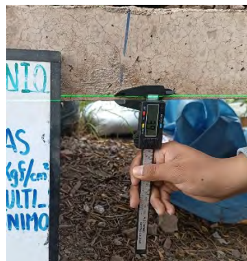
Figura 80: Medición con vernier_ CM+CV_Def. diferida (26/08/2025)-(04)
