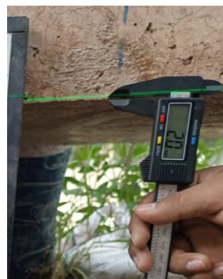
Figura 76: Medición con vernier_PP - Peso Propio_Def. inm. Desenc. (31/07/2025)-(02)
