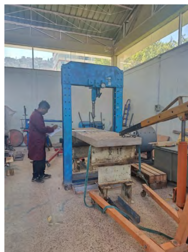
Figura 48: Toma de datos de las deflexiones inmediatas de la losa maciza LM-01
