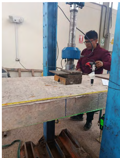
Figura 53: Instalación de la celda de carga, diales y caja colectora para el ensayo de losa LM-02
