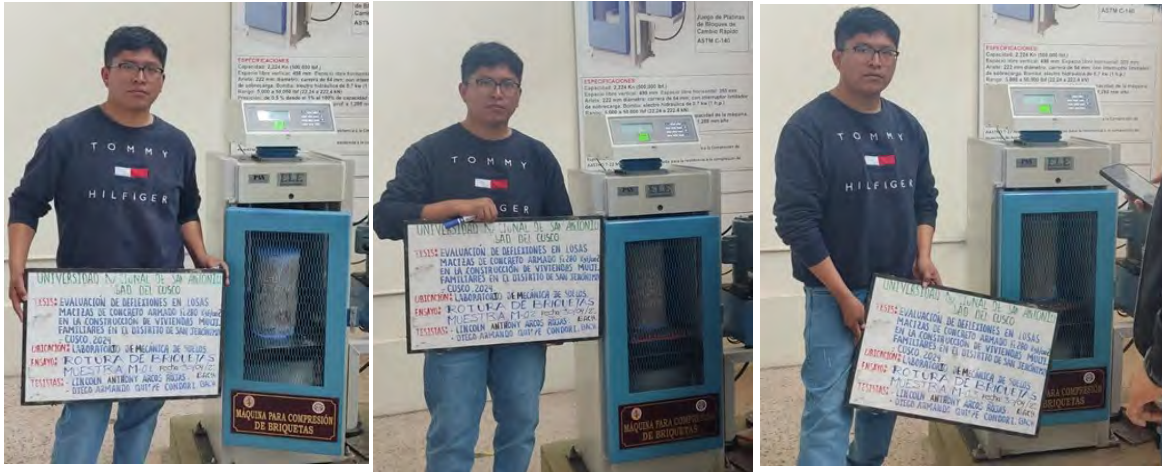
Figura 40: Rotura de briquetas de control del vaciado de la mezcla de concreto f'c 280 kgf/cm 2
