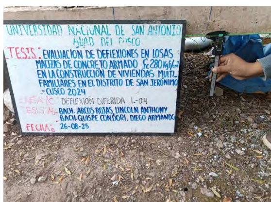
Figura 71: Medición de la deflexión diferida en la losa maciza L-04, día (26/08/2025)
