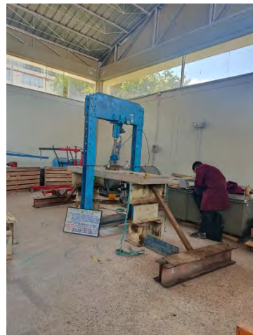
Figura 52: Instalación de la celda de carga, diales y caja colectora para el ensayo de losa LM-02
