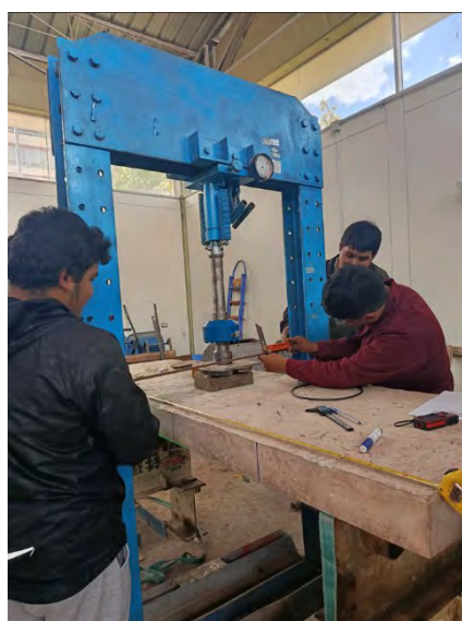
Figura 59: Instalación de la celda de carga, diales y caja colectora para el ensayo de losa LM-03
