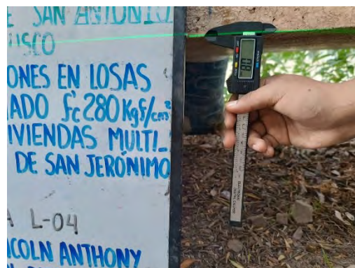
Figura 74: Medición con vernier_Início PP - Peso Propio_Def. inm. Desenc. (25/06/2025)-(01)
