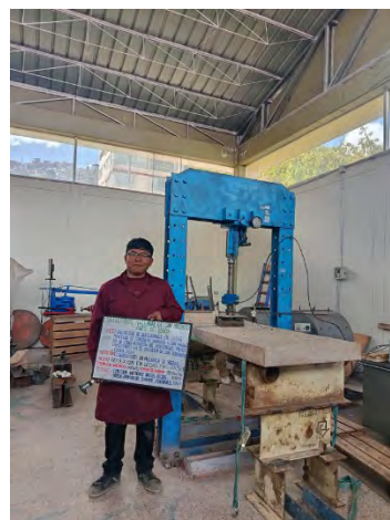
Figura 58: Instalación de la celda de carga, diales y caja colectora para el ensayo de losa LM-03
