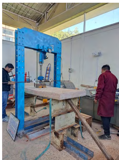
Figura 47: Instalación de la celda de carga, diales y caja colectora para el ensayo de losa LM-01
