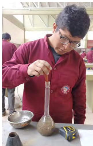
Figura 6: Determinación del Peso Específico de agregado fino
