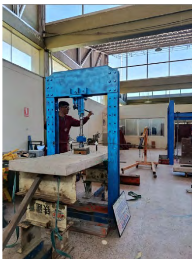
Figura 49: Ensayo a flexión de la losa maciza LM-01
