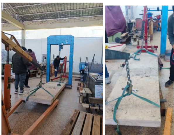
Figura 57: Izamiento de losa LM-03 para su ensayo
