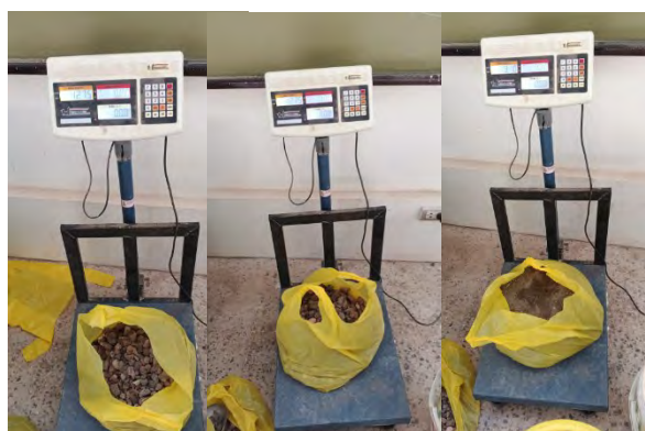
Figura 10: Peso de agregado grueso y fino para la elaboración de briquetas f'c 280 kg/cm 2
