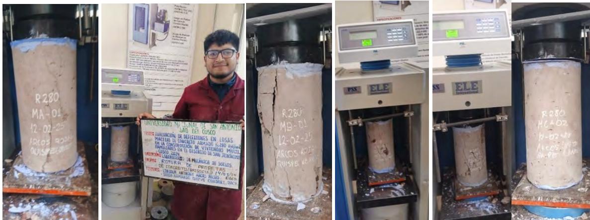
Figura 17: Ensayo de compresión de los especímenes de briquetas de concreto f_c 280 \text{kgf/cm}^2 : MA-01, MA-02, MB-01, MB-02, MC-01, MC-02 después de 28 días
