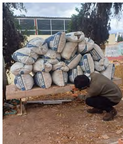
Figura 70: Medición de la deflexión diferida en la losa maciza L-04, día (26/08/2025)
