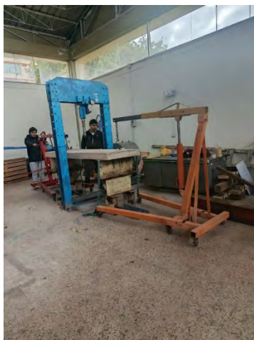
Figura 51: Izamiento de losa LM-02 para su ensayo
