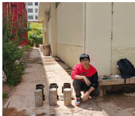
Figura 25: Desmoldamiento de briquetas de control del vaciado de la mezcla de concreto f'c 280 kgf/cm 2
