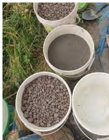
Figura 2: Acopio de agregado fino y grueso seleccionado para los ensayos de laboratorio (Canteras Vicho y Cunyac)
