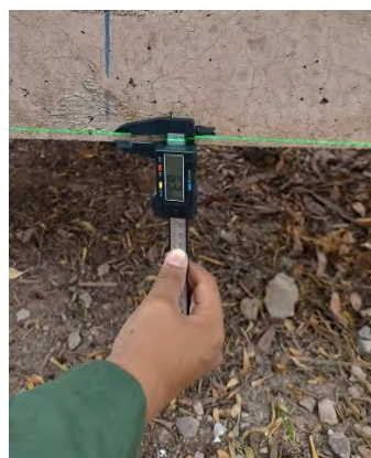
Figura 86: Medición con vernier_ CM+CV_Def. diferida (10/11/2025)-(07)
