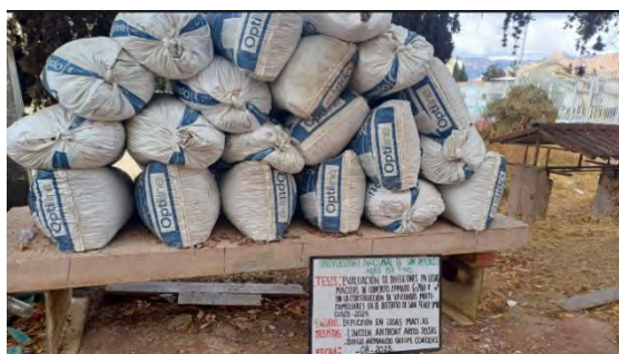
Figura 69: Disposición de sacos de 50 kg sobre la losa maciza, empleados en la evaluación de la deflexión diferida. (11/08/2025)
