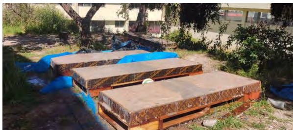
Figura 34: Curado de Losas LM-01, LM-02, LM-03, LM-04 día 20
