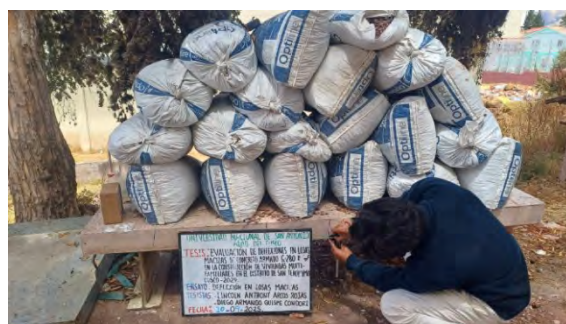
Figura 72: Medición de la deflexión diferida en la losa maciza L-04, día (10/09/2025)
