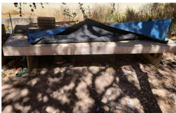
Figura 65: Toma de datos de las deflexiones diferidas de la losa maciza LM-04, día (02/07/25)
