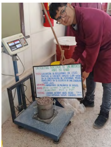
Figura 5: Ensayo de Peso unitario y vacíos de agregados PUS y PUC
