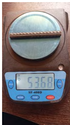
Fotografía 33. Peso de acero para el inicio de su corrosión
