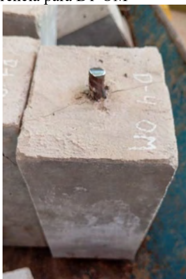
Fotografía 55. Efecto del ensayo de adherencia para D4-OM
