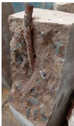
Fotografía 47. Efecto del ensayo de adherencia para D1-SO
