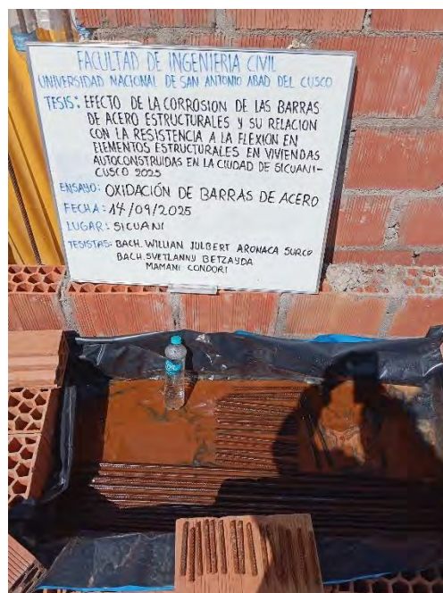
Fotografía 36. Corrosión del acero, día 14
