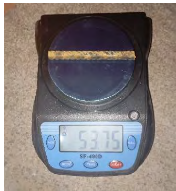
Fotografía 34. Peso del acero al primer día de exposición a la corrosión
