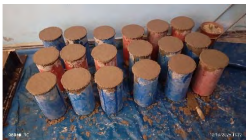
Fotografía 29. Elaboración de briquetas de concreto para análisis de resistencia a la compresión
