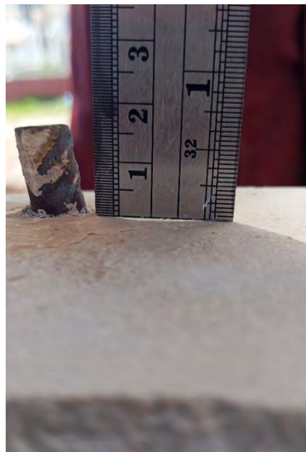
Fotografía 46. Medición de la deformación del acero después del ensayo de adherencia
