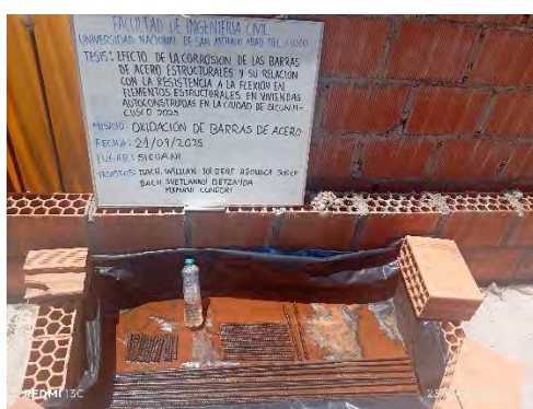
Fotografía 37. Corrosión del acero, día 21
