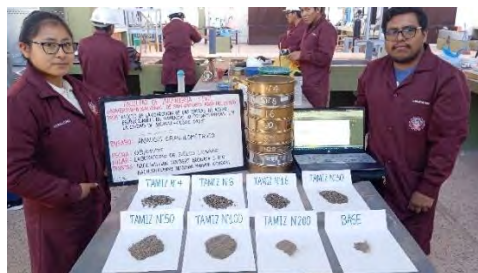
Fotografía 2. Granulometría del agregado fino
