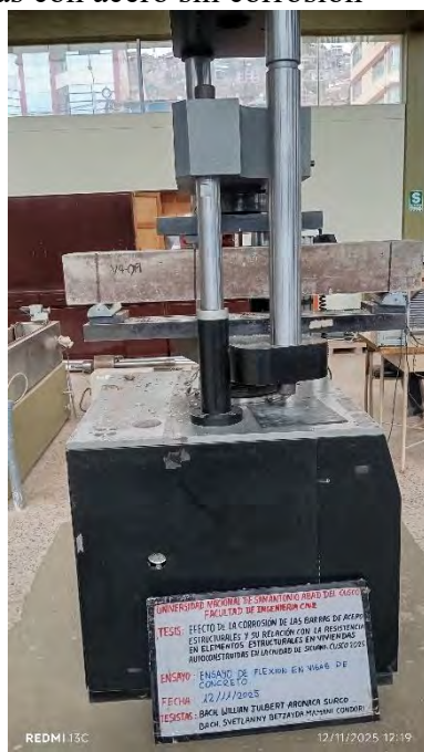
Fotografía 43. Ensayo de flexión en vigas con acero corroído máximo
