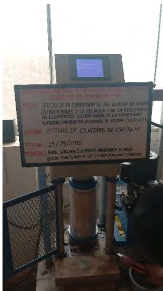
Fotografía 21. Rotura de la tercera briqueta para diseño de mezclas
