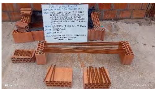
Fotografía 39. Corrosión del acero, día 35
