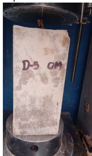
Fotografía 54. Efecto del ensayo de adherencia para D3-OM
