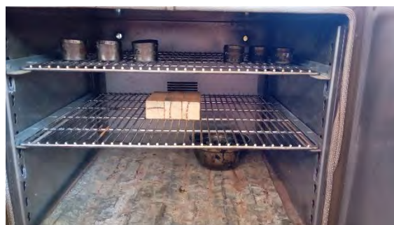
Fotografía 14. Secado de los agregados en el horno
