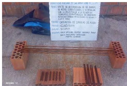
Fotografía 40. Corrosión del acero, día 42
