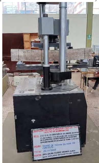
Fotografía 42. Ensayo de flexión para vigas con acero con corrosión promedio
