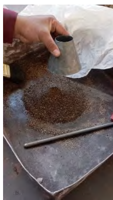
Fotografía 13. Ensayo de absorción, agregado fino
