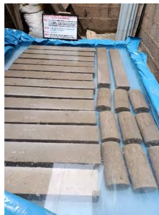
Fotografía 30. Curado de vigas y briquetas
