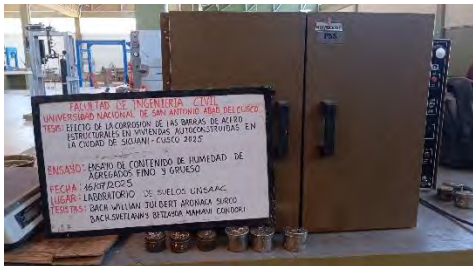
Fotografía 9. Ensayos de contenido de humedad de agregados
