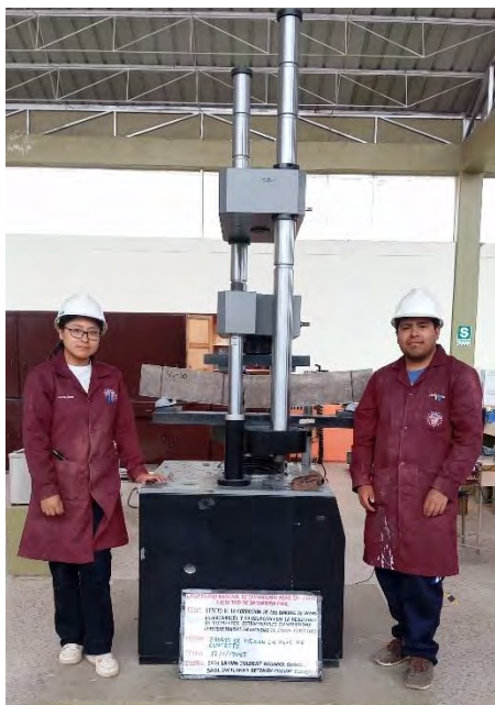
Fotografía 41. Ensayo de flexión para vigas con acero sin corrosión
