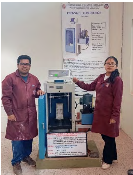
Fotografía 45. Ensayo de adherencia en dados de concreto con acero embebido
