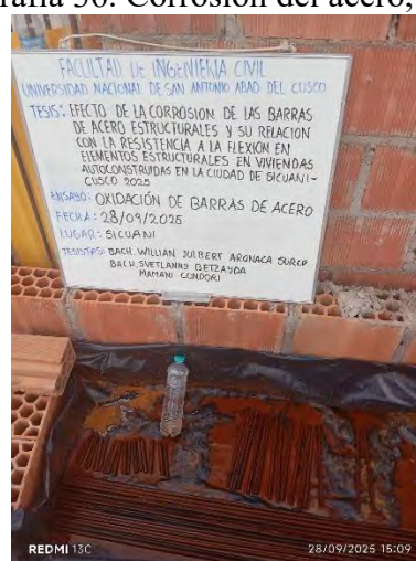
Fotografía 38. Corrosión del acero, día 28
