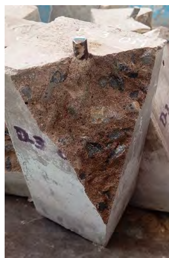
Fotografía 54. Efecto del ensayo de adherencia para D3-OM
