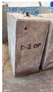
Fotografía 51. Efecto del ensayo de adherencia para D2-OP
