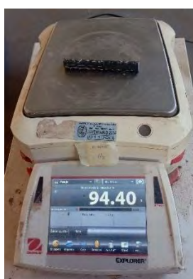
Fotografía 31. Peso de muestras de acero corroídas
