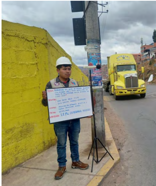
Figura 202 Medición de ruido en PC-20
