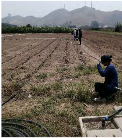
Fotografía N° 10. Prueba de Coeficiente de uniformidad en emisores de riego en parcela de investigación
