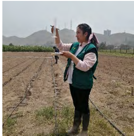
Fotografía N° 10. Prueba de Coeficiente de uniformidad en emisores de riego en parcela de investigación
