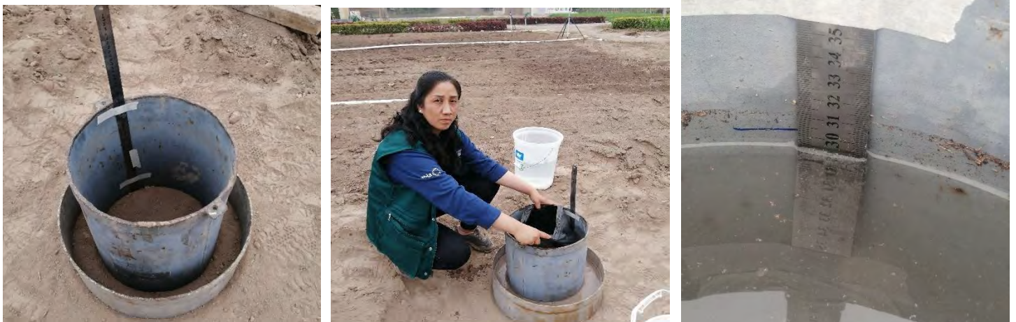
Fotografía N° 5: Prueba de infiltración básica en la parcela de investigación
