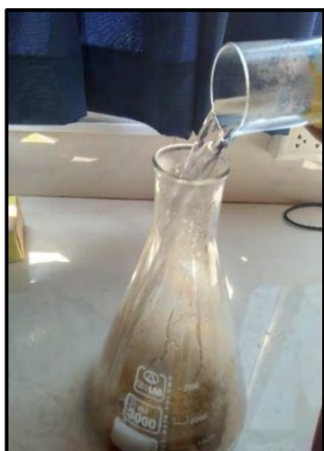
Figura 11. Adición gradual del agua destilada caliente
