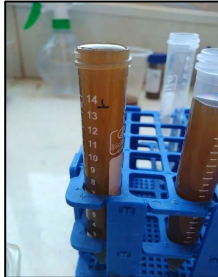
Figura 18. Llenado del tubo de ensayo hasta la formación de un menisco convexo.
