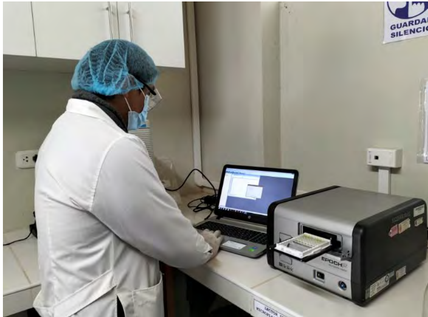
Fotografía 08. Lectura de las absorbancias en el espectrofotómetro.
