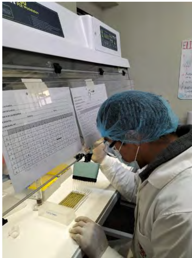
Fotografía 05. Adición de conjugado a los pocillos de la placa ELISA.
