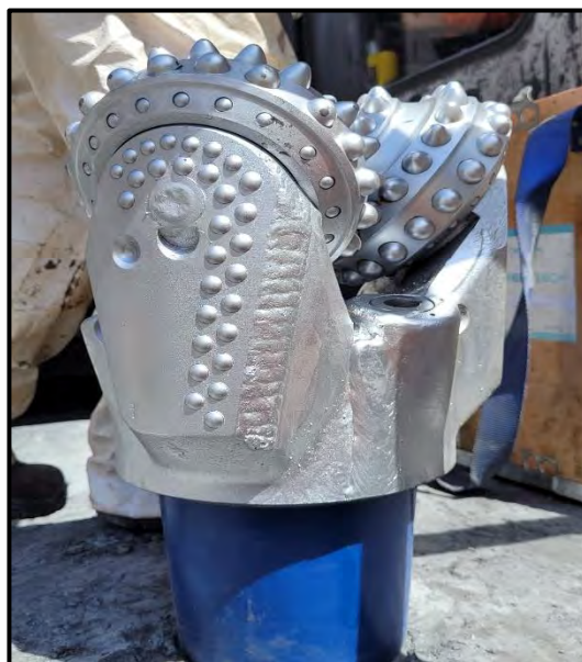
Figura 4. Broca CoreTech de 11" de diámetro
