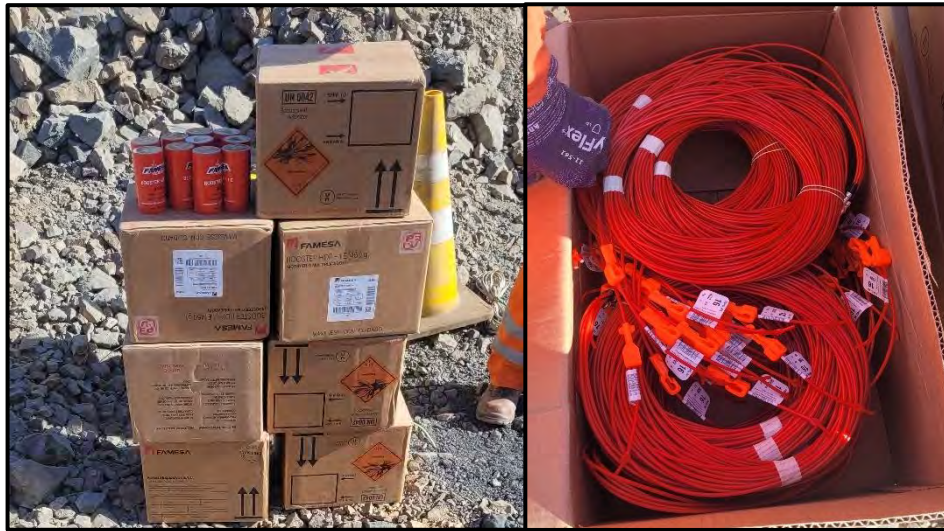
Figura 24. Booster y Fanel debidamente ordenada
