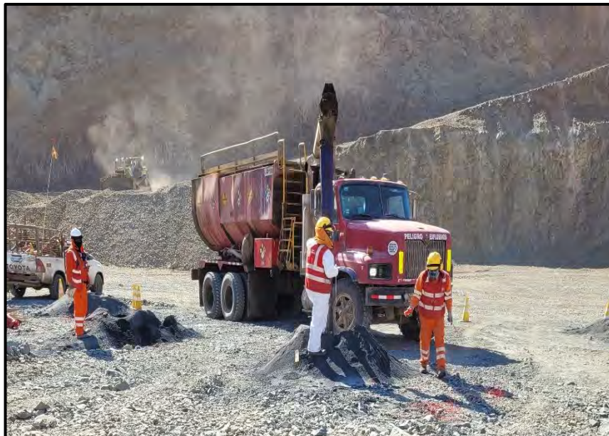
Figura 28. Trabajador Wincheando La Carga Explosiva
