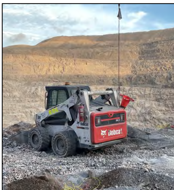
Figura 30. Tapado de taladros con minicargador, Material Stemming
