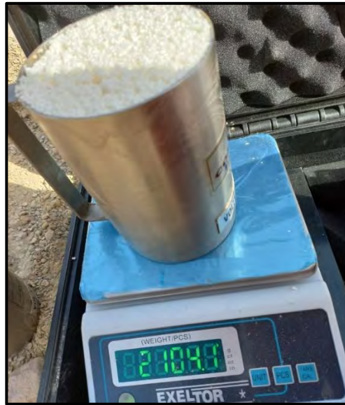
Figura 8. Heavy ANFO 45/55 con Densidad 1.27gr/cc que representa 2104.1gr
