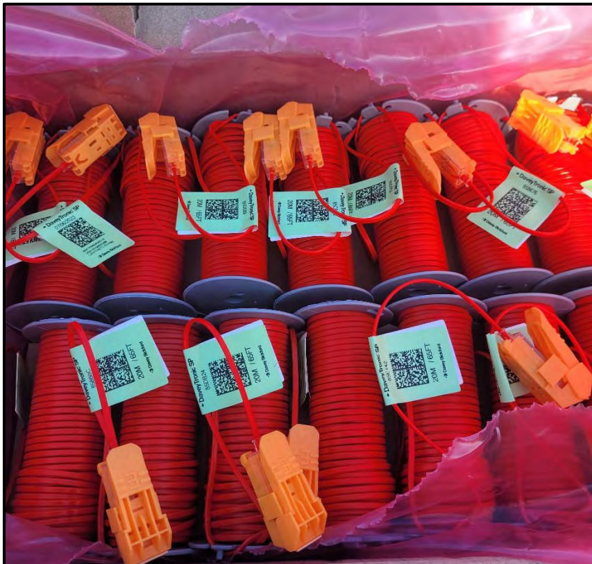
Figura 25. Detonador Electronico Daveytronic
