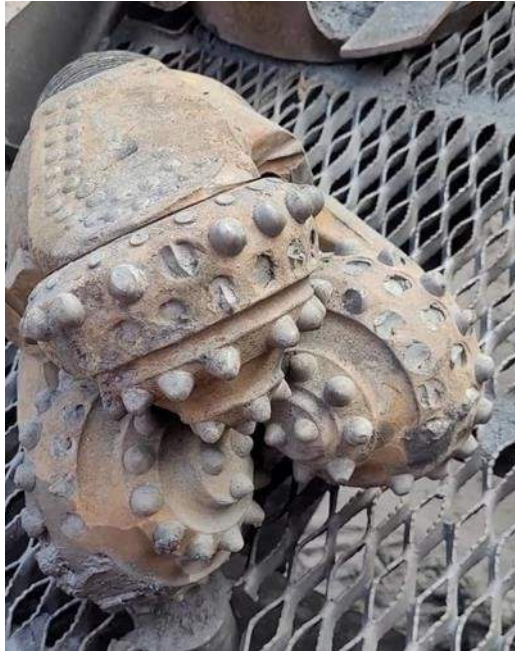
Figura 18: Broca desgastada insertos periféricos
