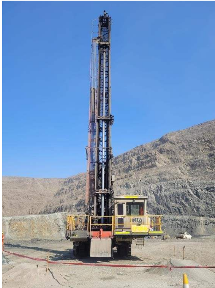
Figura 1: Perforadora DR412i, diámetro de 11", taladros de producción.
