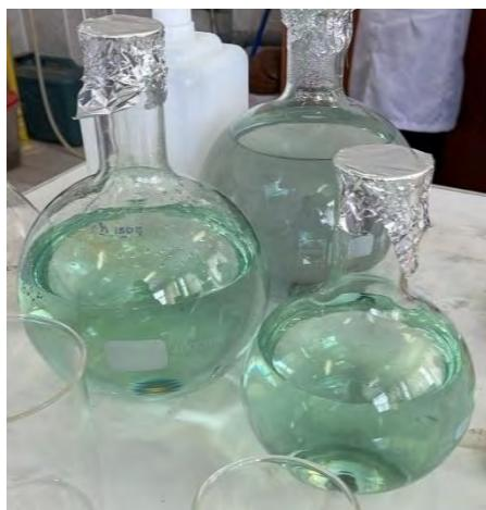
La solución contaminada fue dividida en alícuotas para la corrección del pH. La Figura 25 muestra el ajuste del pH, el cual se realizó mediante la adición de soluciones de NaOH con el objetivo de alcanzar valores de pH 3, 4 y 5. En dichos intervalos, predominan distintas especies de cromo, tal como se muestra en la Figura 1.
