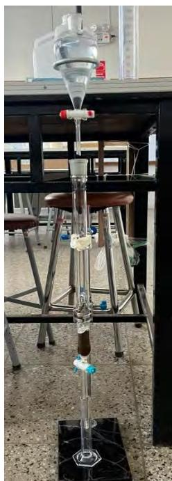
El agua residual se alimentó a la columna por gravedad con un flujo constante de 5.37 mL/min, regulado mediante una válvula de control. Durante el ensayo, el agua residual atravesó el lecho de bioadsorbente y el efluente fue recolectado en frascos ámbar a intervalos de tiempo previamente establecidos. La Tabla 5 muestra los tiempos de muestreo del agua tratada.
