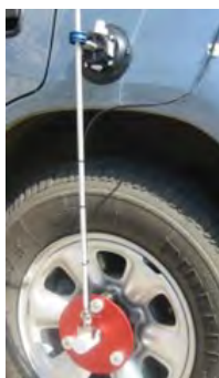
FIGURA N° 5.5: Instalación del DMI en la rueda trasera
